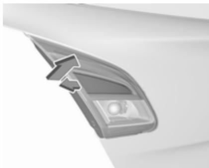
2. Трохи витягніть блок ліхтарів назовні, а потім вийміть його з дверей багажного відділення.
