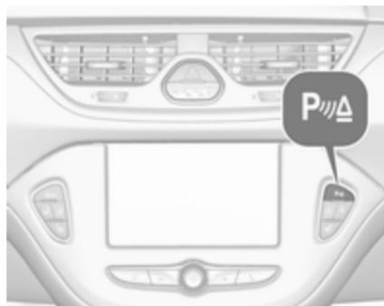
Система автоматично вимикається після вимкнення задньої передачі.
