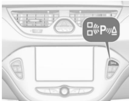
Під час пошуку місця для паркування система приводиться в робочий стан натисненням та утримуванням  $\diamond P\Delta$ .
