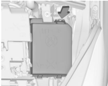
Блок запобіжників знаходиться ліворуч, скраю відділення для двигуна.
