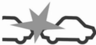
Якщо до можливого зіткнення з автомобілем попереду лишається зовсім мало часу, і зіткнення неминуче, у центрі інформації для водія з'являється спливаючий попереджувальний символ, а на лобове скло в полі зору водія проєциється червона блимаюча світлодіодна стрічка.
