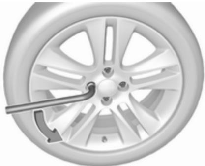
2. Установіть ключ і переконайтесь, що його надійно розташовано. На півоберта відкрутіть кожну гайку. Колеса можуть бути захищені за допомогою стопорних колісних болтів. Щоб ослабити ці спеціальні болти, спершу приєднайте перехідник для колісних болтів до головки болта, а потім встановіть на нього балонний ключ. Адаптер знаходитьться в бардачку.
