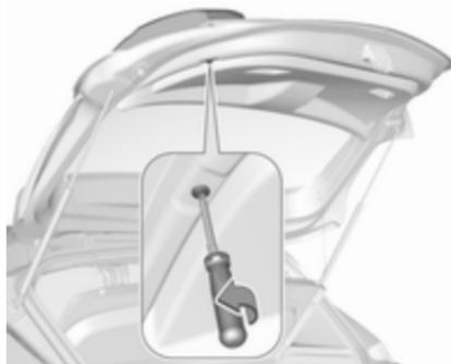
1. Викрутіть гвинт з дверей багажного відділення.
