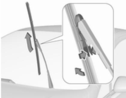
Установіть важіль склоочисника у підняте положення. Натисніть на фіксатори з обох боків, нахиліть щітку склоочисника під кутом 90° до важеля склоочисника і зніміть її, піднімаючи вгору.
