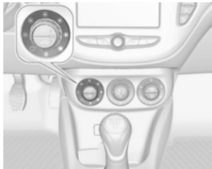
Повертайте лівий обертальний регулятор, щоб зменшити чи збільшити швидкість вентилятора. Швидкість вентилятора позначається на інформаційному дисплей.
