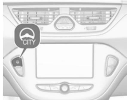
Натисніть під час роботи двигуна. Ця система діє, починаючи зі стану зупинки до швидкості 35 км/год, а також під час руху заднім ходом. Після перевищення цієї швидкості система переходить у звичайний режим. Коли міський режим увімкнений, він автоматично починає діяти при швидкості нижче 35 км/год.
