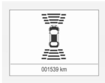
Відстань до перешкод позаду автомобіля та попереду його позначається зміною ліній відстані в центрі інформації для водія
