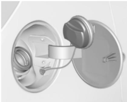
Кришка горловини паливного баку може бути зафікована в скобі на горловині паливного баку.
