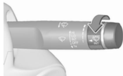
Поверніть колесо регулятора, щоб відрегулювати чутливість:
