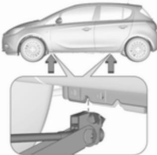
3. Переконайтесь, що домкрат стойть правильно по відношенню до отвору для домкрата автомобіля. У модифікаціях з панелями дверних порогів або модернізованими панелями дверних порогів не можна використовувати домкрат. Це може спричинити пошкодження автомобіля.
