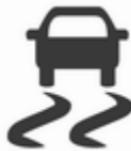
Система ESC готова до роботи після кожного запуску двигуна, щойно контрольний індикатор
