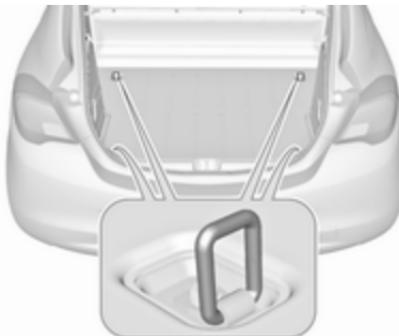
Вантажі можна закріплювати за допомогою чотирьох кріпильних кілець у багажному відділенні
