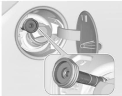
**Адаптер ACME:** Закрутіть гайку заправної насадки на адаптер. Натисніть на фіксувальний важіль на насадці вниз.
