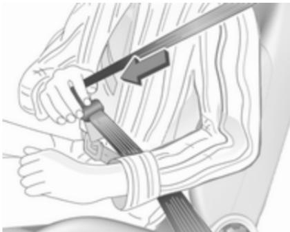
Витягніть пасок із переднатягувача, протягніть його через тіло та вставте язичок защіпки в пряжку. Регулярно
