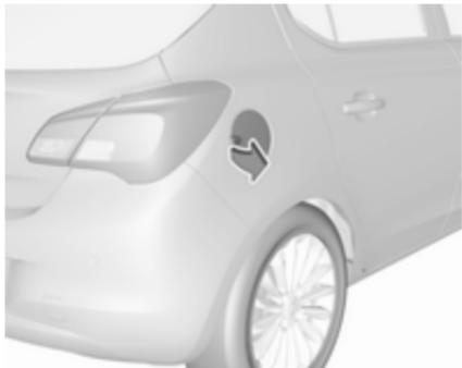
Кришку горловини паливного баку можна відчинити лише, якщо автомобіль розблоковано. Натиснувши кришку горловини паливного баку, зніміть її. Щоб відкрити горловину, повільно відкрутіть кришку проти годинникової стрілки.
