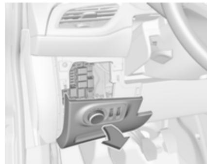
Блок запобіжників розміщується за вимикачем освітлення на панелі приладів. Потягніть за рукоятку і опустіть вимикач світла.
