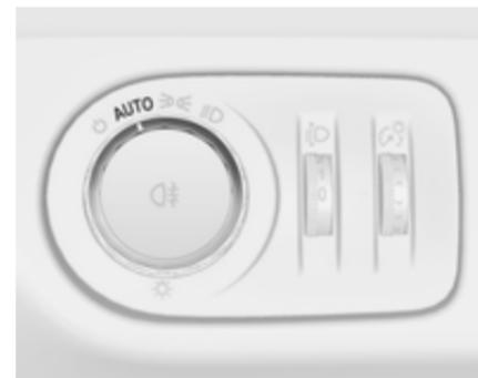
Коли функцію автоматичного керування освітленням увімкнено і двигун працює, система автоматично перемікається з ліхтарів денного освітлення на фари й навпаки залежно від умов освітлення та даних, які надходять із системи датчиків дощу.
