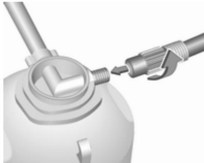
2. Відчепіть повітряний шланг від кронштейна та прикрутіть його на з'єднання пляшки з ущільнювачем.
