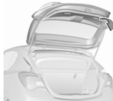
Користуйтесь внутрішньою ручкою. Не натискайте на сенсорний вимикач, зачиняючи двері багажного відділення, оскільки внаслідок цього вони знову відчиняться.
