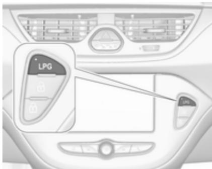
Щоб перемкнутися з бензину на скраплений газ і навпаки, натискайте **LPG**. Індикатор у кнопці показує поточний режим роботи.
