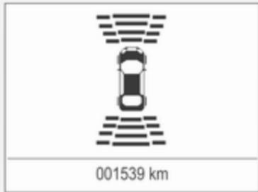
Вказування відстані може перериватися повідомленнями системи автомобіля звищим пріоритетом. Після закривання повідомлення відстань відобразиться знову.
