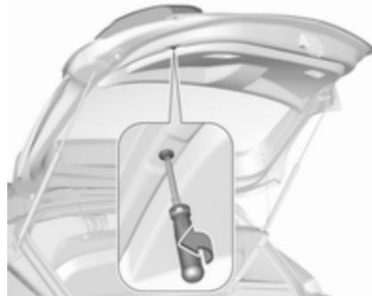
1. Викрутіть гвинт з дверей багажного відділення.
