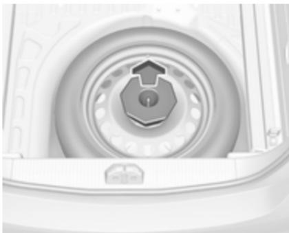
Зніміть прокладку над запасним колесом, підніміть колесо, установіть його у вертикальне положення, а потім вийміть, тримаючи колесо за верхню частину.
