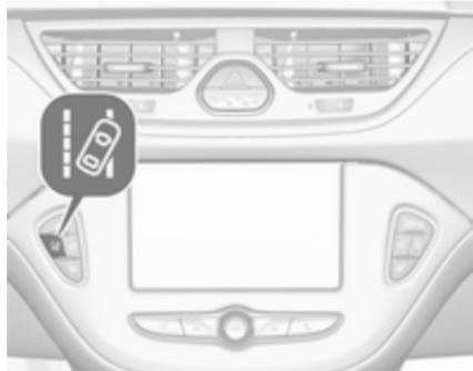
Система попередження про виїзд за межі смуги активується кнопкою . На активований стан системи вказує ввімкнений індикатор у кнопці. Якщо контрольний індикатор на панелі приладів світиться зеленим світлом, це означає, що система готова до роботи.
