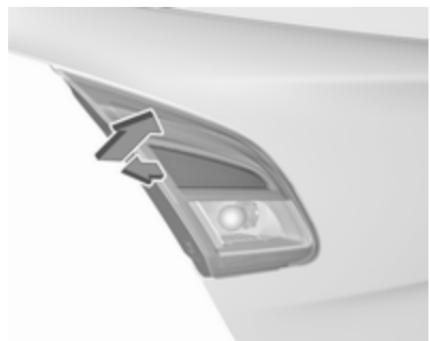
2. Трохи витягніть блок ліхтарів назовні, а потім вийміть його з дверей багажного відділення.
