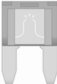
Залежно від типу запобіжника, запобіжник, що перегорів, можна розпізнати за розплавленим дротом. Не замінюйте запобіжник, доки не буде усунута причина несправності.
