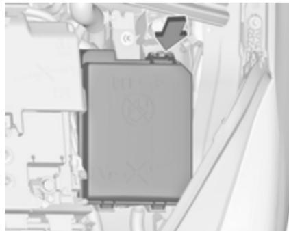
Блок запобіжників знаходитьться ліворуч, скраю відділення для двигуна.
