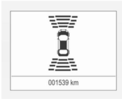
Відстань до перешкод позаду автомобіля та попереду нього позначається зміною ліній відстані в центрі інформації для водія ▷ 105.
