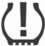
Розпізнавання стану тиску в шинах позначається контрольним індикатором  $(\text{!}) \Phi 103$ .
