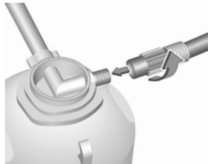
2. Відчепіть повітряний шланг від кронштейна та прикрутіть його на з'єднання пляшки з ущільнювачем.
