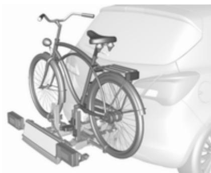
Задня система кріплення багажу (система Flex-Fix) дозволяє закріплювати велосипеди на витяжному тримачі, об'єднаному з підлогою автомобіля. Перевезення інших речей заборонено.
