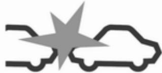
Якщо до можливого зіткнення з автомобілем попереду лишається зовсім мало часу, і зіткнення неминуче, у центрі інформації для водія з'являється спливаючий попереджувальний символ, а на лобове скло в полі зору водія проєціюється червона блимаюча світлодіодна стрічка.
