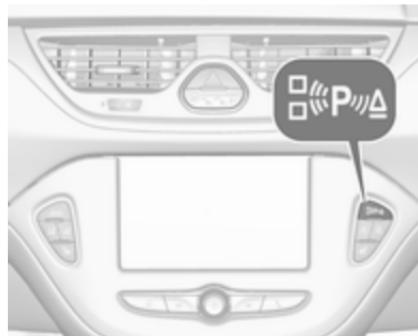
Під час пошуку місця для паркування система приводиться в робочий стан натисненням та утримуванням
