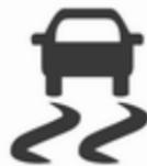
Система ESC готова до роботи після кожного запуску двигуна, щойно контрольний індикатор
