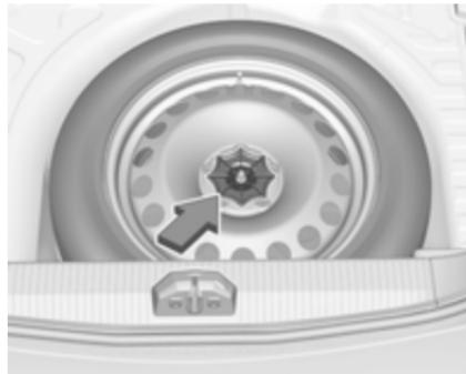
Запасне колесо розташоване в багажному відділенні під кришкою підлоги. Воно закріплюється крильчатою гайкою.
