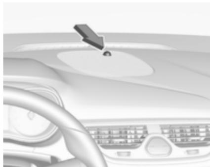
Індикатор стану вмонтовано в датчик на верхній частині панелі приладів.
