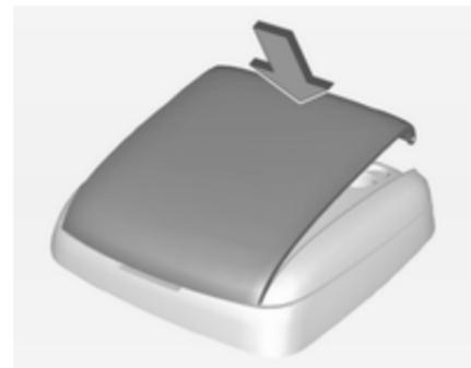
2. Закріпіть кришку на базовій станції.
