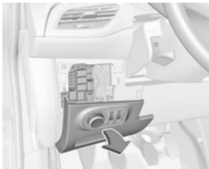
Блок запобіжників розміщується за вимикачем освітлення на панелі приладів. Потягніть за рукоятку і опустіть вимикач світла.
