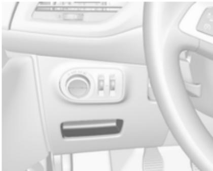
Відділення для зберігання знаходяться під вимикачем світла на центральній консолі та на дверцях.
