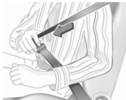
Витягніть пасок із переднатягувача, протягніть його через тіло та вставте язичок защіпки в пряжку. Регулярно
