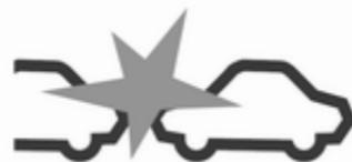
Якщо до можливого зіткнення з автомобілем попереду лишилося зовсім мало часу і зіткнення є неминучим, в інформаційному центрі водія з'явиться спливний попереджувальний значок, а також пролунає попереджувальний сигнал.
