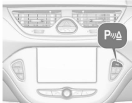
Система автоматично вимикається після вимкнення задньої передачі.
