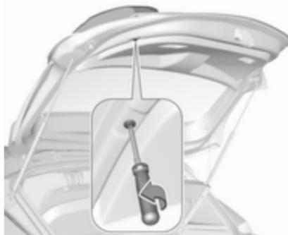
1. Викрутіть гвинт з дверей багажного відділення.
