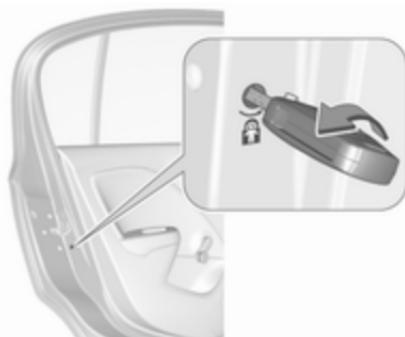
За допомогою ключа чи відповідної викрутки поверніть вимикач на замку задніх дверцят у горизонтальне положення.
