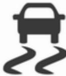
Система ТС готова до роботи після кожного запуску двигуна, щойно контрольний індикатор згасне.
