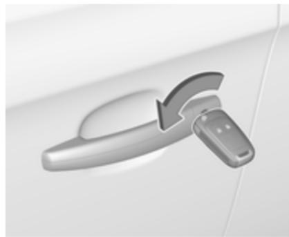
Щоб відімкнути дверцята водія вручну, вставте ключ у замок і поверніть його. Щоб відімкнути решту дверцят, багажне відділення та кришку горловини паливного бака, увімкніть запалювання й натисніть кнопку центрального замка .
