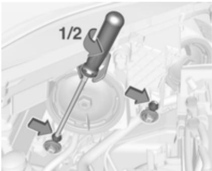
На корпусі кожної фари є два елементи регулювання. Поверніть обидва елементи регулювання на корпусі кожної фари на  $\frac{1}{2}$  оберту торцевим шестигранним ключем розміром шість проти годинникової стрілки, щоб налаштовувати режим освітлення для правостороннього руху. Вставте ключ у напрямну, як показано на рисунку. Замість цього для регулювання можна використати хрестову викрутку на три.
