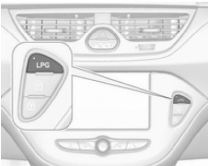
Після натиснення кнопки **LPG** автомобіль перемкнеться з бензину на скраплений газ одразу ж після досягнення необхідних параметрів (температура охолоджувальної рідини, температура газу та мінімальна частота обертів двигуна). Ці параметри зазвичай досягаються приблизно через 60 с після першого активного натискання на педаль акселератора (залежно від температури повітря). Світлодіодний індикатор позначає поточний режим роботи.
