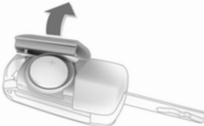
Розкладіть ключ і відкрийте блок убік. Замініть батарею (тип батареї CR 2032), беручи до уваги її положення під час установлення. Зачиніть блок і здійсніть синхронізацію.
