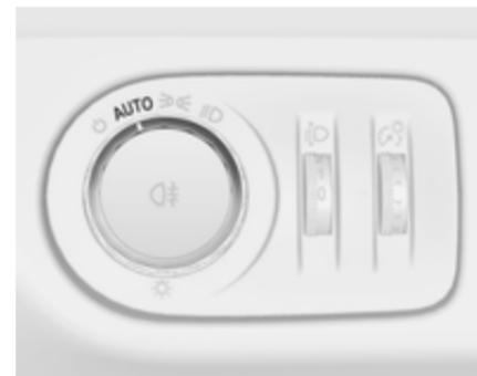
Коли функцію автоматичного керування освітленням увімкнено і двигун працює, система автоматично перемикається з ліхтарів денного освітлення на фари й навпаки залежно від умов освітлення та даних, які надходять із системи датчиків дощу.
