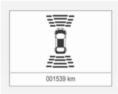
Вказування відстані може перериватися повідомленнями системи автомобіля звищим пріоритетом. Після закривання повідомлення відстань відобразиться знову.
