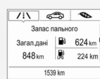
Відображення приблизного загального запасу пального в одиницях відстані (скраплений газ у балоні та бензин у паливному баку). Про низький рівень того чи
