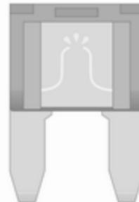
Залежно від типу запобіжника, запобіжник, що перегорів, можна розпізнати за розплавленим дротом. Не замінюйте запобіжник, доки не буде усунута причина несправності.
