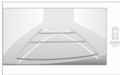
Вертикальними лініями позначається загальний напрямок руху автомобіля, відстань між цими лініями відповідає ширині вашого автомобіля без дзеркал. Першою горизонтальною лінією позначається відстань близько 30 см від краю заднього бампера автомобіля. Верхніми горизонтальними лініями позначаються відстані приблизно 1 і 2 метри від краю заднього бампера автомобіля. Криві, що перетинаються, окреслюють максимальний радіус розвороту.
