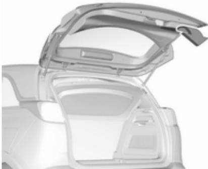
Користуйтесь внутрішньою ручкою. Не натискайте сенсорний вимикач, зачиняючи двері багажного відділення, оскільки внаслідок цього вони знову відчиняться. Центральний замок  $\diamond$  25.
