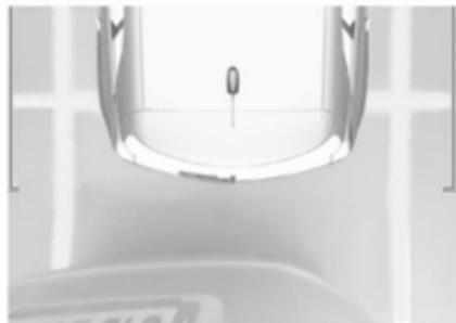
Камера записує оточення автомобіля під час маневру, щоб реконструювати вигляд ззаду
