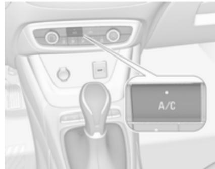
Натисніть **A/C**, щоб перемкнути на охолодження. Активація вказується індикатором у кнопці. Охолодження працює лише під час роботи двигуна та вентилятора системи клімат-контролю.
