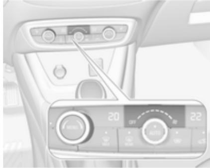
Потрібну швидкість потоку повітря вентилятора можна встановити поворотом регулятора .
