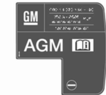
Акумулятор AGM можна розпізнати по ярлику на акумуляторі. Ми рекомендуємо використовувати фірмовий автомобільний акумулятор Opel.
