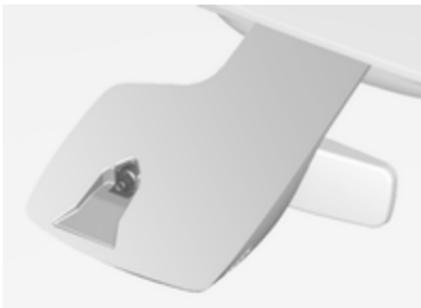
Підтримуйте чистоту датчика, запобігаючи потраплянню на нього пилу, бруду та льоду.
