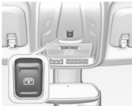
Плавно натисніть перемикач до першого фіксатора в задній частині: штора відкривається під час утримування перемикача.
