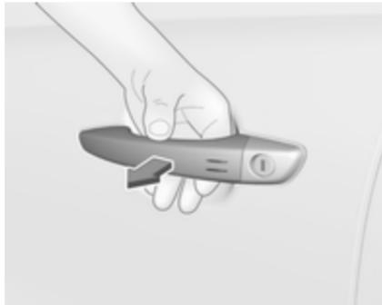
Щоб відімкнути автомобіль, просуньте руку за ручку на будь-яких дверцях або натисніть на сенсорну панель дверей багажного відділення.
