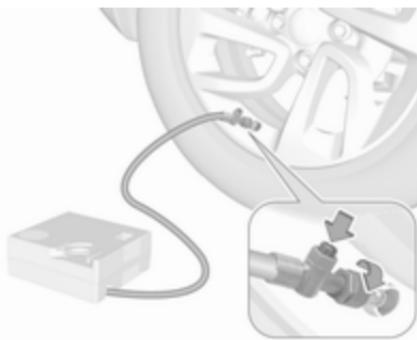
16. Відразу після цього продовжіть рух, щоб дозволити ущільнювачу рівномірно розподілитися в шині. Приблизно через 5 км (але не більше ніж через десять хвилин) зупиніться та перевірте тиск у шинах. При цьому прикрутіть повітропровід компресора безпосередньо до ніпеля шини. Заповніть шину герметиком так, як описано вище. Знизьте зайвий тиск у шинах, натиснувши кнопку на повітряному шлангу.
