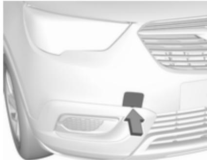
Вставте викрутку в отвір знизу на кришці. Обережно опускайте викрутку вниз, щоб зняти кришку. Буксирна провушинна зберігається разом з інструментами для автомобіля ⇨ 217.
