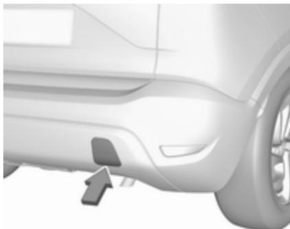
Вставте викрутку в отвір знизу на кришці. Обережно опускайте викрутку вниз, щоб зняти кришку. Буксирна провушина зберігається разом з інструментами для автомобіля ⇨ 217.
