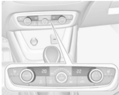
Установіть визначені рівні температури окремо для місць водія та пасажира на передньому сидінні за допомогою регуляторів ліворуч і праворуч. Регулятором з боку пасажира регулюється температура повітря у відповідній зоні. Регулятором з боку водія можна регулювати температуру з боку водія, а також температуру з обох боків, якщо ввімкнуто режим синхронізації **MONO** в меню
