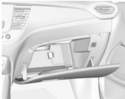
У деяких версіях бардачок вентилюється. Вентиляція та температура повітря залежать від налаштувань системи клімат-контролю. Повітропровід у бардачку можна закрити ⇨ 137.
