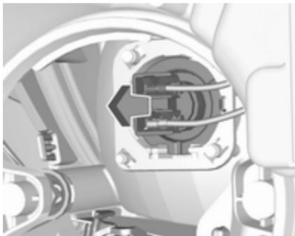
2. Вийміть верхній патрон лампи з корпусу рефлектора.
