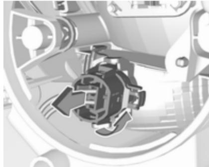
2. Повертайте нижній тримач лампи проти годинникової стрілки, щоб відкрутити його. Вийміть патрон лампи з корпусу рефлектора.
