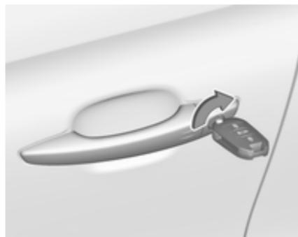
Щоб замкнути дверцята водія вручну, вставте ключ в отвір замка і поверніть його.
