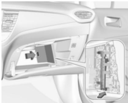
В автомобілях із лівостороннім керуванням блок запобіжників розміщений за кришкою в бардачку. Відчиніть бардачок і пересуньте кришку. Зніміть кронштейн.
