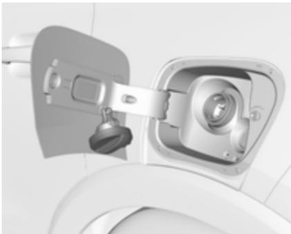
Кришку горловини паливного бака можна почепити на гачок на дверцях горловини паливного бака.
