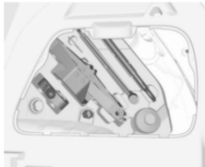
Домкрат, інструменти, пасок для закріплення пошкодженого колеса та буксирна серга зберігаються в ящику для інструментів, розміщенному на правій стінці багажного відділення. Запасне колесо  $\diamond 229$ .
