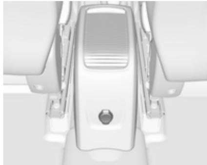
Ще одна розетка розміщена в консолі між передніми сидіннями. Забороняється перевищувати максимальне споживання енергії в 120 Вт. Коли система запалювання вимкнена, розетка відключається. Окрім того, розетка не діє за низького заряду автомобільного акумулятора.
