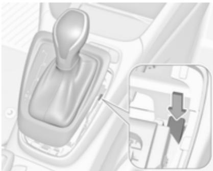
3. Натисніть кнопку і перемістіть важіль селектора з положення **P**. Для усунення переривання живлення зверніться на станцію технічного обслуговування.
