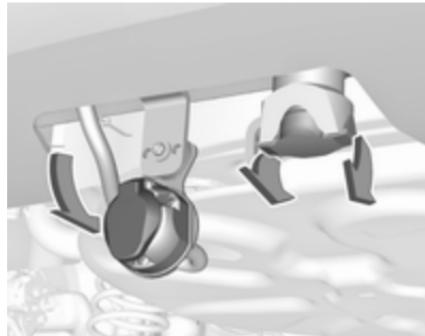
Опустіть з'єднувальну розетку. Вийміть ущільнювальну пробку з отвору для штанги та приберіть її.
