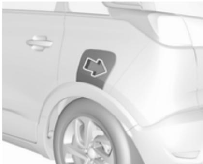
Кришку горловини паливного бака можна відчинити лише, якщо автомобіль розблоковано.
