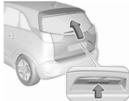
Після відімкнення натисніть на сенсорний вимикач над номерним знаком і відчиніть двері багажника.
