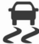
Електронна система курсової стійкості та протибуксувальна система переводяться в робочий стан після кожного запуску двигуна, як тільки згасне контрольний індикатор .
