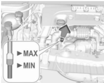
Залежно від варіанта двигуна використовуються різні щупи.
