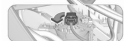
1. Поверніть патрон лампи проти годинникової стрілки та вийміть його з корпусу рефлектора.
