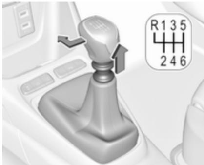
Щоб увімкнути задню передачу на 6-швидкісній трансмісії, натисніть педаль зчеплення, потягніть за кільце під важелем селектора, а потім перемістіть важіль вліво та вперед.
