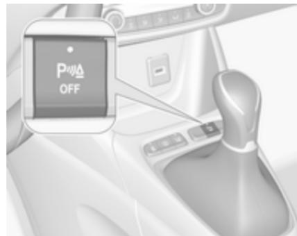
Система вимикається після вимкнення задньої передачі. Натисніть **P $\Delta$  OFF**, щоб вимкнути систему вручну. Коли система вимкнеться, засвітиться індикатор у кнопці.
