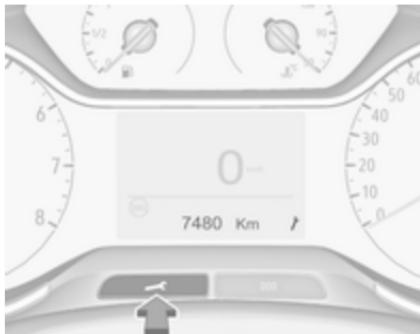
Після ввімкнення запалювання в інформаційному центрі водія протягом сіми секунд відображається тип обслуговування, яке потрібно виконати.
