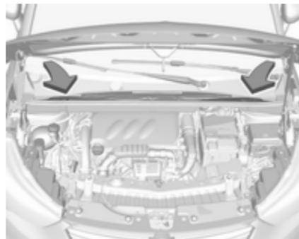
Щоб забезпечити вільний прохід повітряного потоку, повітrozабірник перед лобовим склом у моторному відділенні не повинен бути забруднений. Видаліть листя, бруд або сніг.
