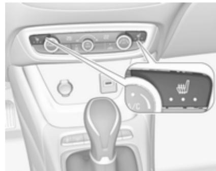
Відрегулюйте підігрів до потрібного значення, натиснувши кнопку для відповідного сидіння один або кілька разів. Контрольний індикатор на кнопці позначає вибраний параметр.
