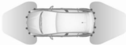
Розширенна допомога при паркуванні завжди поєднується із системою допомоги під час паркування переднім та заднім ходом.
