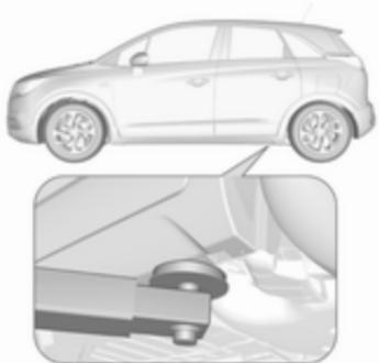
Положення заднього кронштейна на ліфтової платформи під днищем.
