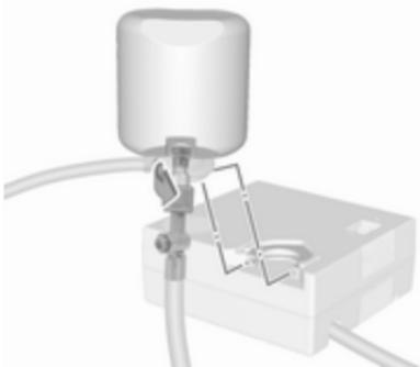
4. Прикрутіть повітропровід компресора до з'єднання на контейнері з ущільнювачем.
