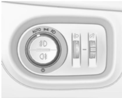
**AUTO** : система автоматичного регулювання освітлення автоматично перемікає освітлення при денному світлі на світло фар
