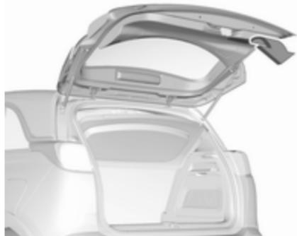
Користуйтесь внутрішньою ручкою. Не натискайте сенсорний вимикач, зачиняючи двері багажного відділення, оскільки внаслідок цього вони знову відчиняться. Центральний замок ⌂ 24.
