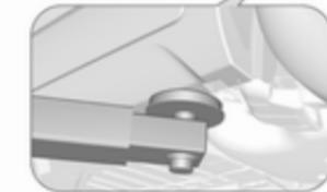
Розміщення заднього кронштейна підйомної платформи по центру під відповідною точкою встановлення домкрата.
