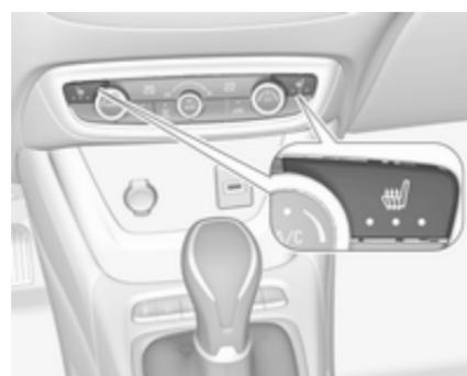
Відрегулюйте підігрів до потрібного значення, натиснувши кнопку для відповідного сидіння один або кілька разів. Контрольний індикатор на кнопкі позначає вибраний параметр.
