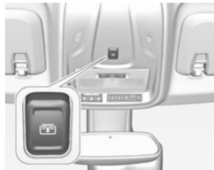
Плавно натисніть перемикач до першого фіксатора в задній частині: штора відкривається під час утримування перемикача.
