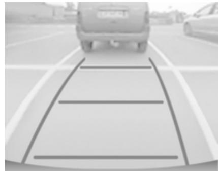
На екрані відображається область позаду автомобіля. Вертикальні лінії окреслюють ширину автомобіля з розкладеними дзеркалами. Напрямок ліній змінюється залежно від положення керма.
