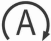
На стану режиму "Автостоп" указує контрольний індикатор .
