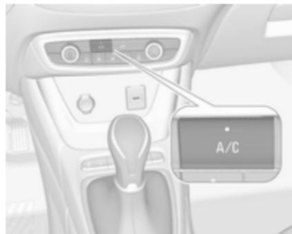
Натисніть A/C, щоб перемкнути на охолодження. Активація вказується індикатором у кнопці. Охолодження працює лише під час роботи двигуна та вентилятора системи клімат-контролю.
