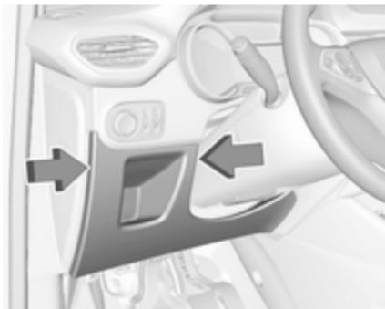
В автомобілях із лівостороннім керуванням коробка запобіжників знаходиться під кришкою панелі приладів. Від'єднайте бік кришки та зніміть її.
