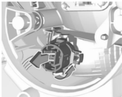
2. Повертайте нижній тримач лампи проти годинникової стрілки, щоб відкрутити його. Вийміть патрон лампи з корпусу рефлектора.
