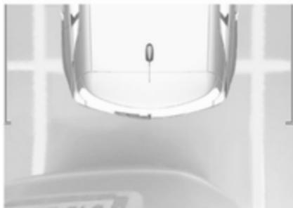
Камера записує оточення автомобіля під час маневру, щоб реконструювати вигляд ззаду автомобіля згори в його найближчому оточенні. Це дає змогу автомобілю легше оминати перешкоди навколо. Цей вид доступний в автоматичному режимі або у меню вибору видів.
