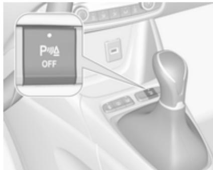
Система вимикається після вимкнення задньої передачі. Щоб вимкнути систему вручну, натисніть **PARK OFF**. Коли система вимкнеться, засвітиться індикатор у кнопці. Якщо систему вимкнено вручну, вона не ввімкнеться знову автоматично під час наступного ввімкнення запалювання.
