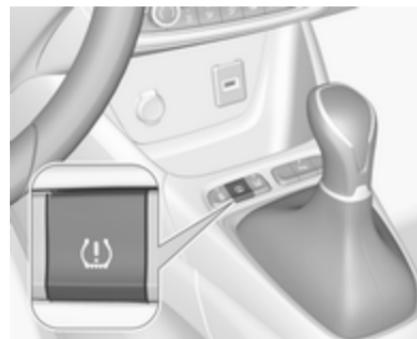
Після корекції тиску в шинах або заміни колеса потрібно виконати ініціалізацію системи, щоб визначити нові контрольні значення окружності кочення:
