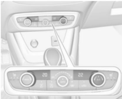
Натисніть **A/C**, щоб перемкнути на охолодження. Після ввімкнення індикатор у кнопці засвітиться. Охолодження працює лише під час роботи двигуна та вентилятора системи клімат-контролю.
