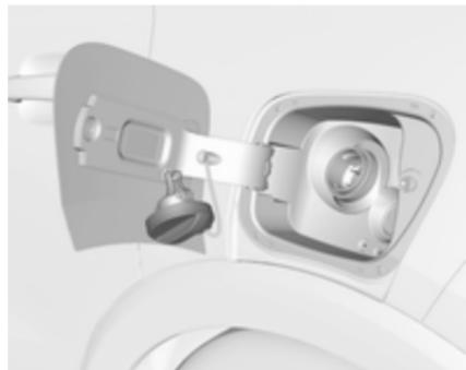
Кришку горловини паливного бака можна почепити на гачок на дверцях горловини паливного бака.
