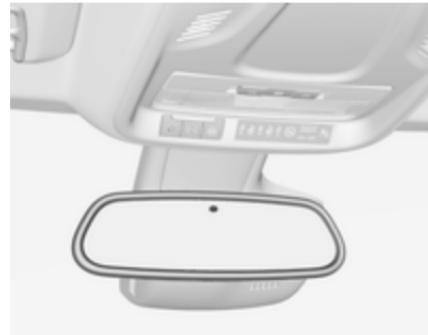
Під час руху у темний час доби дія сліпучого світла від автомобілів позаду автомобільно зменшується.
