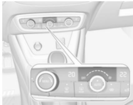
Потрібна швидкість потоку повітря вентилятора налаштовується повертанням ручки регулятора
