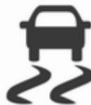
Системи ESC і TC готові до роботи після кожного запуску двигуна, як тільки згасне контрольний індикатор .
