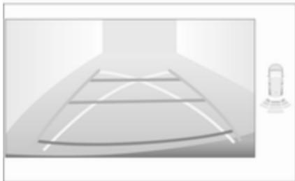
Вертикальними лініями позначається загальний напрямок руху автомобіля, відстань між цими лініями відповідає ширині вашого автомобіля без дзеркал. Першою горизонтальною лінією позначається відстань близько 30 см від краю заднього бампера автомобіля. Верхніми горизонтальними лініями позначаються відстані приблизно 1 і 2 м від краю заднього бампера автомобіля. Криві, що перетинаються, окреслюють максимальний радіус розвороту.
