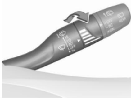
Важіль очисника в положенні **INT**. Поверніть колесо регулятора, щоб відрегулювати частоту омивання.
