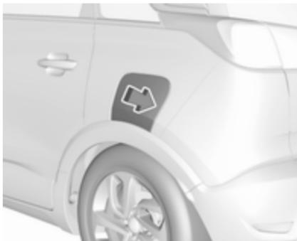
Кришку горловини паливного бака можна відчинити лише, якщо автомобіль розблоковано. Натиснувши кришку горловини паливного бака, зніміть її.
