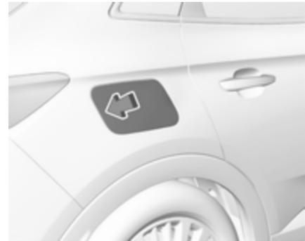
Кришку горловини паливного бака можна відчинити лише, якщо автомобіль розблоковано. Натиснувши кришку горловини паливного бака, зніміть її.
