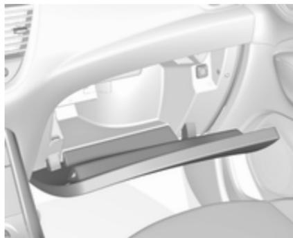
У деяких версіях бардачок вентилюється. Вентиляція та температура повітря залежать від налаштувань системи клімат-контролю. Вентиляційний отвір у бардачку можна закрити ⇨ 146.
