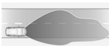
Активується автоматично на швидкості понад 115 км/год. Підсвічення адаптується до вищої швидкості під час руху по автомагістралях. За відсутності зустрічного транспорту збільшується видимість на смугі руху автомобіля. Діапазон видимості збільшується з 70 м до 140 м, завдяки чому віддалені об'єкти можуть розпізнаватися по всій ширині дороги.
