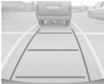
На екрані відображається область позаду автомобіля. Вертикальні лінії окреслюють ширину автомобіля з розкладеними дзеркалами. Напрямок ліній змінюється залежно від положення керма.
