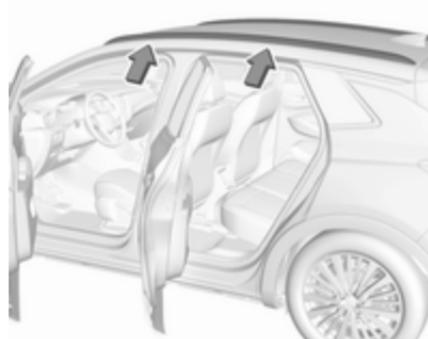
Багажник на даху кріпиться на поздовжніх дугах над точками кріплення, розміщеними на кожній дверній рамі кузова автомобіля.
