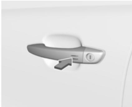
Система електронного ключа: Система сигналізації для запобігання викраденню автомобіля вимкнеться, якщо відімкнута автомобіль, натиснувши на позначки на зовнішній ручці передніх дверцят.
