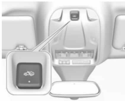
Вимикайте функцію моніторингу пасажирського відділення та нахилу автомобіля у випадках, коли в автомобілі залишаються тварини. Інакше гучні ультразвукові сигнали або рух тварини можуть спричинити спрацювання сигналізації. Вимикайте цю функцію також у випадках, коли автомобіль перебуває на поромі чи потязі.
