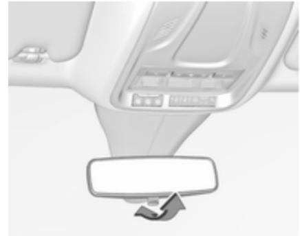
Щоб зменшити засліплювальну дію світла, поверніть важіль на зворотному боці корпусу дзеркала.
