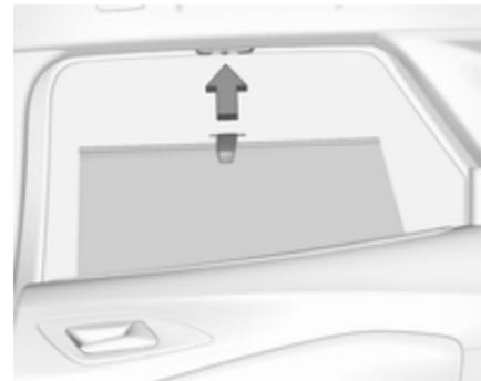
Щоб зменшити потрапляння сонячного світла на другий ряд сидінь, потягніть штору догори за допомогою ручки та зафіксуйте її у верхній частині дверної рами.
