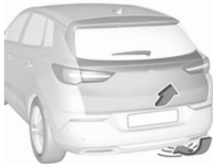
Щоб відчинити чи зачинити двері багажного відділення, підсуньте ногу під задній бампер у місці розташування номерного знака (як показано на рисунку), а потім відсуньте її. Ключ має знаходитися на відстані не більше 1 м. Не слід тримати ногу під бампером надто довго або рухати нею надто повільно. Електронний ключ має бути зовні автомобіля з відповідної сторони на відстані приблизно 1 м від дверей багажного відділення.
