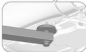
Розміщення заднього кронштейна підйомної платформи по центру під відповідною точкою встановлення домкрата.
