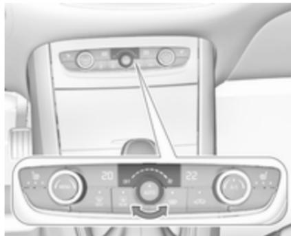
Потрібну швидкість потоку повітря вентилятора можна встановити поворотом обертового кільця. Для зменшення поверніть його проти годинникової стрілки, а для збільшення - за годинниковою стрілкою. Крім того, швидкість вентилятора можна змінити у меню параметрів клімат-контролю. Щоб перейти до цього меню, натисніть **MENU**.
