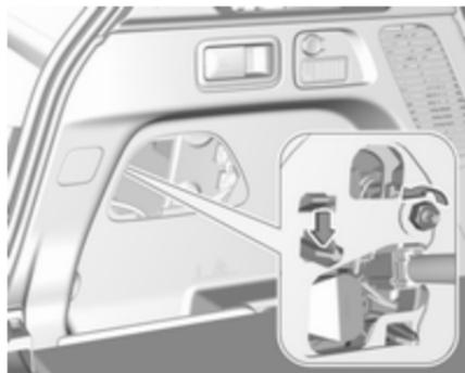
2. Ослабте гайку кріплення ліхтаря торцевим або накладним ключем.
