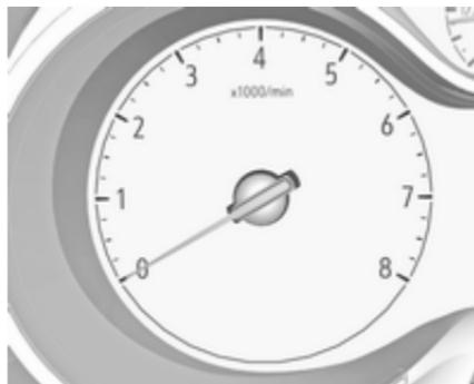
Показує швидкість роботи двигуна. Вибирайте оптимальні оберти двигуна для кожної передачі.
