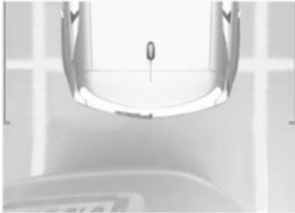
Камера записує оточення автомобіля під час маневру, щоб створити вид позаду або попереду автомобіля згори в його найближчому оточенні. Це дає змогу автомобілю легше оминати перешкоди навколо нього. Цей вид доступний в автоматичному режимі або у меню вибору видів.
