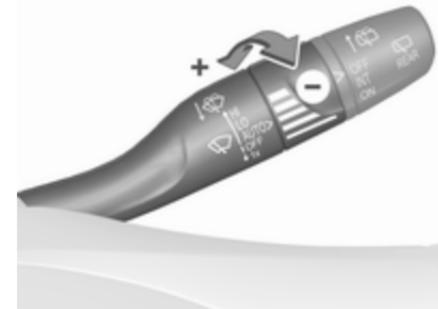
Поверніть колесо регулятора, щоб відрегулювати чутливість.
