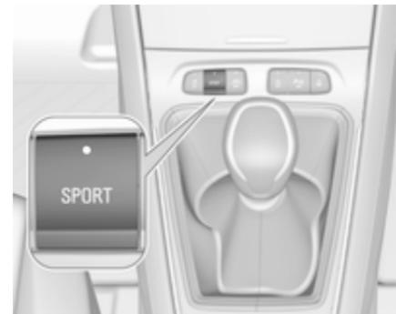
У спортивному режимі деякі параметри систем автомобіля налаштовуються для більш спортивного стилю водіння.
