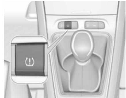
Після корекції тиску в шинах або заміни колеса потрібно виконати ініціалізацію системи, щоб визначити нові контрольні значення окружності кочення:
