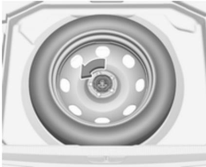
Запасне колесо розташоване в багажному відділенні під покриттям полиця.
