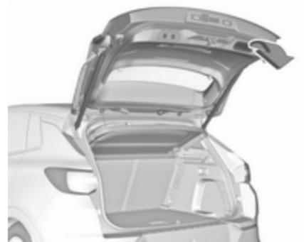
Користуйтеся внутрішньою ручкою. Не натискайте сенсорний вимикач, зачиняючи двері багажного відділення, оскільки внаслідок цього вони знову відчиняться. Центральний замок
