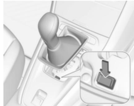
3. Натисніть кнопку і перемістіть важіль селектора з положення **P**. Для усунення переривання живлення зверніться на станцію технічного обслуговування.
