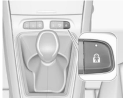
Дистанційно керована система для запобігання відкриванню задніх дверцят за допомогою внутрішніх дверних ручки і використання задніх вікон з електропідйомниками.
