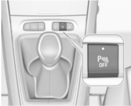
Система вмикається після вимкнення задньої передачі. Щоб вимкнути систему вручну, натисніть **P OFF**. Коли система вимкнеться, засвітиться індикатор у кнопці. Якщо систему вимкнено вручну, вона не ввімкнеться знову автоматично під час наступного ввімкнення запалювання.
