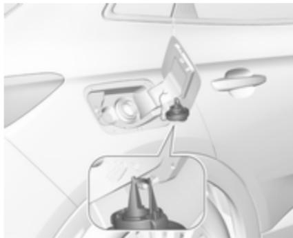
Кришку горловини паливного бака можна почепити на гачок на дверцятках горловини паливного бака.
