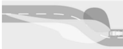
Для поліпшення освітлення під час поворотів вмикаються додаткові світлодіоди відповідно до кута повороту та швидкості автомобіля. Ця функція вмикається на швидкості від 40 км/год до 70 км/год.
