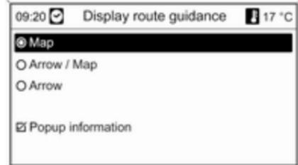
Використовуючи параметр **Popup information** (**Інформація у спливному вікні**), вказівки навігаційної системи під час супроводження маршруту відображатимуться у вигляді спливних вікон в інших робочих режимах (наприклад, у режимі радіо). Вказівки зникають через деякий час або після натискання кнопки **BACK**.
