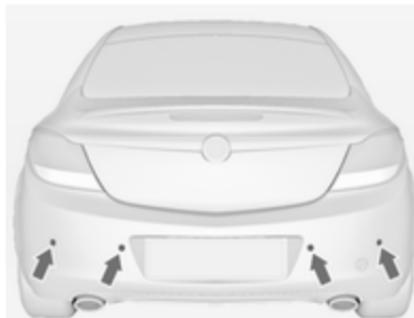
Система допомоги під час паркування полегшує процес паркування, вимірюючи відстань між автомобілем і перешкодами та відтворюючи звуковий сигнал. Проте за виконувані маневри під час паркування відповідає лише водій.
