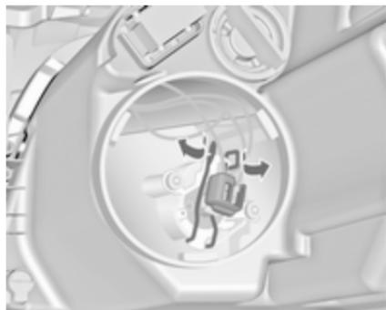
3. Зніміть пружинний зажим із фіксатора натисканням вперед, а потім поверніть його донизу.
