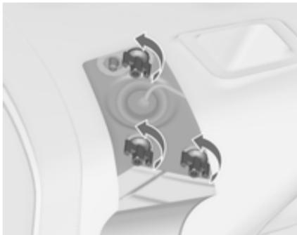
2. Відкрутіть три пластикових гайки рукою.
