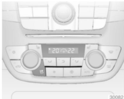
Відрегулюйте вентиляцію до потрібного параметра, натиснувши кнопку для сидіння водія один або кілька разів із ввімкненою системою запалення.
