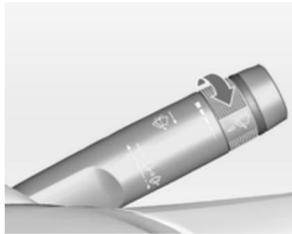
Поверніть колесо регулятора, щоб відрегулювати чутливість:
