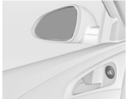
Виберіть потрібне зовнішнє дзеркало, повернувши регулятор ліворуч (L) або праворуч (R). Потім поверніть регулятор, щоб відрегулювати дзеркало.
