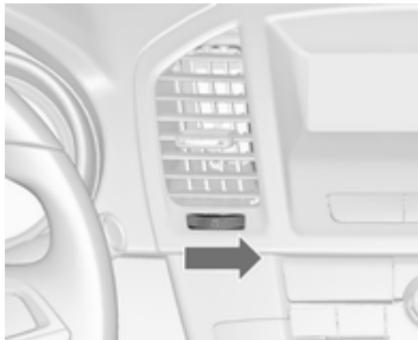
Щоб відчинити повітропровід, поверніть колесо регулятора в положення I. Відрегулюйте потік повітря, що надходить через повітропровід, повернувши колесо регулятора у потрібне положення.
