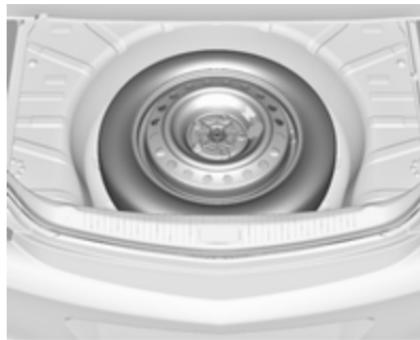
Запасне колесо розташоване в багажному відділенні під покриттям полика. Воно закріплюється крильчаткою гайкою.
