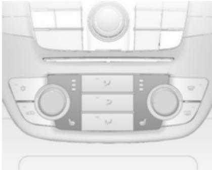
Відрегулюйте підігрів до потрібного параметра натисканням кнопки для відповідного сидіння один або кілька разів, коли ввімкнено систему запалення. Вибраний параметр можна перевірити на кнопці або дисплеї, на якому відображається відповідний контрольний індикатор.
