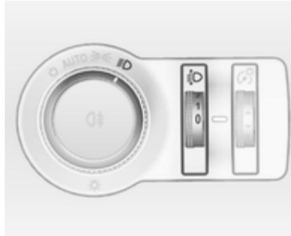
Щоб налаштувати діапазон освітлення фарами відповідно до навантаження автомобіля і запобіти засліпленню, виконайте такі дії: поверніть колесо регулятора в потрібне положення.
