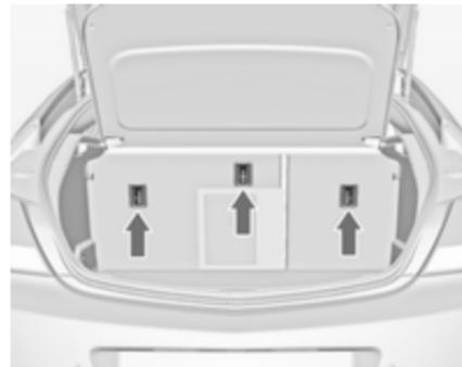
Окрім встановлення системи Isofix закріпіть ремінець Top-tether в отворах для кріплення Top-tether. Пасок повинен проходити між двома направляючими валиками підголівника.
