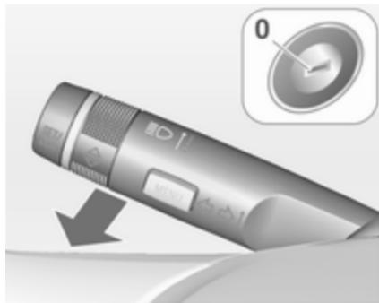
Фари, задні ліхтарі, ліхтарі заднього ходу та ліхтарі освітлення номерних знаків протягом регульованого періоду часу освітлюють область навколо автомобіля після виходу з нього.
