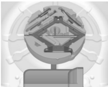
Домкрат та інструменти знаходяться під підлогою багажного відділення, під запасним колесом. Запасне колесо Ø 215.
