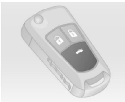
При вимкненій системі запалення натисніть і утримуйте кнопку , доки багажник не відкриється автоматично. Усі дверцята залишаються заблокованими. Багажник із приводом 26.
