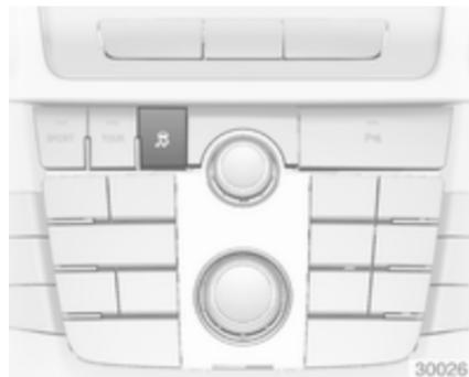
Для максимально розкутого водіння систему ESC можна дезактивувати: утримуйте кнопку
