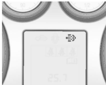
За певних умов водіння, наприклад, під час долання коротких відстаней, система не може виконати очищення автомобільно.
