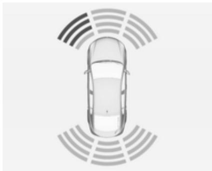
Відстань до перешкод попереду й позаду позначається зміною ліній відстані навколо автомобіля.
