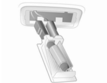
2. Легко натисніть лампу до пружинного зажиму та вийміть її.
