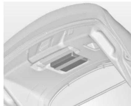
Зберігайте аптечку за паском на внутрішній частині багажника.
