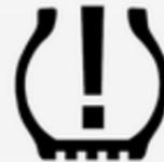
Розпізнавання стану тиску в шинах позначається контрольним індикатором (⚠) ⇨ 117.
