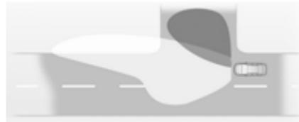
На поворотах з обмеженою видимістю або під час виконання повороту, залежно від кута чи ввімкненого сигналу повороту, ліворуч або праворуч вмикається додатковий рефлектор, який освітлює дорогу в напрямку руху під відповідним кутом. Активується на швидкості 40 км/год.
