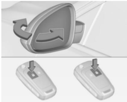
Щоб скласти дзеркала, після замикання автомобіля знову натискайте кнопку
