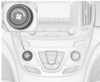
Встановіть потрібну швидкість потоку повітря за допомогою регулятора ⚙️. У положенні 0 вентилятор вимкнута.
