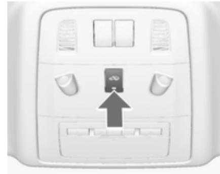
Вимикайте функцію моніторингу пасажирського відділення та нахилу автомобіля у випадках, коли в автомобілі залишаються тварини. Інакше високооб'ємні ультразвукові сигнали або рух тварини можуть спричинити спрацювання сигналізації. Вимикайте цю функцію також у випадках, коли автомобіль перебуває на поромі чи потязі.
