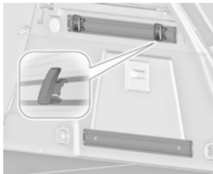
Спочатку вставте гачок у потрібному положенні у верхній паз рейки, а потім втисніть його в нижній паз. Щоб зняти гачок, спочатку витягніть його з верхнього паза.
