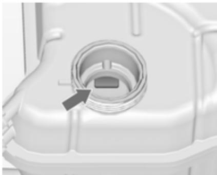
На іншій версії позначка рівня наповнення розташована на заливному отворі. Щоб перевірити рівень рідини, відкрийте кришку.
