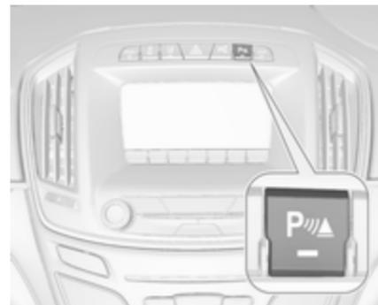
Коли ввімкнено задню передачу, передня та задня система допомоги під час паркування готові до роботи.
