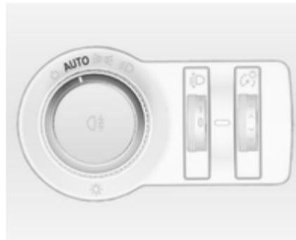
Коли функцію автоматичного керування освітленням увімкнено, а двигун працює, система автоматично змінює режим освітлення при денному світлі та режим увімкнення ближнього/ дальнього світла, залежно від умов освітлення та даних системи датчиків дощу.
