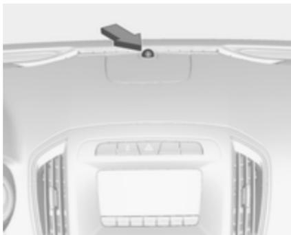
Індикатор стану вмонтовано в датчик на верхній частині панелі приладів.
