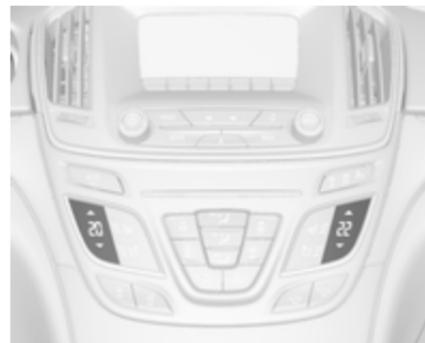
Налаштування температури для місця водія і місця пасажирів відображаються на панелях окремо.
