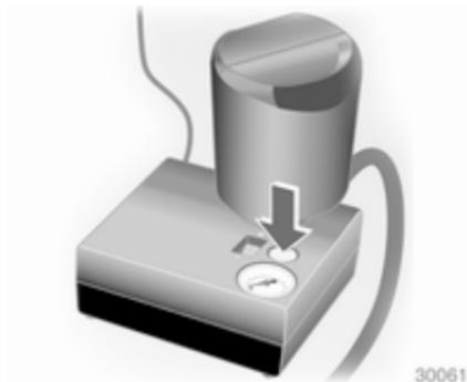
Якщо протягом 10 хвилин вказаного рівня тиску не досягнуто, вийміть набір для ремонту шин. Пересуньте автомобіль на один оберт шини. Повторно під'єднайте набір для ремонту шин і продовжуйте процедуру заповнення протягом 10 хвилин. Якщо вказаний тиск у шинах все ще не вдається отримати, це свідчить про серйозне пошкодження шини. Зверніться по допомогу до майстерні.
