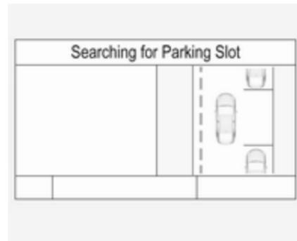
Поки автомобіль із увімкненою системою допомоги під час паркування рухається уздовж ряду машин, розширена система допомоги під час паркування здійснює пошук місця для парковки. В разі виявлення придатного місця для паркування система подає візуальний та звуковий сигнали в центрі інформації водія.
