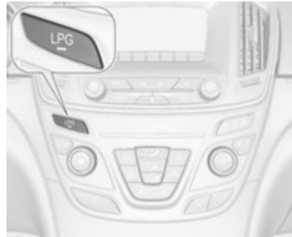
Натискання кнопки **LPG** здійснює перехід між режимом роботи на бензині та режимом роботи на скрапленому газі. Світлодіодний індикатор стану
