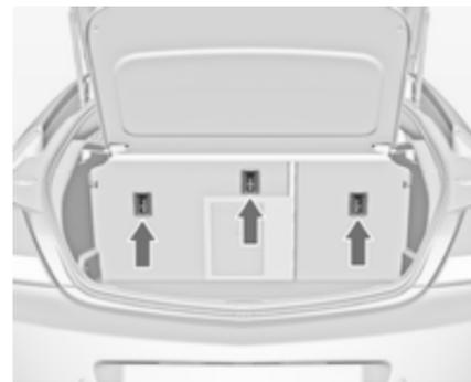
Установивши систему ISOFIX, закріпіть ремінь Top-Tether в отворах кріплення Top-Tether. Пасок повинен проходити між двома направляючими валиками підголовника.
