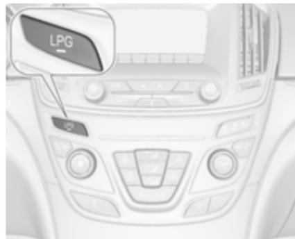
Натисніть кнопку **LPG**, щоб переключити автомобіль з бензину на скраплений газ одразу ж після
