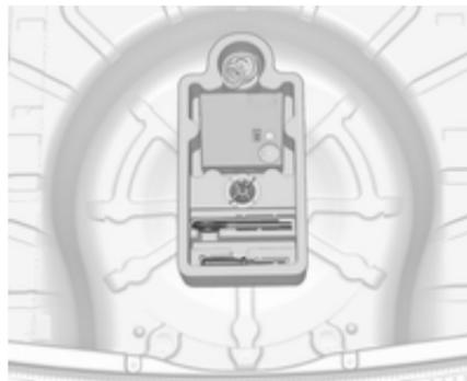
Інструменти і буксирна серга розташовані разом із комплектом для ремонту шин у ящику для інструментів під підлогою багажного відділення.
