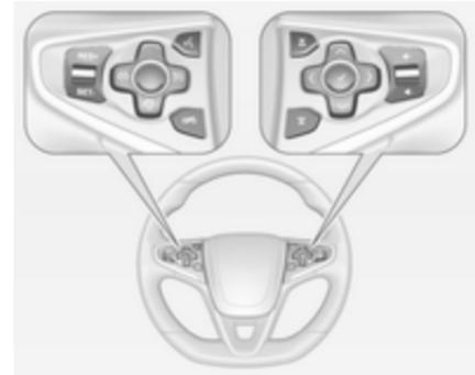
Центром інформації для водія, деякими допоміжними системами водія, інформаційно-розважальною системою і підключеним мобільним телефоном можна керувати за допомогою засобів на кермі.
