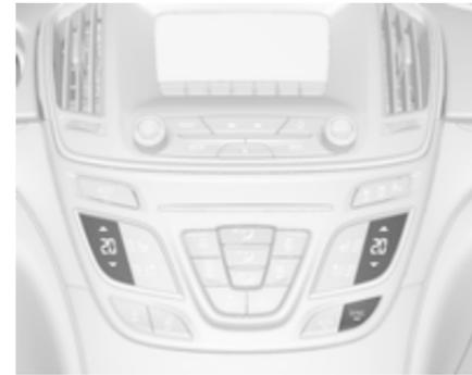
Встановіть потрібну температуру: для підвищення температури торкніться перемикача ▲, а для зниження температури - перемикача ▼.
