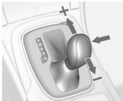
Для переходу на ручний режим, переведіть важіль селектора з положення **D** ліворуч.
