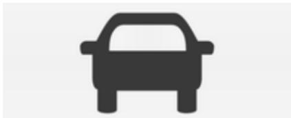
Про наявність автомобіля попереду сигналізує контрольний індикатор
