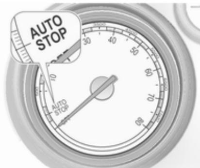
Функція Автостоп позначається стрілкою у положенні **AUTOSTOP** на тахометрі. У деяких модифікаціях моделі, коли двигун перебуває в стані "Автостоп", на панелі приладів світиться контрольний індикатор.
