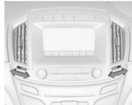
Щоб відчинити повітропровід, поверніть колесо регулятора в положення I. Відрегулюйте потік повітря, що надходить через повітропровід, повернувши колесо регулятора у потрібне положення.
