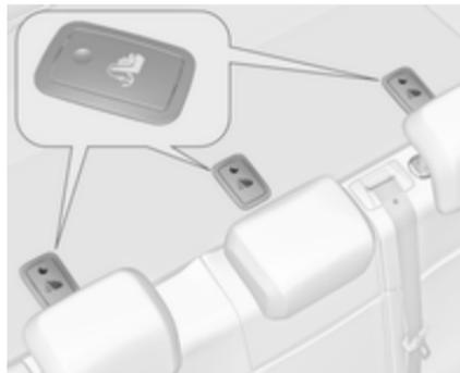
Відкрийте клапан потрібного отвору, позначеного символом дитячого сидіння.
