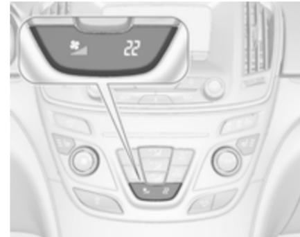
Налаштування температури і швидкості вентилятора вказані на дисплеї системи клімат-контролю.
