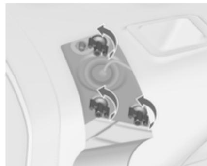
2. Відкрутіть три пластикових гайки рукою.
