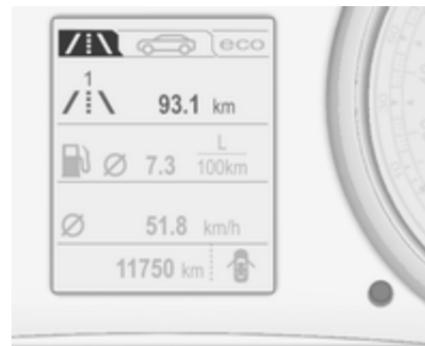
На сторінці бортового комп'ютера відображається зареєстрована відстань, пройдена автомобілем після останнього скидання показників. Для різних поїздок можна вибрати два лічильники пробігу.
