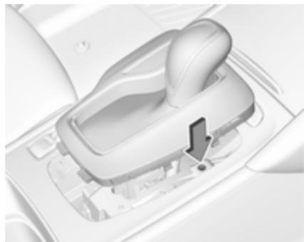
3. Вставте в отвір біля важеля селектора маленьку паличку (наприклад, ручку чи викрутку). Натисніть на паличку, тримаючи її вертикально, і посуньте важіль селектора з положення **P**. Якщо знову вибрати цю передачу, важіль селектора знову буде заблоковано. Для усунення переривання живлення зверніться на СТО.
