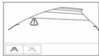
Multimedia Navi: Відображення попереджувальних символів і напрямних можна вимкнути й вимкнути за допомогою сенсорних кнопок у нижній частині екрана.
