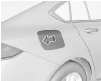
Кришку горловини паливного баку можна відчинити лише, якщо автомобіль розблоковано. Натиснувши кришку горловини паливного баку, зніміть її.
