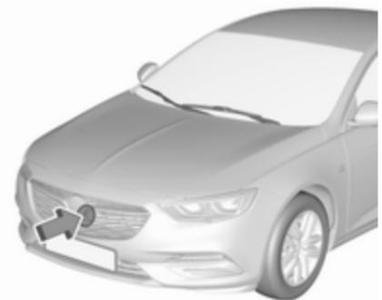
Датчик радара встановлюється за радіаторною решіткою або нижче емблеми марки автомобіля.
