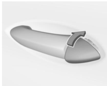
Замкнувши дверцята, закрійте отвір замка кришкою: вставте кришку нижньою частиною в заглиблення і притисніть, щоб закріпити її верхню частину.
