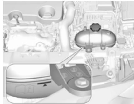
Положення контейнера для охолоджувальної рідини двигуна може відрізнятися залежно від двигуна.
