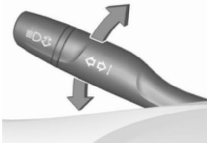
Під час паркування автомобіля можна активувати ліхтарі стоянкового освітлення з одного боку:
