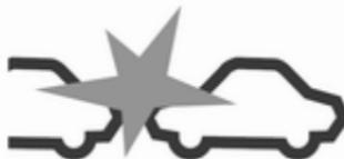
Якщо до можливого зіткнення з автомобілем попереду лишається зовсім мало часу, і зіткнення неминуче, в інформаційному центрі водія з'являється спливний попереджуvalnyj symbol, а на приладову панель на вітровому склі в полі зору водія проєктується червона миготлива світлодіодна стрічка або спливний символ.
