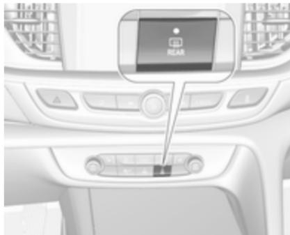
Підігрівання заднього вікна та зовнішніх дзеркал вмикається та вимикається натисненням кнопки **REAR**. Під час роботи системи в кнопці світиться світлодіод.
