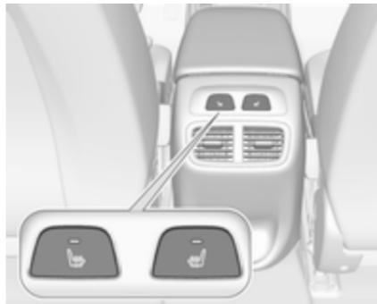
Підігрів сидіння вмикається натисканням для відповідного заднього сидіння. На активований стан указує індикатор у кнопці. Натисніть ще раз, щоб вимкнути підігрів сидіння.
