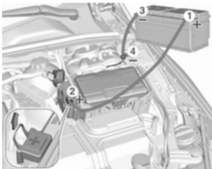
Зніміть захисні ковпачки з позитивних виходів акумуляторів в обох автомобілях.
