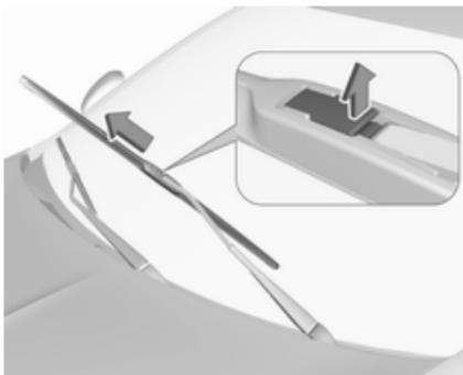
Установіть важіль склоочисника у підняте положення. Підніміть фіксатор, щоб від'єднати щітку склоочисника, і зніміть її.
