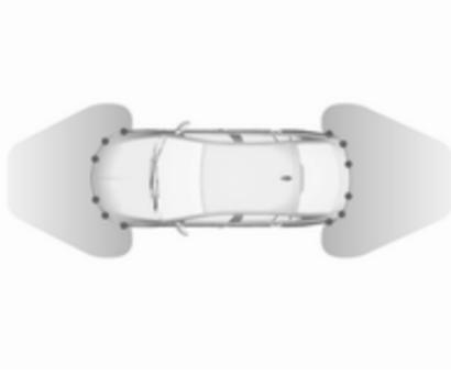
Розширенна допомога при паркуванні завжди поєднується із системою допомоги під час паркування переднім й заднім ходом. Обидві системи використовуються ті самі датчики на передньому та задньому бампері.
