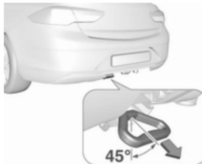
Після того, як ви відпустите ручку розчіплювача і палець з кульковим наконечником від'єднається, пролунає звуковий сигнал.
