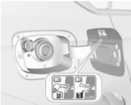
Завдяки цьому захисному пристрою кришку заливної горловини можна відкрити лише насадкою для заливання відповідного пального або лійкою для екстремого доливання пального.
