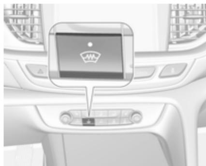
Якщо автомобіль обладнано лобовим склом з підігрівом, замість кнопки
