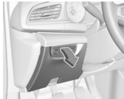
В автомобілях із лівостороннім керуванням коробка запобіжників знаходиться під кришкою панелі приладів.
