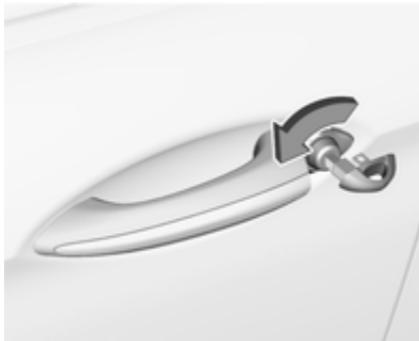
Вставте лезо ключа в отвір замка й поверніть його, щоб відчинити дверцята водія вручну.
