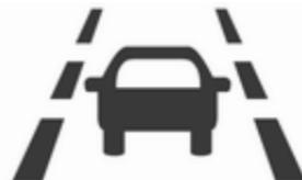
Якщо контрольний індикатор ⌘ на панелі приладів або на приладовій панелі на вітровому склі світиться зеленим світлим, це означає, що система готова до роботи.
