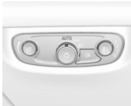
Коли функцію автоматичного керування освітленням увімкнено, а двигун працює, система автоматично перемикається на режим освітлення при денному світлі або на режим увімкнення фар – залежно від навколошнього
