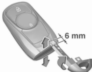
2. Щоб відкрити корпус, знову вставте лезо ключа приблизно на 6 мм і поверніть ключ. Якщо вставити лезо ключа глибше, можна пошкодити корпус.
