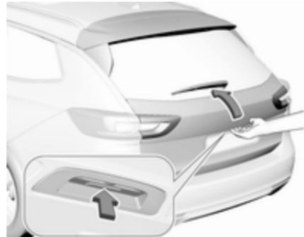
Після відмикання дверей багажного відділення натисніть розміщену на них кнопку під молдингом і відчиніть їх.
