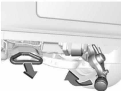
Потягніть за рукоятку, розташовану ліворуч від номерного знака під заднім бампером, під кутом приблизно  $45^{\circ}$  до поверхні ґрунту.
