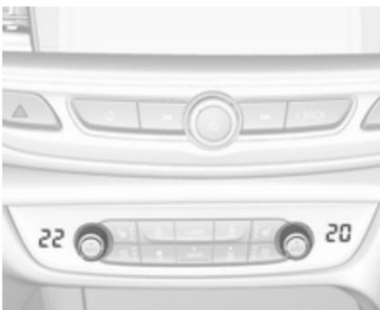
Установіть наперед визначені рівні температури окремо для місць водія та пасажира на передньому сидінні за допомогою регуляторів ліворуч і праворуч. Регулятор з боку пасажира регулює температуру з боку пасажира. Регулятор з боку водія може регулювати температуру з боку водія, а також температуру з обох боків, коли ввімкнuto режим синхронізації **SYNC**.
