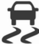
Система ESC готова до роботи після кожного запуску двигуна, щойно контрольний індикатор
