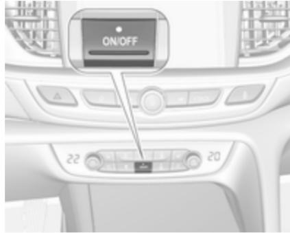
Режим охолодження, вентилятор і автоматичний режим можна вимикати кнопкою **ON/OFF**. Коли система вимкнена, індикатор у кнопці **ON/OFF** не світиться.
