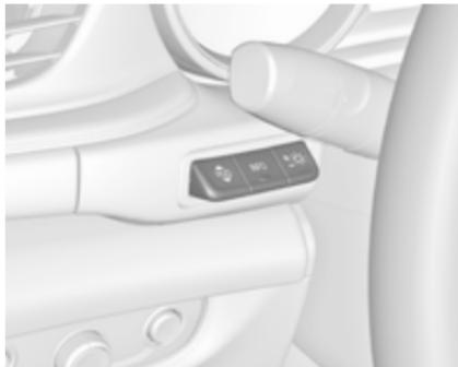
Для керування проекційним дисплеєм використовуються три перемикачі, розташовані над перемикачем освітлювальних приладів.
