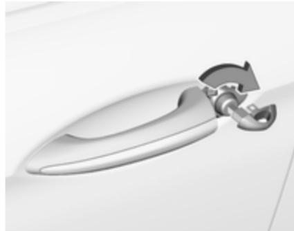
Натисніть кнопки дверних замків всіх дверцят, за винятком водійських або натисніть ⌂ на панелі дверцят водія. Потім закрійте дверцята водія і замкніть їх іззовні за допомогою ключа. Двері багажного відділення і кришка горловини паливного бака, скоріше за все, залишається не замкненими.
