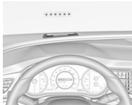
У разі швидкого наближення до визначеного пішохода на лобове скло в полі зору водія проециється миготливий індикатор або спливаючий символ ⚠. Лунає попереджувальний звуковий сигнал. Може спрацювати система підготовки гальм, для того щоб при натисненні водієм педалі гальм
