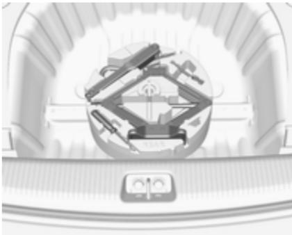
Домкрат з колісним ключем, інструментами, довгим болтом для закріплення пошкодженого колеса та буксируна серга розташовані у ящику для інструментів - під запасним колесом у багажному відділенні.
