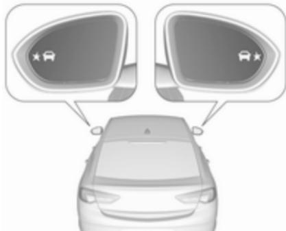
При запуску двигуна індикатори в обох зовнішніх дзеркалах засвітяться на короткий час, повідомляючи, що система діє.
