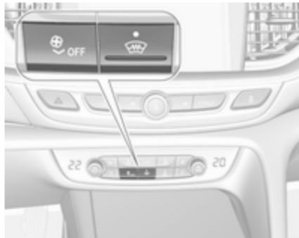
Якщо автомобіль обладнано лобовим склом з підігрівом, замість кнопки **ON/OFF** використовується кнопка
