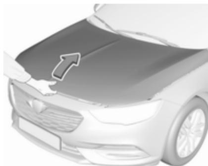
Зсуньте запобіжну защіпку до лівого боку автомобіля і відкрийте капот.
