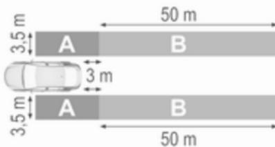
Датчики системи охоплюють паралельні зони завширшки близько 3,5 м з обох боків автомобіля, які простягаються приблизно на 3 м позаду автомобіля (дані використовує система попередження про об'єкти в бічній мертвій зоні (A)), а також зони завдовжки близько 50 м на паралельних смугах руху (дані використовує система попередження про перешикування (B)). Ці зони починаються від зовнішніх дзеркал з кожного боку. Висота зони становить приблизно від 0,5 м до 2 м від рівня землі.
