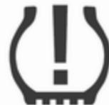
Розпізнавання стану тиску в шинах позначається контрольним індикатором  $\text{U} \diamond 121$ .
