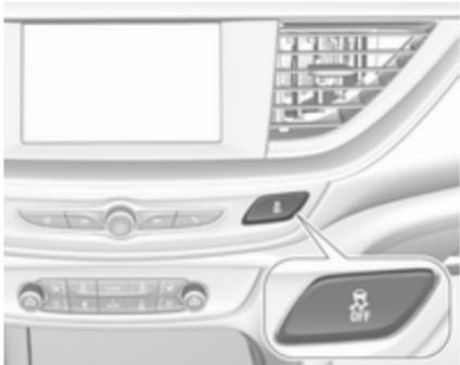
Систему ТС можна вимкнути, коли ведучі колеса мають обертатися. Для цього натисніть і відпустіть  $\text{ESC}_{\text{off}}$ .
