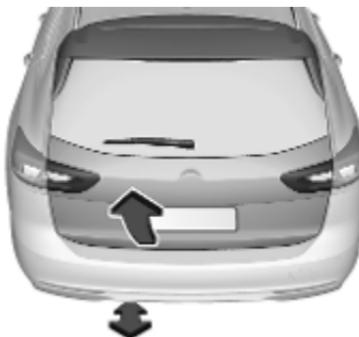
Щоб відчинити чи зачинити двері багажного відділення, підсуньте ногу під задній бампер по його центру, а потім швидко приберіть її. Тримати ногу під бампером не потрібно. Електронний ключ має бути зовні автомобіля з відповідної сторони на відстані приблизно 1 м від дверей багажного відділення. Виявивши рух стопи за допомогою датчика, система з невеликою затримкою приводить у рух двері багажного відділення.
