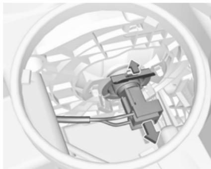
2. Від'єднайте патрон лампи від розніму, притиснувши фікатор вперед. Вийміть патрон лампи з корпусу рефлектора.
