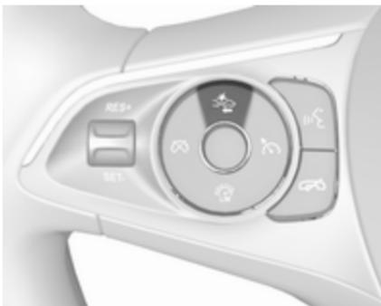
Коли кнопка натискається вперше, в інформаційному центрі водія відображається поточне значення. При повторних натисканнях це значення змінюється. Вибране значення діє до наступної зміни. Завчасність попередження залежить від швидкості автомобіля. Чимвища швидкість, тим на більшій дистанції спрацює функція попереджень. При виборі завчасності попереджень слід враховувати умови дорожнього руху та погодні умови.
