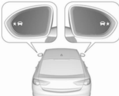
При запуску двигуна індикатори в обох зовнішніх дзеркалах засвітяться на короткий час, повідомляючи таким чином, що система діє.
