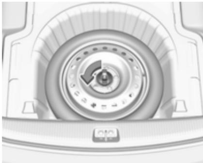
Запасне колесо розташоване в багажному відділенні під покриттям полика.
