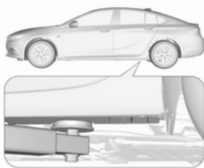
Розміщення заднього кронштейна підйомної платформи по центру під відповідною точкою встановлення домкрата.
