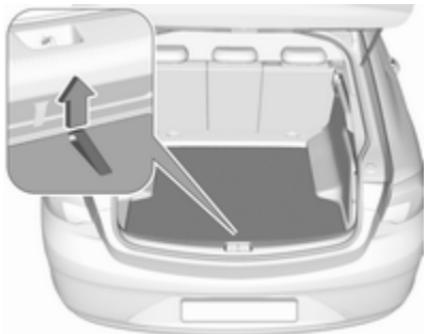
Кришка полика в задній частині автомобіля знімається. Підніміть полик за петлю і вийміть.
