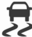
Протибуксовальна гальмівна система (TC) переводиться в робочий стан після кожного запуску двигуна, як тільки згасне індикатор ⚡.
