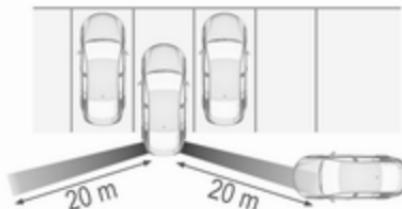
Датчики системи охоплюють зону ліворуч і праворуч позаду автомобіля радіусом приблизно 20 м і кутом 90°. Система попередження про транспортні засоби, які рухаються позаду перпендикулярно, активна на швидкості до 10 км/год. Вона попереджає про ТЗ, які рухаються зі швидкістю до 36 км/год.
