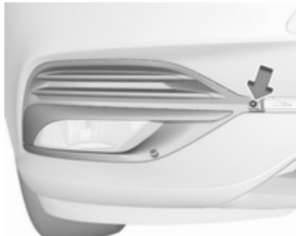
Відкрутіть гвинт зіркоподібною викруткою та зніміть передню панель.
