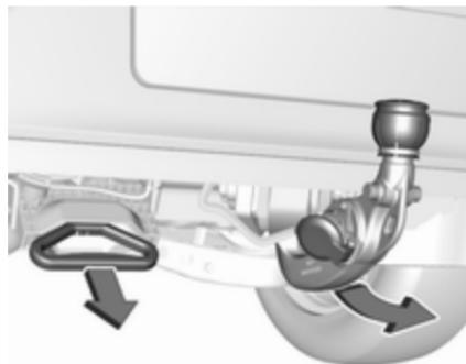
Відтягніть рукоятку, яка знаходиться ліворуч від номерного знака під заднім бампером, на кут приблизно  $45^{\circ}$  відносно землі.
