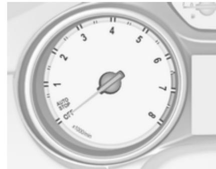
Вказує швидкість роботи двигуна. Їдьте на низких обертах для кожної передачі настільки довго, наскільки це можливо.
