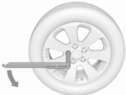
2. Розкладіть ключ і встановіть його, перевіривши надійність його положення, після чого відкрутіть кожну гайку на півверта.
