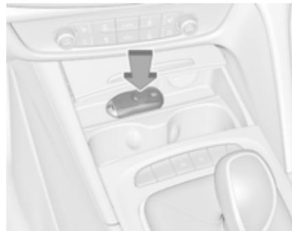
Відкрийте кришку на центральній консолі перед важелем селектора. Покладіть електронний ключ кнопками догори впоперек відсіку для передавача поруч із розеткою, як показано на рисунку.
