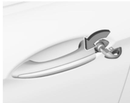
Вставте лезо ключа в отвір замка й поверніть його, щоб відчинити дверцята водія вручну.
