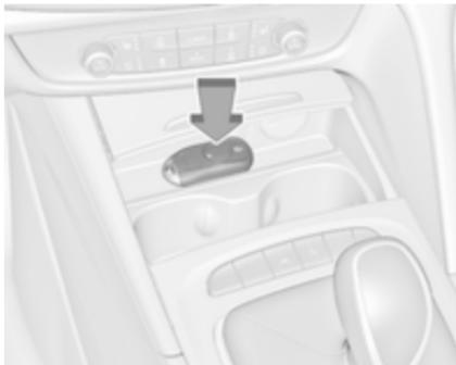
Відкрийте кришку на центральній консолі перед важелем селектора. Покладіть електронний ключ кнопками догори впоперек відсіку для передавача поруч із розеткою, як показано на рисунку.
