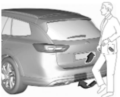
Щоб відчинити чи зачинити двері багажного відділення, підсуньте ногу під задній бампер по його центру, а потім швидко приберіть її. Тримати ногу під бампером не потрібно. Електронний ключ має бути зовні автомобіля з відповідної сторони на відстані приблизно 1 м від дверей багажного відділення. Виявивши рух стопи за допомогою датчика, система з невеликою затримкою приводить у рух двері багажного відділення.
