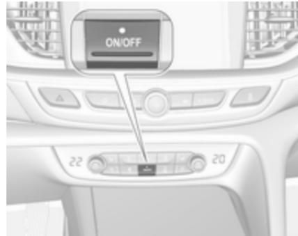
Режим охолодження, вентилятор і автоматичний режим можна вимикати кнопкою **ON/OFF**. Коли система вимкнена, індикатор у кнопці **ON/OFF** не світиться.
