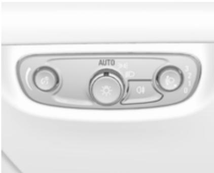
Коли функцію автоматичного керування освітленням увімкнено, а двигун працює, система автоматично перемикається на режим освітлення при денному світлі або на режим увімкнення фар – залежно від навколишнього
