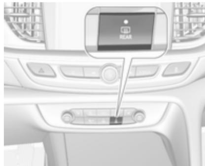
Підігрівання заднього вікна та зовнішніх дзеркал вмикається та вимикається натисненням кнопки . Під час роботи системи в кнопці світиться світлодіод.
