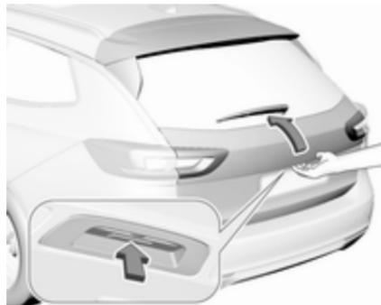
Після відмикання дверей багажного відділення натисніть розміщену на них кнопку під молдингом і відчиніть їх.
