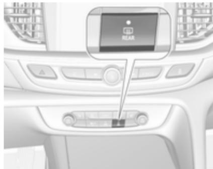
Підігрівання заднього вікна та зовнішніх дзеркал вмикається та вимикається натисненням кнопки . Під час роботи системи в кнопці світиться світлодіод.
