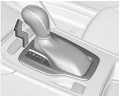
2. Відчепіть оздоблювальну накладку важеля перемикання передач від центральної консолі. Натисніть пальцем на вкриту шкірою заглибину поруч із важелем селектора і повільно потягніть оздоблювальну накладку догори. Зверніть увагу на кабель, що до неї підключений. Посуньте оздоблювальну накладку трохи вперед – у задній частині вона кріпиться на петлях. Нахиліть від'єднане оздоблення вліво, щоб не натягувати кабель.
