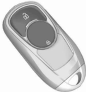
Центральним замком можна також керувати за допомогою кнопок на електронному ключі.
