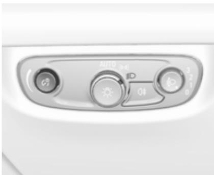
Яскравість освітлення вказаних нижче приладів можна відрегулювати у положенні **AUTO**, якщо фотоелемент виявить нічне освітлення, а також у положеннях  $\text{D}$  та  $\text{D}$ .
