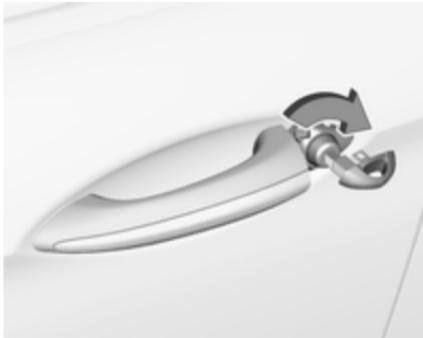
Натисніть кнопки дверних замків всіх дверцят, за винятком водійських або натисніть ⌂ на панелі дверцят водія. Потім закрійте дверцята водія і замкніть їх іззовні за допомогою ключа. Двері багажного відділення і кришка горловини паливного бака, скоріше за все, залишається не замкненими.
