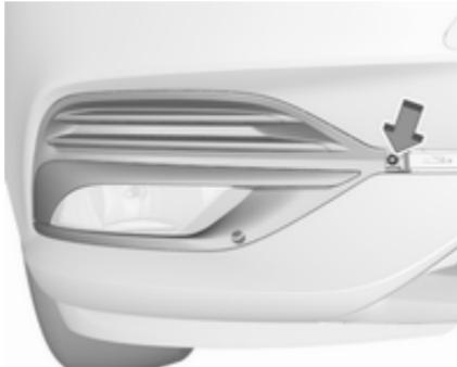
Відкрутіть гвинт зіркоподібною викруткою та зніміть передню панель.
