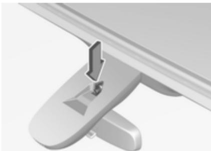
Підтримуйте чистоту датчика, запобігаючи потраплянню на нього пилу, бруду та льоду.
