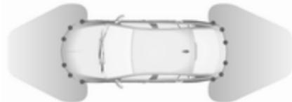
Розширення допомога при паркуванні завжди поєднується із системою допомоги під час паркування переднім й заднім ходом. Обидві системи використовуються ті самі датчики на передньому та задньому бампері.
