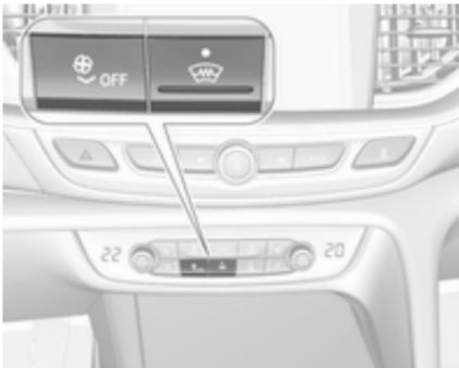
Якщо автомобіль обладнано лобовим склом з підігрівом, замість кнопки **ON/OFF** використовується кнопка
