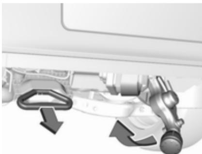
Потягніть за рукоятку, розташовану ліворуч від номерного знака під заднім бампером, під кутом приблизно  $45^{\circ}$  до поверхні ґрунту.
