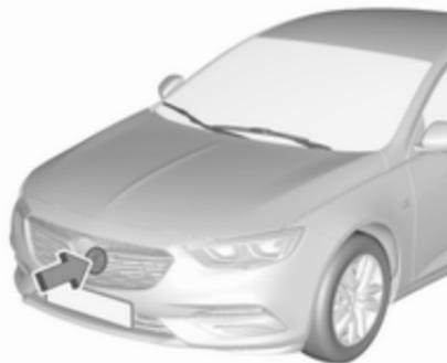
Датчик радара встановлюється за радіаторною решіткою або нижче емблеми марки автомобіля.
