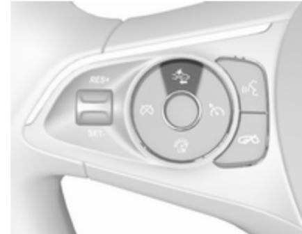
Коли кнопка натискається вперше, в інформаційному центрі водія відображається поточне значення. При повторних натисканнях це значення змінюється. Виbrane значення діє до наступної зміни. Завчисність попередження залежить від швидкості автомобіля. Чим вища швидкість, тим на більшій дистанції спрацює функція попереджень. При виборі завчисності попереджень слід враховувати умови дорожнього руху та погодні умови.
