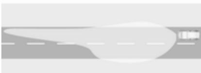
Активується автоматично на швидкості понад 50 км/год на певний час. Поліпшене освітлення смуги руху та узбіччя дороги. Не засліплює водіїв автомобілів, які рухаються попереду або а протилежному напрямку.
