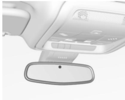
Під час руху у темний час добі дія сліпучого світла від автомобілів позаду автомобільно зменшується.
