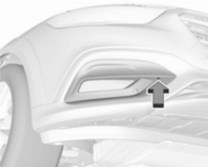
Відкрутіть гвинт зіркоподібною викруткою.
