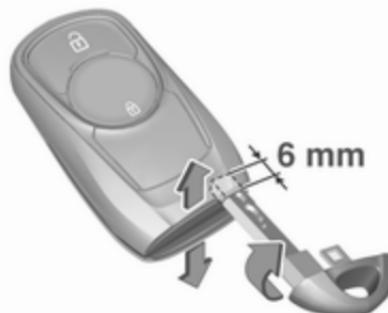
2. Щоб відкрити корпус, знову вставте лезо ключа приблизно на 6 мм і поверніть ключ. Якщо вставити лезо ключа глибше, можна пошкодити корпус.
