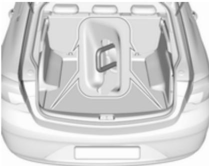
Кріпильні петлі запобігають ковзанню предметів у багажнику під час руху. Через них можна пропускати пасочки для прив'язування вантажу або зачіплювати за них сітку для кріплення багажу.
