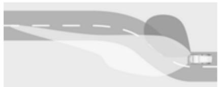
Для поліпшення освітлення під час поворотів вмикаються додаткові світлодіоди відповідно до кута повороту та швидкості автомобіля. Ця функція активується на швидкості 40–70 км/год. Дальнє світло збільшує інтенсивність освітлення на поворотах.
