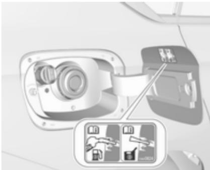
Завдяки цьому захисному пристрою кришку заливної горловини можна відкрити лише насадкою для заливання відповідного пального або лійкою для екстреного доливання пального.
