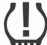
Розпізнавання стану тиску в шинах позначається контрольним індикатором  $\text{!} \diamond 120$ .
