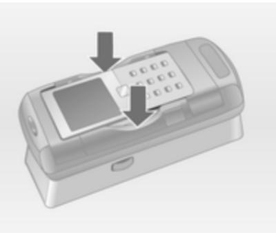
Відкривши їх, опускайте мобільний телефон в адаптер вертикально, як показано на малюнку, доки кронштейни не закриються.
