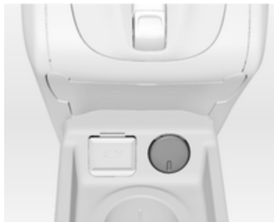
Розетка з напругою 12 В розташована на передній консолі.
