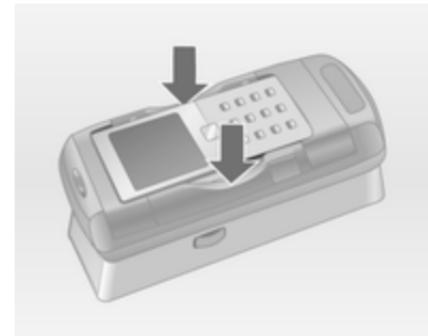
Після відкриття бокових дужок опускайте мобільний телефон в адаптер вертикально, як показано на малюнку, доки дужки не закриються.
