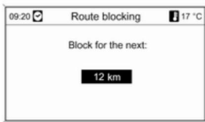
Установіть потрібну відстань, натисніть на багатофункціональний регулятор, потім підтвердіть повідомлення, що відобразиться на екрані.
