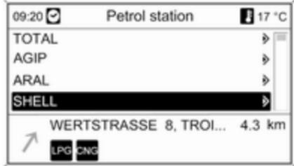
Нижче наводиться список детальної інформації про відмічену АЗС: приблизний напрямок до АЗС, адреса, відстань та наявні типи палива (окрім бензину та дизельного палива).
