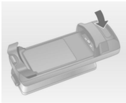
Після цього опустіть його задню частину.
