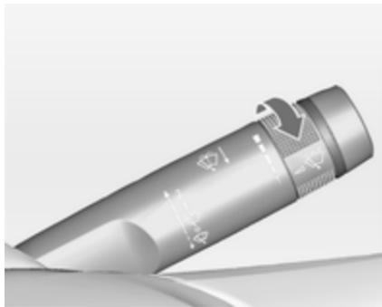
Поверніть колесо регулятора, щоб відрегулювати чутливість:
