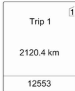
Інформацію двох бортових комп'ютерів можна скинути окремо, що робить можливим відображення різних відстаней.
