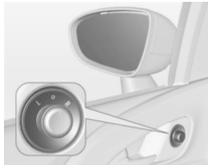
Виберіть потрібне зовнішнє дзеркало та відрегулюйте його. Випуклі зовнішні дзеркала  $\diamond$  32, електричне регулювання  $\diamond$  32, зовнішні дзеркала, що складаються  $\diamond$  32, зовнішні дзеркала з підігрівом  $\diamond$  32.
