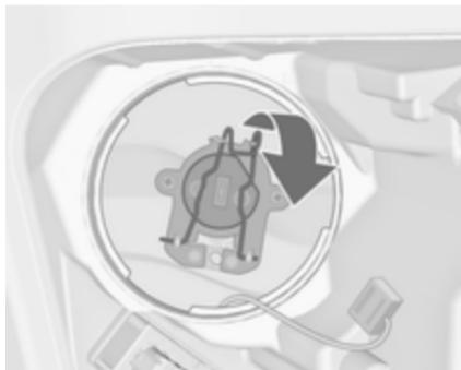
3. Від'єднайте пружинний затискач, після чого поверніть його назад.
