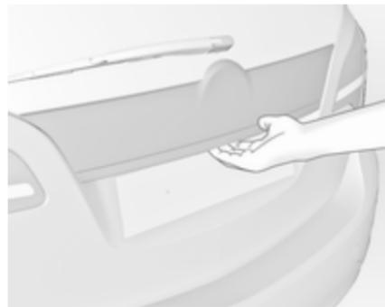
Після відімкнення натисніть сенсорний перемикач під молдингом і відкрийте багажник. Центральний замок ⇨ 23.
