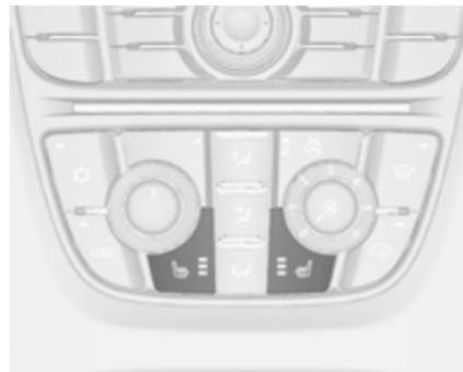
Установіть потрібний параметр підігріву відповідного сидіння, натиснувши кнопку один або декілька разів. Контрольний індикатор у кнопці вказує параметр.
