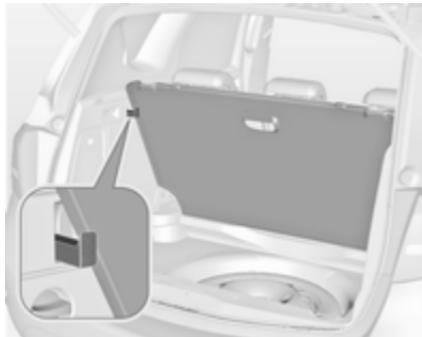
Знімна кришка полика в задній частині автомобіля піднімається. Складіть її вгору та злегка підніміть кришку багажника.
