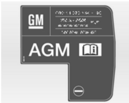
Акумулятор AGM можна розпізнати по ярлику на акумуляторі. Ми рекомендуюмо використовувати фірмовий акумулятор Opel.
