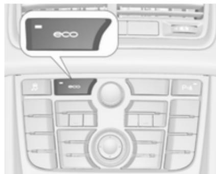
Вимкніть систему стоп-старт вручну, шляхом натискання на кнопку **eco**. Вимкнення підтверджується тим, що світлодіодний індикатор у кнопкі гасне.
