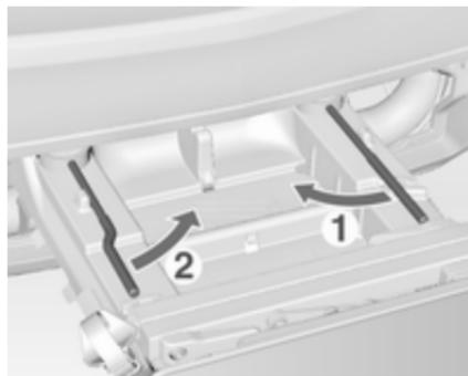
Спочатку поверніть правий затискний важіль (1), після чого поверніть лівий затискний важіль (2), доки не відчуєте спротив.
