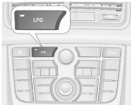
Натискання кнопки **LPG** здійснює перехід між режимом роботи на бензині та режимом скрапленого газу. Світлодіодний індикатор позначає поточний режим роботи.
