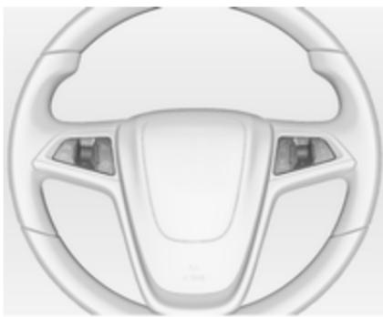
Інформаційно-розважальною системою, круїз-контролем і підключеним мобільним телефоном можна керувати за допомогою засобів на кермі.
