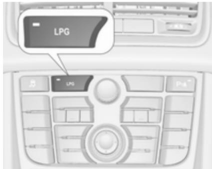
При натисканні кнопки **LPG**, робота автомобіля перемикається з бензину на скраплений газ одразу
