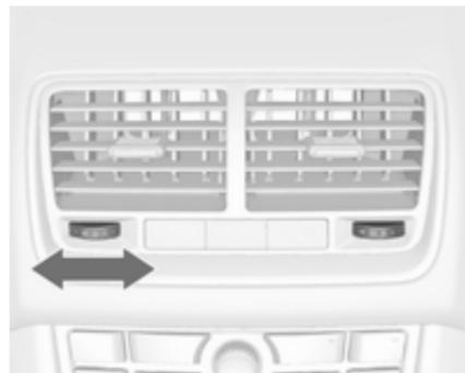
Щоб відкрити повітропровід, поверніть колесо регулятора вправо. Відрегулюйте потік повітря, що надходить через повітропровід, повертаючи колесо регулятора в потрібне положення.
