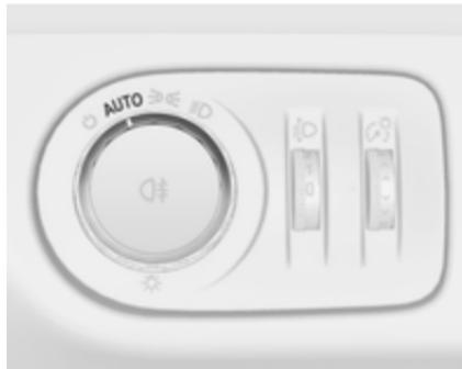
Коли функцію автоматичного керування освітленням із запущеним двигуном увімкнено, система залежно від умов
