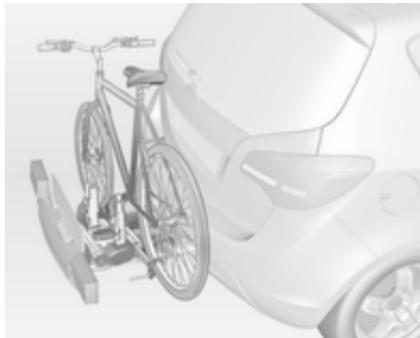
На задній системі кріплення багажу (система Flex-Fix) можна закріплювати велосипеди на витяжному трамбачі, вбудованому в полик автомобіля. Перевезення інших речей заборонено.
