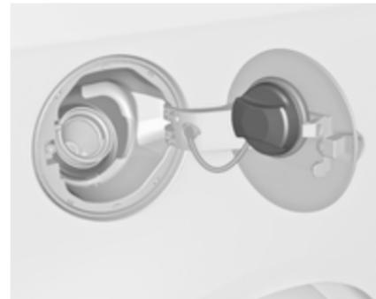
Кришка горловини паливного баку може бути зафікована в скобі на горловині паливного баку.
