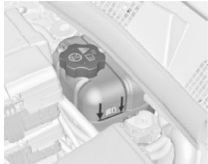
Якщо система холодна, рівень охолоджуючої рідини повинен бути вище лінії наповнення. Якщо рівень низький, долийте рідину.
