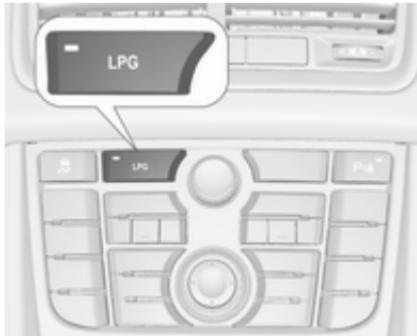
При натисканні кнопки **LPG**, робота автомобіля перемикається з бензину на скраплений газ одразу
