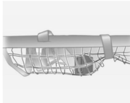
Обережно зафіксуйте стрічку Velcro навколо сітки біля регуляторів довжини. Регулятори довжини та рейки сітки мають бути розташовані поруч на одній лінії.
