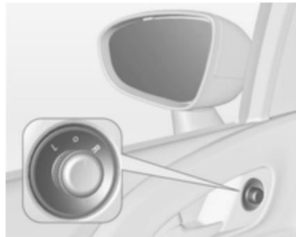
Виберіть потрібне зовнішнє дзеркало та відрегулюйте його. Випуклі зовнішні дзеркала ⇨ 32, електричне регулювання ⇨ 32, зовнішні дзеркала, що складаються ⇨ 32, зовнішні дзеркала з підігрівом ⇨ 32.
