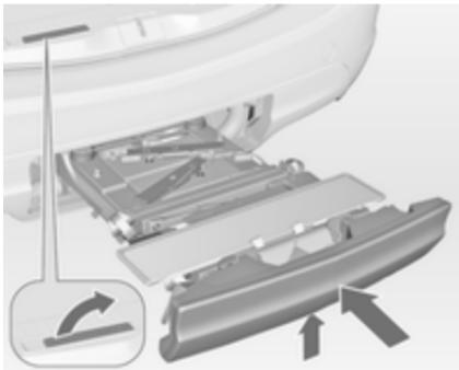
Штовхніть важіль розблокування вгору та утримуйте його в такому положенні. Злегка підніміть систему і посуньте її в бампер до фіксації.
