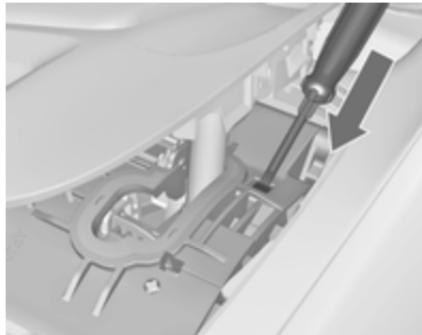
5. Вставте викрутку в отвір до кінця та перемістіть важіль селектора з положення **P** або **N**. Якщо повторно вибрати передачу **P** або **N**, важіль селектора буде знову заблоковано в цьому положенні. Щоб усунути причину переривання подачі живлення, зверніться до майстерні.
