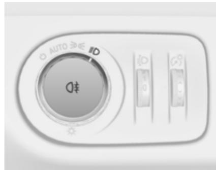
Приводиться в дію за допомогою кнопки  $\text{ֆ} \text{D}$ .
