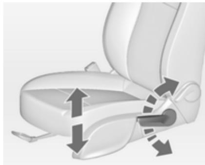
Накачування важелем угору = сидіння вище
