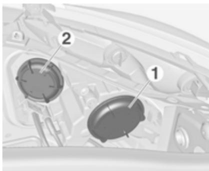
Фари оснащено окремими системами близького й дальнього світла 1 (крайні лампи) і додаткового дальнього світла 2 (внутрішні лампи). Габаритні
