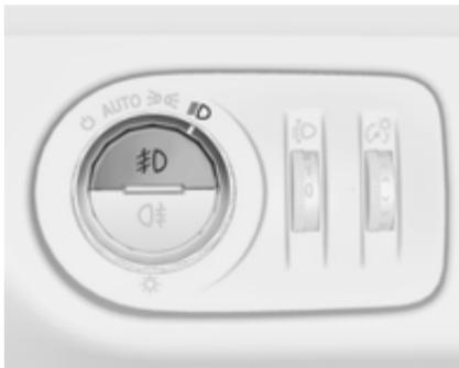
Приводиться в дію за допомогою кнопки  $\text{ֆ} \text{D}$ .
