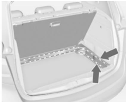
Якщо кришку закріплено у верхніх отворах, простір між нею та кришкою ніші для запасного колеса можна використовувати як відділення для зберігання.
