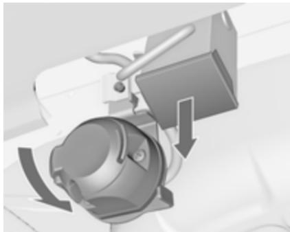
Відключіть та складіть розетку. Вийміть ущільнюючу пробку з отвору для штанги та приберіть її.
