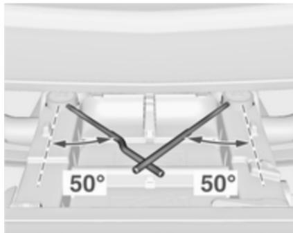
Задня система кріплення заблокована, коли затисні важелі повернуто приблизно на 50°.
