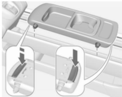
Натисніть кнопки спереду та ззаду, після чого встановіть штифти у верхні чи нижні направляючі рейки. Кнопку спереду потрібно натиснути до упору. Відпустіть кнопки та перемістіть тримач для склянок, доки він не зафіксується на місці з характерним звуком.
