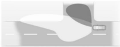
На поворотах з обмеженою видимістю чи під час звертання з дороги, залежно від кута керма чи сигналу індикатора, ліворуч або праворуч вмикається додатковий рефлектор, який освітлює дорогу в напрямку руху. Активується на швидкості 40 км/год.
