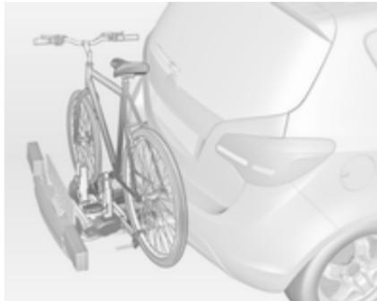
На задній системі кріплення багажу (система Flex-Fix) можна закріплювати велосипеди на витяжному трамічі, вбудованому в полик автомобіля. Перевезення інших речей заборонено.
