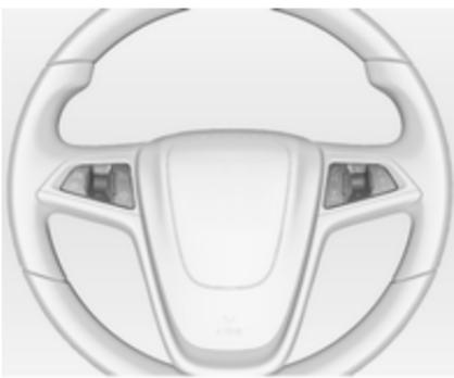
Інформаційно-розважальною системою, круїз-контролем і підключенім мобільним телефоном можна керувати за допомогою засобів на кермі.
