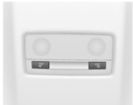
Вмикається разом із переднім підсвічуванням салону залежно від положення кулісного перемикача.
