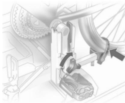
Затягніть вручну закріпний гвинт тримача підшипника педалі до упору.
