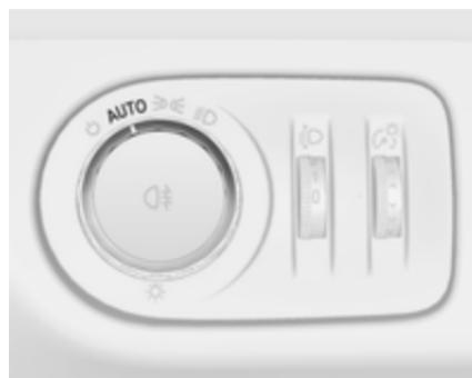
Коли функцію автоматичного керування освітленням із запущеним двигуном увімкнено, система залежно від умов освітлення відповідно активує режим освітлення при денному світлі або ж близьке світло фар.
