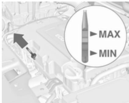
Залежно від варіанта двигуна використовуються різні щупи.
