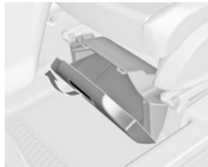
Залежно від типу автомобіля коробка розташована під сидінням водія. Потягніть ручку й відкрийте кришку. Максимальне навантаження: 1,5 кг.
