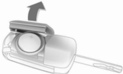
Розкладіть ключ і відчиніть блок. Замініть батарею (тип батареї CR 2032), беручи до уваги її положення під час установлення. Зачиніть блок і здійсніть синхронізацію.
