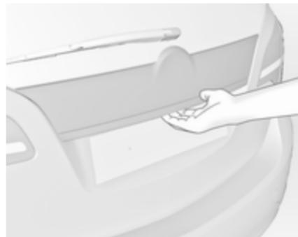
Після розблокування натисніть сенсорний перемикач під молдингом та відчиніть багажник. Центральний замок ⌘ 23.
