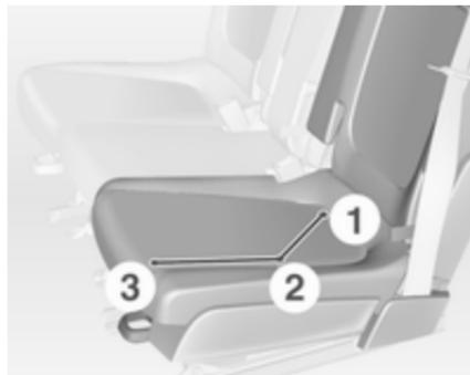
Щоб забезпечити максимальний простір для пасажирів, можна встановлювати два бокові сидіння заднього ряду в положення 1 або всі сидіння в положення 2. У положенні 1 спинка центрального сидіння опускається.
