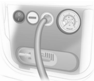
8. Увімкніть компресор шляхом натискання на вимикач on/off. Шина наповнюється ущільнювачем.
