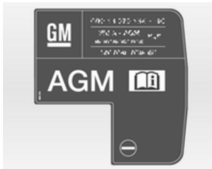
Акумулятор AGM можна розпізнати по ярлику на акумуляторі. Ми рекомендуємо використовувати фірмовий автомобільний акумулятор Opel.
