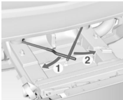
Спочатку поверніть назад лівий затискний важіль (1), після чого поверніть правий затискний важіль (2) до упору.
