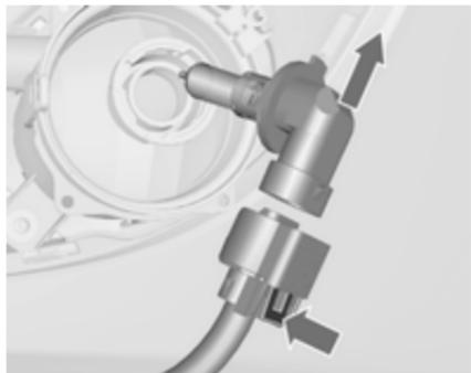
2. Від'єднайте тримач від з'єднувача, натиснувши закріплювач.
