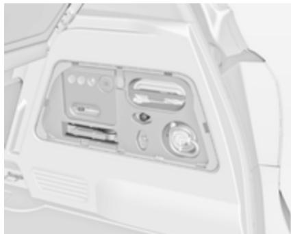
Варіант 1: набір інструментів зберігається в правому відділенні багажника разом із набором для ремонту шин.
