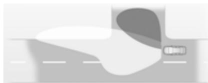
На поворотах з обмеженою видимістю чи під час звертання з дороги, залежно від кута керма чи сигналу індикатора, ліворуч або праворуч вмикається додатковий рефлектор, який освітлює дорогу в напрямку руху. Активується на швидкості 40 км/год.
