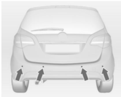
Система складається з чотирьох ультразвукових датчиків у задньому бампері. Фронтальна система допомоги під час паркування, якою може бути обладнано автомобіль, складається з чотирьох додаткових ультразвукових датчиків паркування, розміщених у передньому бампері.
