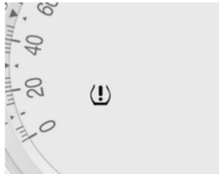
Розпізнавання стану тиску в шинах позначається контрольним індикатором
