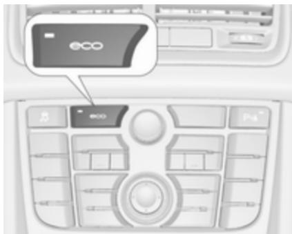
Вимкніть систему стоп-старт вручну, шляхом натискання на кнопку **eco**. Після вимкнення системи індикатор у кнопці згасне.
