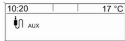
Функціями аудіоджерела, під'єднаного до вхідного гнізда AUX, можна керувати лише за допомогою відповідних елементів аудіоджерела.
