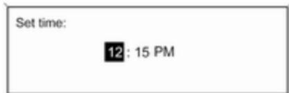
Поверніть багатофункціональний перемикач, щоб змінити поточне значення налаштування.
