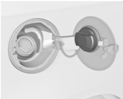
Кришку горловини паливного баку може бути зафікована в скобі на горловині паливного баку.
