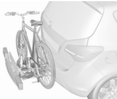
На задній системі кріплення багажу (система Flex-Fix) можна закріплювати велосипеди на витяжному тримачі, вбудованому в полик автомобіля. Перевезення інших речей заборонено.
