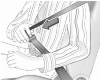
Витягніть пасок із переднатягувача, протягніть пасок безки по діагоналі через плече й грудну клітку (пасок не повинен перекручуватися) і вставте язичок защіпки в пряжку. Регулярно посилюйте щільність прилягання поясного паска безпеки під час водіння, натягуючи плечовий пасок.
