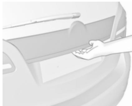
Після розблокування натисніть сенсорний перемикач під молдингом та відчиніть багажник. Центральний замок ⚡ 24.
