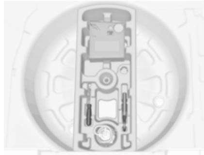
Варіант 2: набір інструментів зберігається в відділенні багажника під кришкою підлоги разом із комплектом для ремонту шин.
