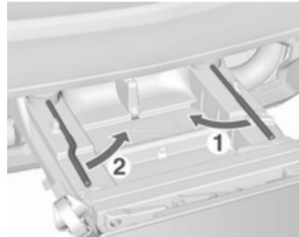
Спочатку поверніть правий затискний важіль (1), після чого поверніть лівий затискний важіль (2), доки не відчуєте спротив.
