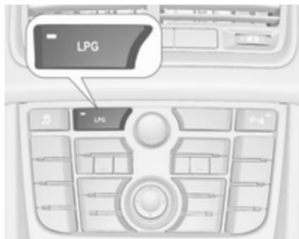
Після натиснення кнопки LPG автомобіль перемкнеться з бензину на скраплений газ одразу ж після досягнення необхідних
