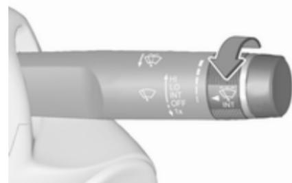
Поверніть колесо регулятора, щоб відрегулювати чутливість:
