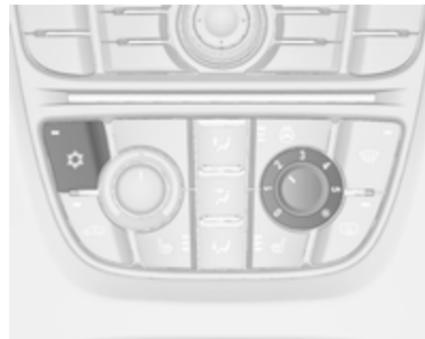
Натисніть , щоб переключити на охолодження. На активований стан указує індикатор у кнопці. Охолодження працює лише під час роботи двигуна та вентилятора системи клімат-контролю.
