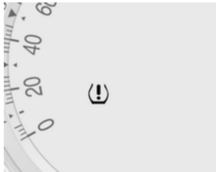
Розпізнавання стану тиску в шинах позначається контрольним індикатором (!)  $\diamond$  109.
