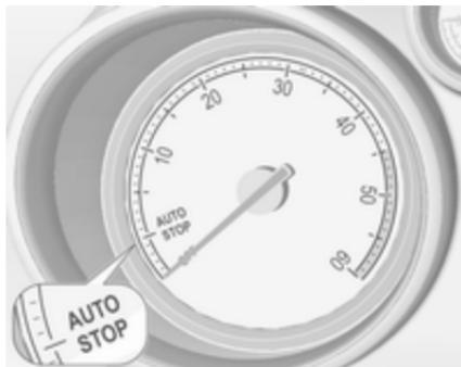
Функція Автостоп позначається стрілкою у положенні **AUTOSTOP** на тахометрі.
