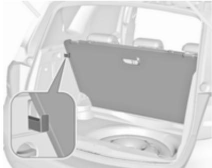
Знімна кришка полика в задній частині автомобіля піднімається.
