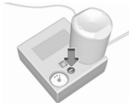
Якщо протягом 10 хвилин вказаного рівня тиску не досягнуто, вийміть комплект для ремонту шин. Пересуньте автомобіль на один оберт шини. Повторно під'єднайте комплект для ремонту шин і продовжуйте
