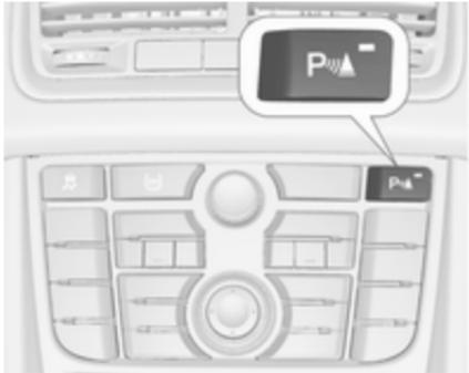
Коли ввімкнено задню передачу, передня та задня система допомоги під час паркування готові до роботи.
