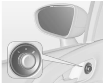
Виберіть потрібне зовнішнє дзеркало та відрегулюйте його. Випуклі зовнішні дзеркала  $\diamond$  32, електричне регулювання  $\diamond$  32, зовнішні дзеркала, що складаються  $\diamond$  32, зовнішні дзеркала з підігрівом  $\diamond$  32.
