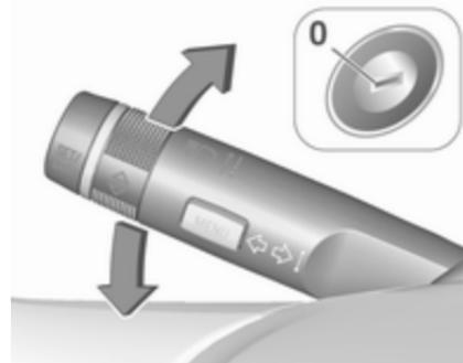
Під час паркування автомобіля можна ввімкнути ліхтарі стоянкового освітлення з одного боку:
