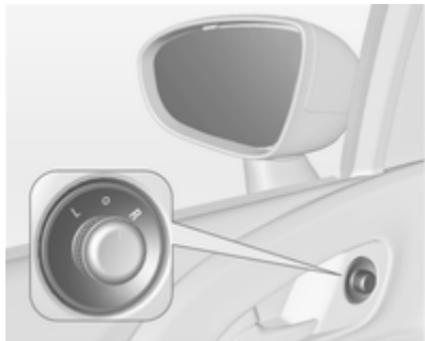
Виберіть потрібне зовнішнє дзеркало, повернувши регулятор уліво (L) чи вправо (R). Потім поверніть регулятор, щоб відрегулювати дзеркало.
