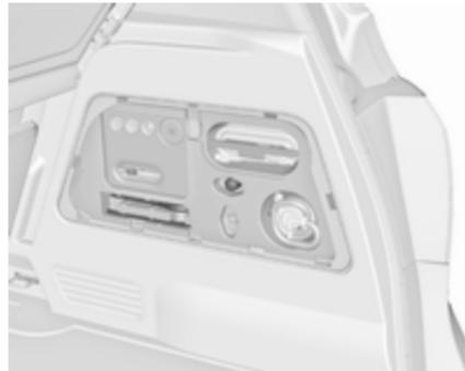
Варіант 1: набір інструментів зберігається в правому відділенні багажника разом із комплектом для ремонту шин.
