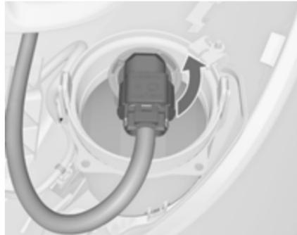
1. Поверніть тримач лампи проти годинникової стрілки та вийміть його з рефлектора.
