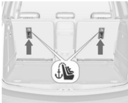
Установивши систему ISOFIX, закріпіть ремінь Top-tether в отворах для кріплення Top-tether. Ремінь має проходити між двома направляючими валиками підголівника.
