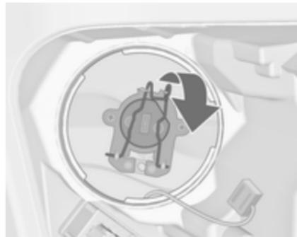
3. Від'єднайте пружинний затискач, після чого поверніть його назад.
