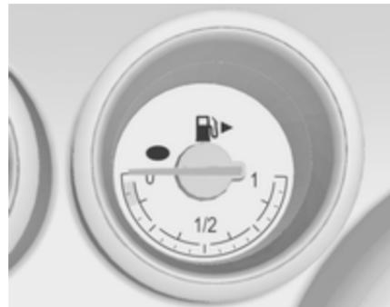
Показує рівень пального в баку чи газовому балоні (залежно від режиму роботи).
