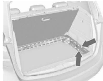
Якщо кришку закріплено у верхніх отворах, простір між нею та кришкою ніші для запасного колеса можна використовувати як відділення для зберігання.
