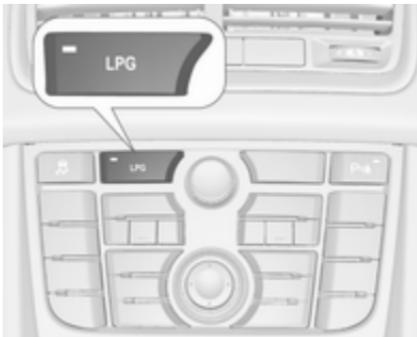
Кнопкою LPG можна перемінитися з режиму роботи на бензині на режим роботи на скрапленому газі. Світлодіодний індикатор ● позначає поточний режим роботи.
