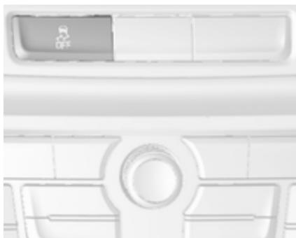
Для максимально розкуютого водіння систему ESC можна дезактивувати: утримуйте кнопку натиснутою протягом, приблизно, 5 секунд.
