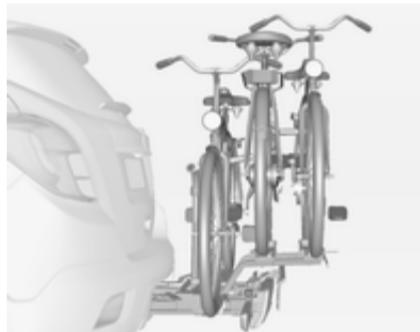
Задня система кріплення багажу (система Flex-Fix) дозволяє закріплювати один велосипед на витяжному тримачі, інтегрованому в полик автомобіля. Можна закріплювати ще два велосипеди на адаптері. Перевезення інших речей заборонено.
