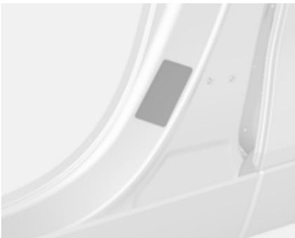
Тиск у шинах  $\diamond$  231 і на ярлику, розташованому на дверній рамі дверцят водія.
