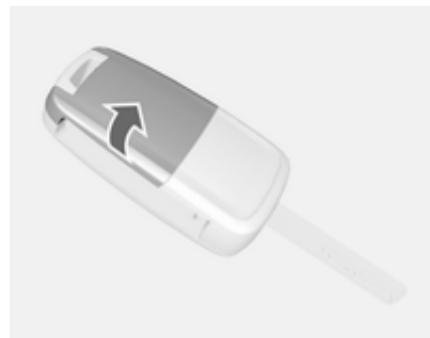
Розкладіть ключ і відчиніть блок. Замініть батарею (тип батареї CR 2032), беручи до уваги її положення під час установлення. Зачиніть блок і здійсніть синхронізацію.
