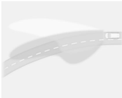
Пучок світла повертається відповідно до кута керма та швидкості, покращуючи освітлення на поворотах.
