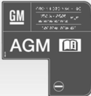
Акумулятор AGM можна розпізнати по ярлику на акумуляторі. Ми рекомендуємо використовувати фірмовий автомобільний акумулятор Opel.
