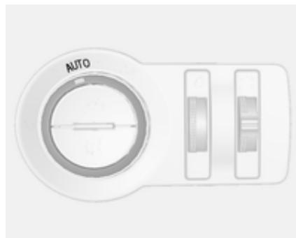
Коли функцію автоматичного керування освітленням із запущеним двигуном увімкнено, система залежно від умов освітлення відповідно автоматично вмикає режим освітлення при денному світлі або ж ближнє світло фар.
