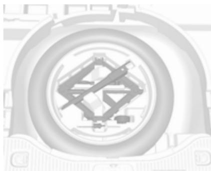
Домкрат та інструменти зберігаються в багажному відділенні над запасним колесом. Заміна колеса  $\diamond$  205, запасне колесо  $\diamond$  208.
