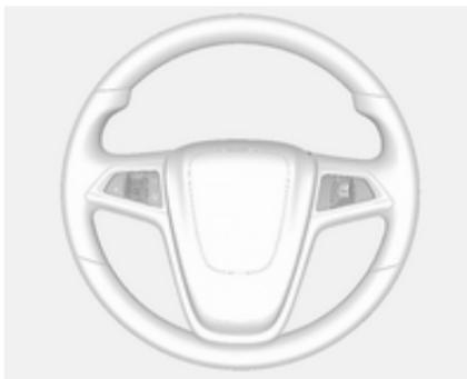
За допомогою елементів на кермі можна керувати інформаційно-розважальною системою та круїз-контролем.
