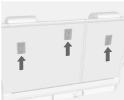
Для систем безпеки, окрім ISOFIX, закріпіть ремінець Top-Tether до отворів кріплення Top-Tether. Пасок повинен проходити між двома направляючими валиками підголівника.
