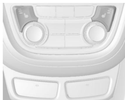
Відрегулюйте підігрів до потрібного параметра натисканням кнопки для відповідного сидіння один або декілька разів. Контрольний індикатор у кнопці вказує параметр. Людям із чутливою шкірою не рекомендується використовувати найвищий рівень підігріву протягом тривалого періоду.
