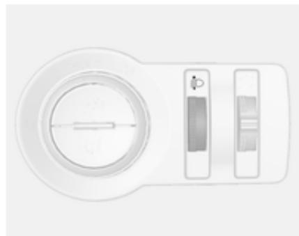
Щоб адаптувати діапазон освітлення фарами до навантаження автомобіля для запобігання засліпленню: поверніть колесо регулятора
