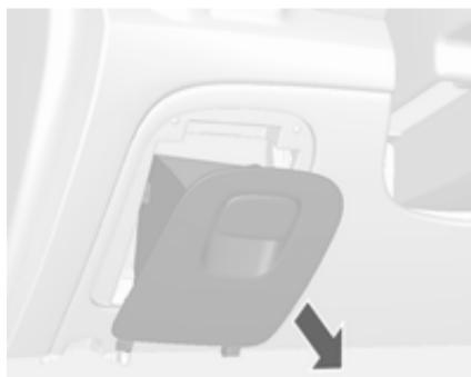
Внутрішній блок запобіжників знаходитьться під панеллю приладів з боку водія.
