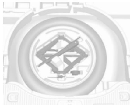
Домкрат та інструменти зберігаються в багажному відділенні над запасним колесом. Заміна колеса  $\Rightarrow$  214, запасне колесо  $\Rightarrow$  216.
