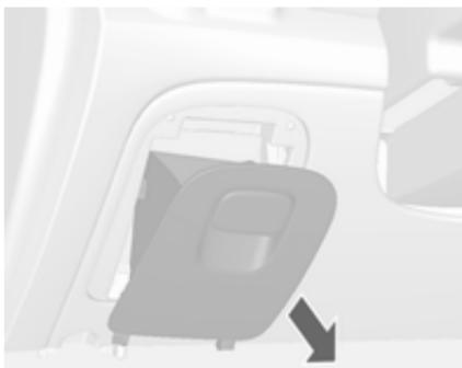
Внутрішній блок запобіжників знаходитьться під панеллю приладів з боку водія.
