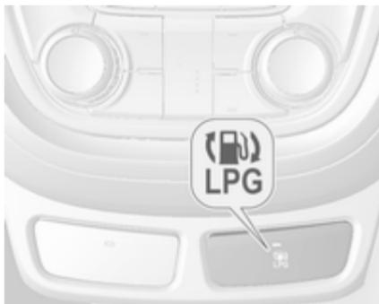
Щоб перемкнутися з бензину на скраплений газ і навпаки, натисніть **LPG**. Індикатор у кнопці показує поточний режим роботи.
