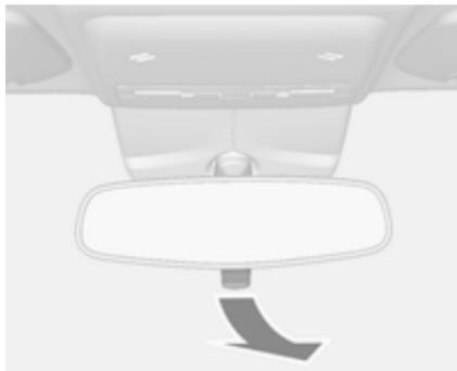
Щоб зменшити засліплювальну дію світла, поверніть важіль на зворотному боці корпусу дзеркала. Внутрішнє дзеркало  $\diamond 32$ , внутрішнє дзеркало із системою автоматичного зменшення засліплюючої дії світла  $\diamond 32$ .
