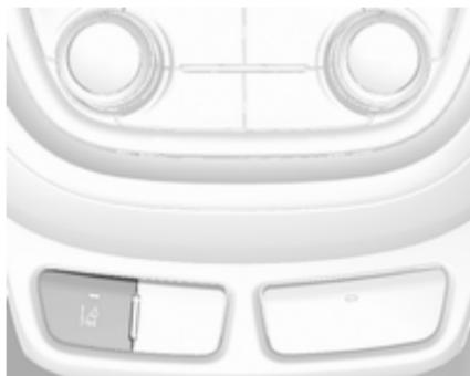
Система попередження про виїзд за межі смуги вмикається кнопкою . На активований стан системи вказує ввімкнений індикатор у кнопці. Якщо контрольний індикатор на панелі приладів горить зеленим, система готова до роботи.
