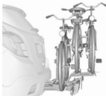
Задня система кріплення багажу (система Flex-Fix) дозволяє закріплювати один велосипед на витяжному тримачі, інтегрованому в полик автомобіля. Можна закріплювати ще два велосипеди на адаптері. Перевезення інших речей заборонено.
