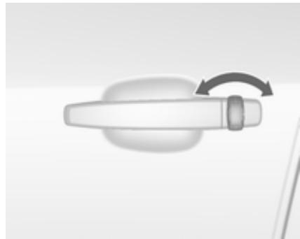
Розблокуйте вручну водійські дверцята за допомогою ключа. Увімкніть запалювання й натисніть щоб відімкнути інші дверцята, багажне відділення та кришку горловини паливного бака. Система захисту автомобіля від викрадення вимикається при ввімкненні запалювання.
