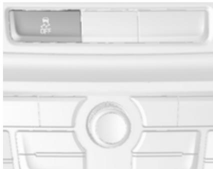
Протибукусувальну гальмівну систему (ТС) можна вимикати, коли необхідна прокрутка ведучих коліс:
