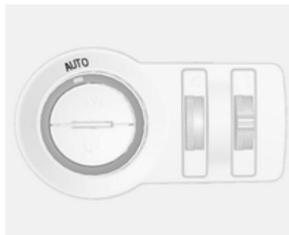
Коли функцію автоматичного керування освітленням із запущеним двигуном увімкнено, система залежно від умов освітлення відповідно автоматично включає режим освітлення при денному світлі або ж близьке світло фар.
