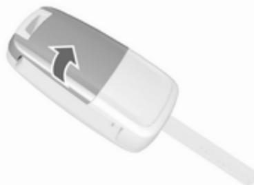
Розкладіть ключ і відчиніть блок. Замініть батарею (тип батареї CR 2032), беручи до уваги її положення під час установлення. Зачиніть блок і здійсніть синхронізацію.
