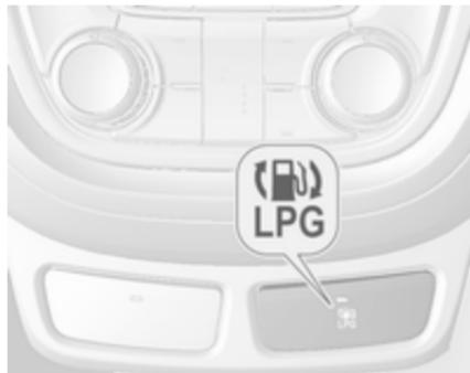
Після натиснення кнопки **LPG** автомобіль перемкнеться з бензину на скраплений газ одразу
