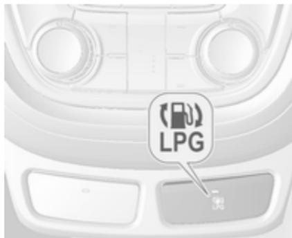
Щоб переключитися з бензину на скраплений газ і навпаки, натисніть **LPG**. Індикатор у кнопці показує поточний режим роботи.
