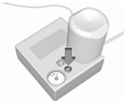
Якщо протягом десяти хвилин вказаного рівня тиску не досягнуто, зніміть набір для ремонту шин. Пересуньте автомобіль на один оберт шини. Повторно під'єднайте набір для ремонту шин і продовжуйте процедуру заповнення протягом 10 хвилин. Якщо вказаний тиск у шинах все ще не вдається отримати, це свідчить про серйозне пошкодження шини. Зверніться по допомогу до майстерні.
