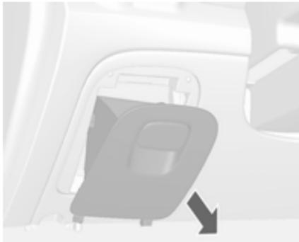
Внутрішній блок запобіжників знаходиться під панеллю приладів з боку водія.
