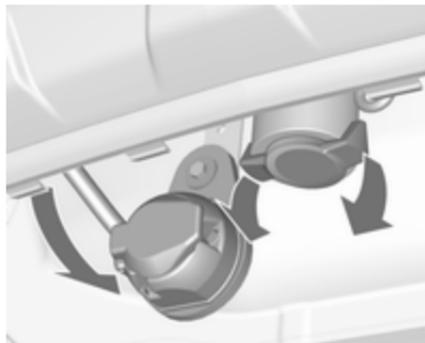
Відключіть та складіть розетку. Вийміть заглушку з отвору для зчіпного пристрою (фаркопа) та покладіть у місце для її зберігання.
