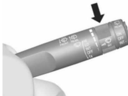
Поверніть колесо регулятора, щоб відрегулювати чутливість:
