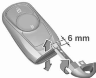
2. Щоб відкрити корпус, вставте в нього лезо ключа приблизно на 6 мм і поверніть ключ. Якщо вставити лезо ключа глибше, можна пошкодити корпус.
