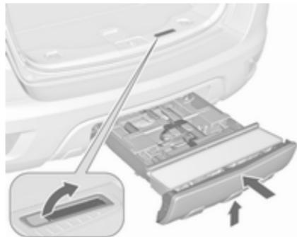
Підніміть важіль розблокування та утримуйте його в такому положенні. Злегка підніміть систему і посуньте її в бампер до фіксації.
