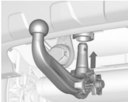
Вставте натягнутий зчіпний пристрій (фаркоп) в отвір та натисніть вгору до звуку фіксації. Поворотний затискач повернеться в початкове положення, залишаючись навпроти зчіпного пристрою без зазору.
