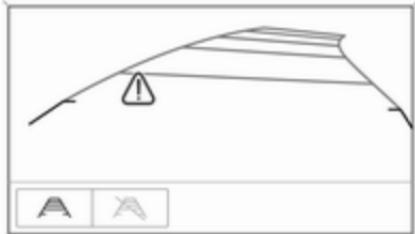
Кольоровий інформаційний дисплей 7": відображення попереджувальних символів та напрямних можна вмикати й вимикати за допомогою сенсорних кнопок у нижній частині дисплея.
