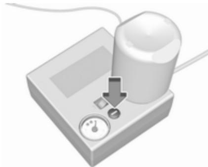
Якщо протягом десяти хвилин вказаного рівня тиску не досягнуто, зніміть набір для ремонту шин. Пересуньте автомобіль на один оберт шини. Повторно під'єднайте набір для ремонту шин і продовжуйте
