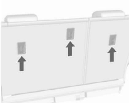
Для систем безпеки, окрім ISOFIX, закріпіть ремінець Top-Tether до отворів кріплення Top-Tether. Пасок повинен проходити між двома напрямними валиками підголівника.
