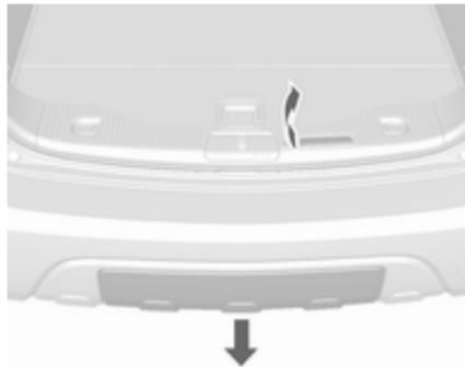
Потягніть важіль відпускання вгору. Задня система кріплення розблоковується та швидко виїжджає з заднього бампера.
