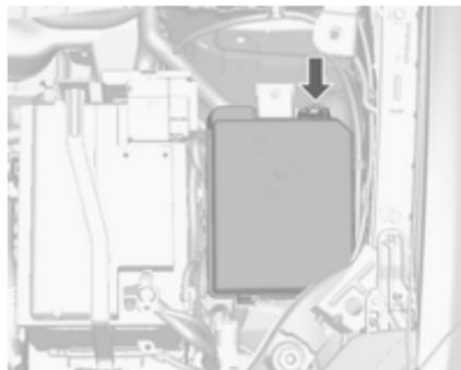
Блок запобіжників у моторному відсіку.
