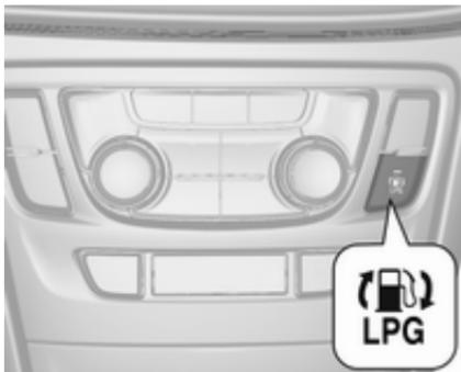
Після натиснення кнопки LPG автомобіль перемкнеться з бензину на скраплений газ одразу ж після досягнення необхідних параметрів (температура охолоджувальної рідини, температура газу та мінімальна частота обертів двигуна). Ці параметри зазвичай досягаються приблизно через 60 с після першого активного натискання на педаль акселератора (залежно від температури повітря). Світлодіодний індикатор стану вказує на поточний режим роботи.
