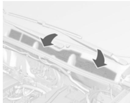
Слідкуйте за чистотою повітрозабірника, розташованого перед лобовим склом у моторному відділенні, щоб забезпечити вільний прохід повітря.
