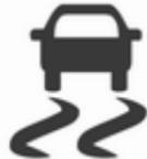
Система TC готова до роботи після кожного запуску двигуна, щойно контрольний індикатор  $\text{X}$  погасне.
