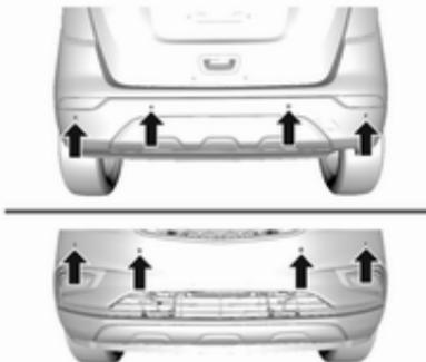
Система допомоги під час паркування полегшує процес паркування, вимірюючи відстань між автомобілем і перешкодами та відтворюючи звуковий сигнал. Проте за виконувані маневри під час паркування відповідає лише водій.
