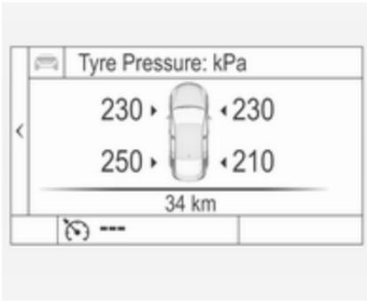
6. Натисніть **SET/CLR**, щоб почати процес синхронізації датчиків. Після цього повинен з'явитися запит на підтвердження запуску процедури.
