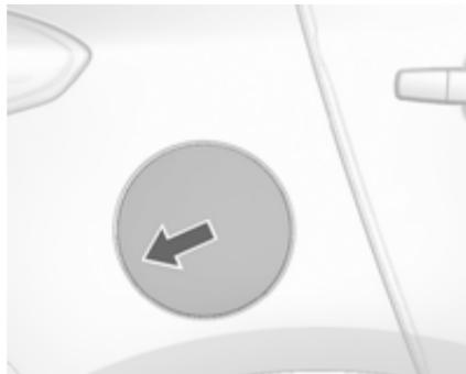
Кришку горловини паливного баку можна відчинити лише, якщо автомобіль розблоковано. Натисніть на клапан і відкрийте його.
