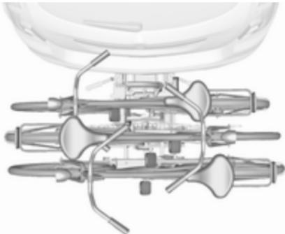
3. Розташуйте велосипеди на задній системі кріплення у шаховому порядку (рулем ліворуч - рулем праворуч).
