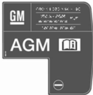
Акумулятор AGM можна розпізнати по ярлику на акумуляторі. Ми рекомендуюмо використовувати фірмовий автомобільний акумулятор Opel.
