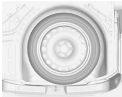
Запасне колесо розташоване в багажному відділенні під покриттям поліка. Воно закріплене на місці крильчаткою гайкою.
