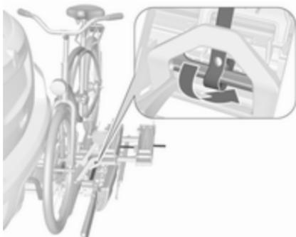
4. Проведіть ремінь, закріплений до адаптера, під важелем під час складання задньої системи кріплення назад. Закріпіть ремінь.
