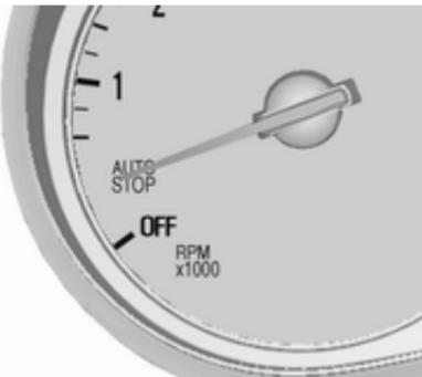
Функція Автостоп позначається стрілкою у положенні **AUTOSTOP** на тахометрі.
