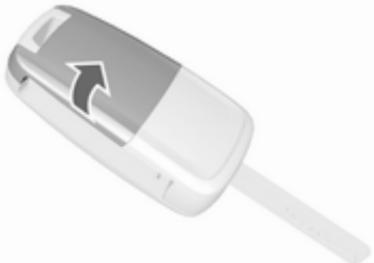
Розкладіть ключ і відчиніть блок. Замініть батарею (тип батареї CR 2032), беручи до уваги її положення під час установлення. Зачиніть блок і здійсніть синхронізацію.
