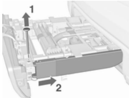
Щоб встановити задні ліхтарі, вийміть обидві шпильки (1). Потягніть задні ліхтарі з тримача до себе (2) і донизу, а потім поверніть їх убік.
