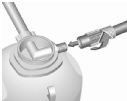
4. Прикрутіть повітропровід компресора до з'єднання на контейнері з герметиком.
