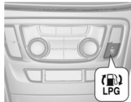
Після натиснення кнопки **LPG** автомобіль перемкнеться з бензину на скраплений газ одразу ж після досягнення необхідних параметрів (температура
