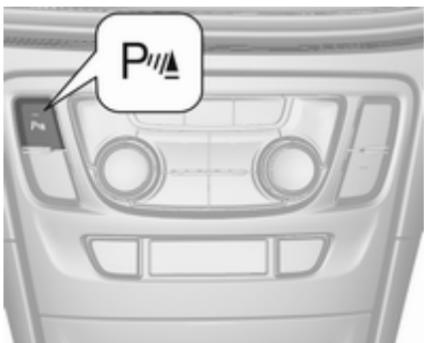
Після ввімкнення запалювання вмикається система допомоги під час паркування заднім ходом.
