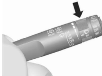
Поверніть колесо регулятора, щоб відрегулювати чутливість:
