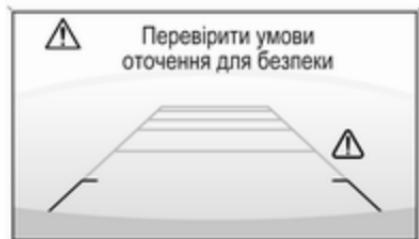
Завдяки високому розташуванню камери, задній бампер також видно на дисплей, що допомагає скерувати автомобіль в потрібне місце.
