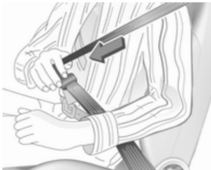
Витягніть пасок із переднатягувача, протягніть його через тіло та вставте язичок защіпки в пряжку.
