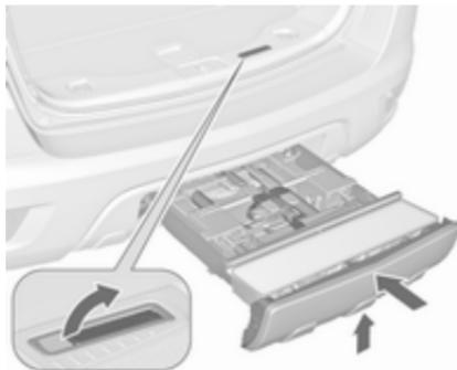
Підніміть важіль розблокування та утримуйте його в такому положенні. Злегка підніміть систему і посуньте її в бампер до фіксації.
