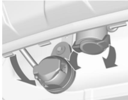
Відключіть та складіть розетку. Вийміть заглушку з отвору для зчіпного пристрою (фаркопа) та покладіть у місце для її зберігання.
