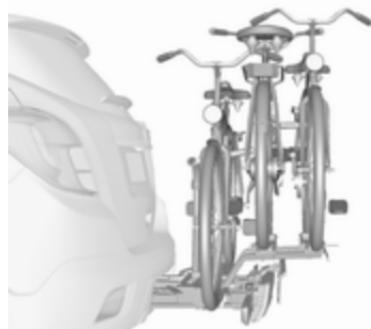
Задня система кріплення багажу (система Flex-Fix) дозволяє закріпити один велосипед на висувному тримачі, об'єднаному з підлогою автомобіля. Можна закріплювати ще два велосипеди на адаптері. Перевезення інших речей заборонено.
