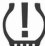
Розпізнавання стану тиску в шинах позначається контрольним індикатором  $\text{!} \diamond 104$ .
