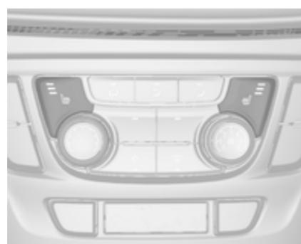
Відрегулюйте підігрів до потрібного значення, натиснувши кнопку для відповідного сидіння один або кілька разів. Вибране налаштування відображається індикатором у кнопці.
