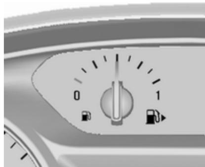
Показує рівень пального в баку чи газовому балоні (залежно від режиму роботи).
