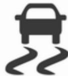
Система ESC готова до роботи після кожного запуску двигуна, щойно контрольний індикатор
