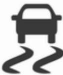
Система ТС готова до роботи після кожного запуску двигуна, щойно контрольний індикатор погасне.
