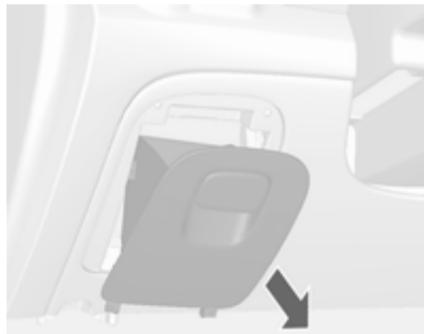
В автомобілях із лівостороннім кермом внутрішній блок запобіжників знаходиться під панеллю приладів з боку водія.
