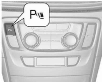
Після ввімкнення запалювання вмикається система допомоги під час паркування заднім ходом. На невеликій швидкості передню систему допомоги під час паркування можна також активувати, натиснувши **P**▲.
