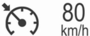
Наберіть потрібну швидкість і поверніть колесо регулятора в положення **SET/-**: поточна швидкість зберігається та підтримується. Контрольний індикатор на панелі приладів засвічується зеленим кольором. На дисплеї вищого рівня колір значка змінюється на зелений і
