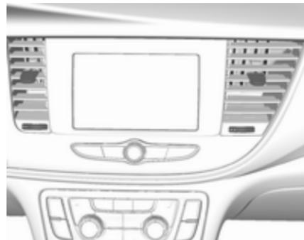
Щоб відкрити повітропровід, поверніть колесо регулятора вправо. Відрегулюйте потік повітря, що надходить через повітропровід, повертаючи колесо регулятора в потрібне положення.
