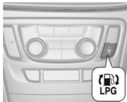
Після натиснення кнопки **LPG** автомобіль перемкнеться з бензину на скраплений газ одразу ж після досягнення необхідних параметрів (температура
