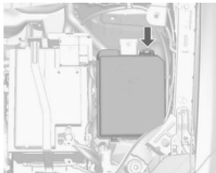
Блок запобіжників у моторному відсіку.
