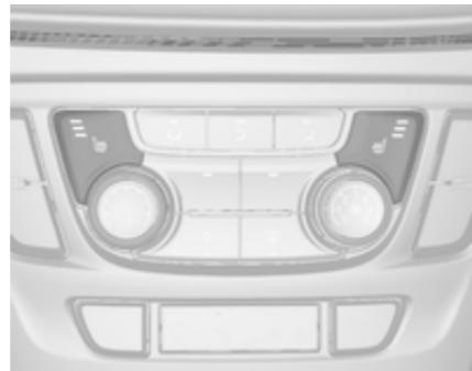
Відрегулюйте підігрів до потрібного значення, натиснувши кнопку для відповідного сидіння один або кілька разів. Вибране налаштування відображається індикатором у кнопці.
