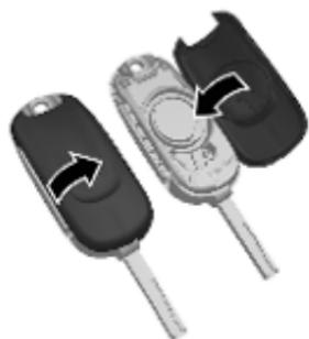
Відкрийте пристрій. Замініть батарею (тип батареї CR 2032), беручи до уваги її положення під час установлення. Зачиніть блок і здійсніть синхронізацію.
