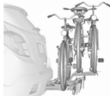
Задня система кріплення багажу (система Flex-Fix) дозволяє закріпiti один велосипед на висувному тримачі, об'єднаному з підлогою автомобіля. Можна закріплювати ще два велосипеди на адаптері. Перевезення інших речей заборонено.
