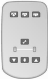
Коли необхідний збільшений дорожній просвіт чи покращений доступ до автомобіля, підвіску можна підняти чи опустити дистанційним керуванням (ДК).
