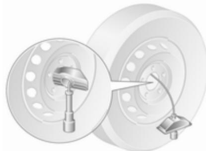
Розмістіть колесо вертикально, від'єднайте фіксатор від диска, а потім від'єднайте колесо від тросу та з'єднаного з ним фіксатора, пропустивши ці деталі через центр колеса.
