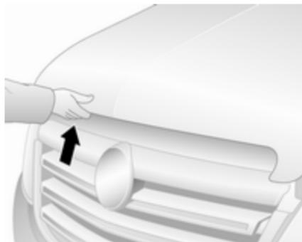
Потягніть за запобіжний фіксатор, розташований трохи лівіше від центра і відкрийте капот.
