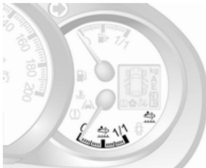
Поточний залишок рідини показується датчиком рівня рідини AdBlue  $\diamond 89$ .
