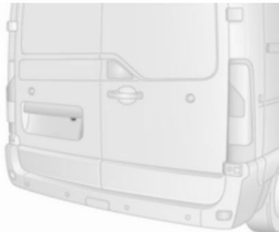
Камера зазвичай встановлюється на задніх дверях/дверях багажного відділення під молдингом номерного знака.
