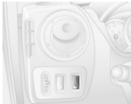
На дорозі з м'яким покриттям, багнюкою чи сніgom для поліпшення зчеплення коліс із дорогою систему ESP®<sup>Plus</sup> можна вимкнути:
