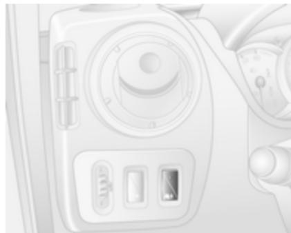
На дорозі з м'яким покриттям, багнюкою чи снігом для поліпшення зчеплення коліс із дорогою протибуксувальну гальмівну систему (TC) можна вимкнути:
