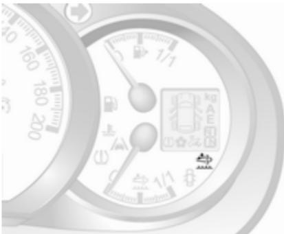
Коли датчик рівня рідини AdBlue показує низький рівень, контрольний індикатор спочатку світиться постійно, а потім після зниження рівня рідини AdBlue до певного значення блимає протягом кількох секунд, після чого світиться постійно.
