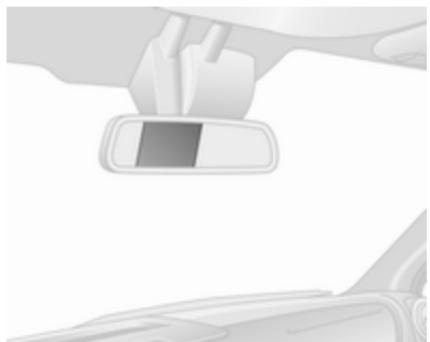
Дисплей камери заднього огляду вмикається автоматично після ввімкнення задньої передачі. Звуковий сигнал підтвердить активацію.
