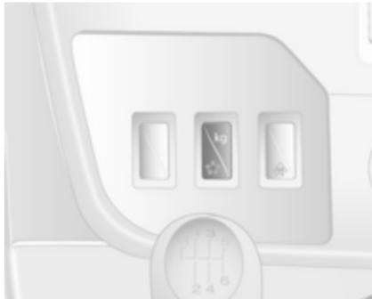
Режим високого навантаження можна використовувати як у ручному, так і в автоматичному режимах КПП. В обох випадках схеми перемикання передач автоматично адаптуються до збільшеного завантаження.
