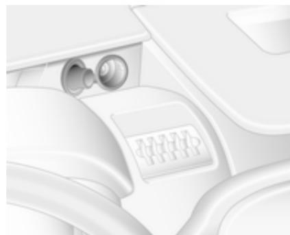
Електророзетки 12 В розташовані на приладовій панелі та у задній частині автомобіля.
