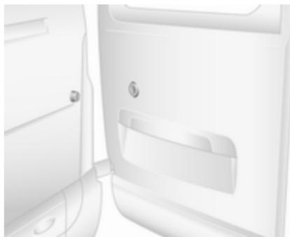
При відкритті дверцят у положення 270°, дверцята фіксуються у повністю відкритому положенні магнітами з боку кузова.
