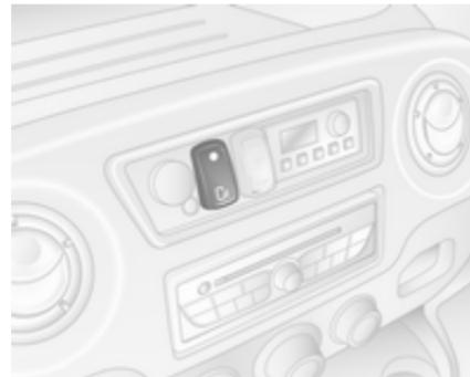
Коли автомобіль стоїть на місці й ввімкнено стоянкове гальмо, натисніть вимикач на панелі приладів, щоб автоматично відчинити зсувні двері. Під час роботи електроприводу у вимикачі блимматиме індикатор.
