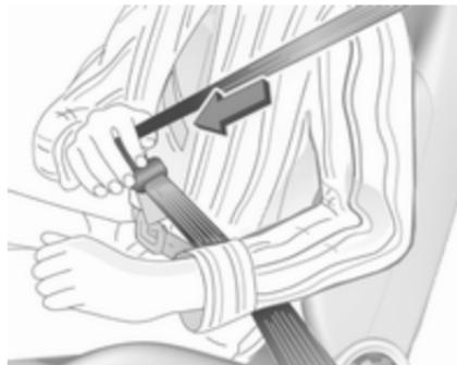
Витягніть пасок із натягувача, протягніть його через тіло та вставте язичок защіпки в пряжку. Регулярно посилюйте щільність поясного паска безпеки під час водіння, натягуючи плечовий пасок.
