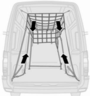
Опустіть запобіжну сітку з-під стелі та закріпіть її в отворах кріпління  $\diamond 76$ .
