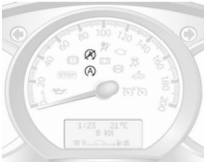
Після ввімкнення функції "Автостоп"  $\diamond$  на панелі приладів змінить колір на зелений.
