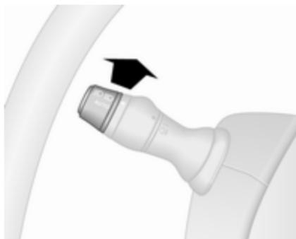
Перемкніть вимикач зовнішніх освітлювальних приладів у положення **AUTO**, а потім натисніть на важіль перемикання сигналів повороту вперед, щоб увімкнути систему керування дальнім світлом.
