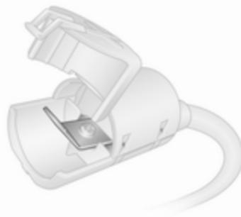
Якщо акумулятор автомобіля розрядився, за допомогою клеми для запуску від зовнішнього джерела двигун можна завести, не використовуючи акумулятор всередині автомобіля.
