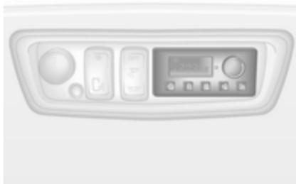
Якщо двигун вимкнений, заднє відділення можна обігрівати додатковим обігрівачем, через нижні вентиляційні отвори.
