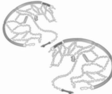
Снігові ланцюги для шин дозволяється використовувати лише на приводних колесах.
