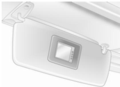
Систему можна вмикати і вимикати кнопкою Start/Stop, розташовану на правому боці монітора дисплея.
