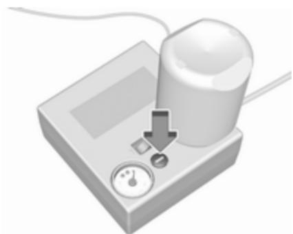
14. Вказаний рівень тиску в шинах досягається протягом 10 хвилин. Тиск у шинах  $\Phi$  247. Коли встановиться правильний тиск у шині, вимкніть компресор, перемкнувши кулісний перемикач у положення О.
