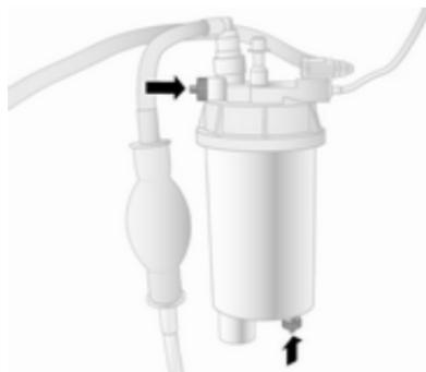
Зливайте залишкову воду з фільтра дизельного палива при кожній заміні моторного масла.
