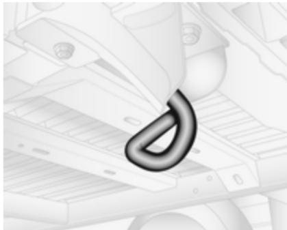
Зачепіть буксирувальний канат, а краще буксирувальний брус на задній серзі. Ніколи не чіпляйте це устаткування за задню вісь чи деталі підвіски.
