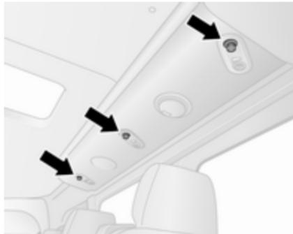
Регульовані повітропроводи можуть розміщуватися над сидіннями. Покрутивши регулятор, можна збільшити або зменшити потік повітря, спрямований на відповідне сидіння.
