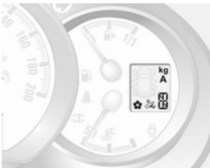
Режим чи увімкнена передача автоматизованої МКПП відображається на дисплеї КПП.
