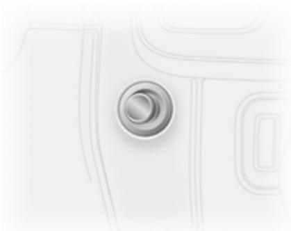
Електророзетки 12 В розташовані на приладовій панелі та у задній частині автомобіля.
