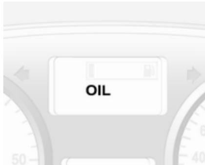
При досягненні мінімального рівня мастила у двигуні після включення запалення у центрі інформації водія протягом 30 секунд відображається повідомлення **OIL**. Перевірте рівень мастила  $\diamond 125$ .
