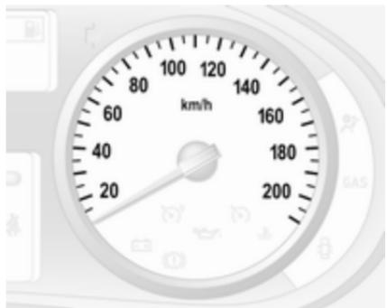
Указує швидкість автомобіля. Максимальну швидкість можна обмежити регулятором швидкості. У якості наочного повідомлення про це, на приладовій панелі розташоване відповідне попередження.
