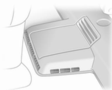
Вентилятор-обігрівач задньої частини салону автомобіля забезпечує подавання повітря у відповідну частину салону через задні повітроводи.
