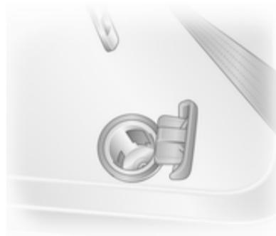
Підключення електричних аксесуарів за умови вимкненого двигуна призводить до розрядження акумулятора. Забороняється перевищувати максимальне споживання енергії в 120 Вт. Забороняється підключати будь-які аксесуари, які подають енергію, наприклад, електричні зарядні пристрої чи акумулятори.
