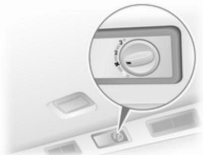
Обсяг повітря, що подається, визначається вентилятором. Температура повітря визначається регулятором на панелі приладів.
