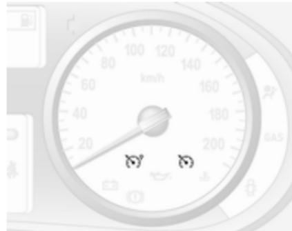
На панелі приладів зеленим світлом засвічується контрольний індикатор разом із , а в центрі інформації водія з'являється відповідне повідомлення.
