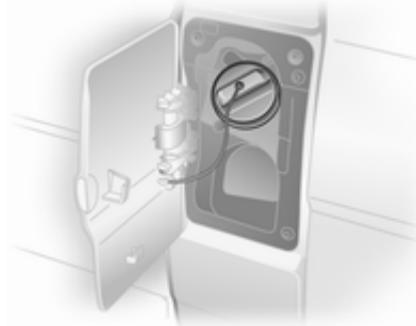
Щоб відімкнути та відкрити кришку горловини паливного баку вставте ключ та поверніть його проти годинникової стрілки. Після завершення поповнення рівню пального встановіть кришку горловини баку та поверніть ключ за годинниковою стрілкою до упору.
