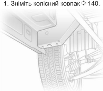
2. Відкрутіть болти кріплення колеса на півоберта кожний, використовуючи для цього ключ з храповим механізмом та перехідник. Щоб відкрутити болти, ключ з храповим
