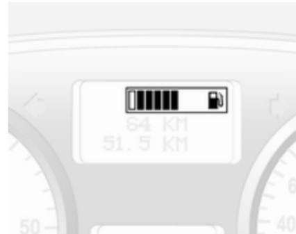
Якщо бак повний, світяться всі елементи крім елементу попередження про низький рівень палива (крайній лівий на датчику рівня пального), він при цьому залишається порожнім.
