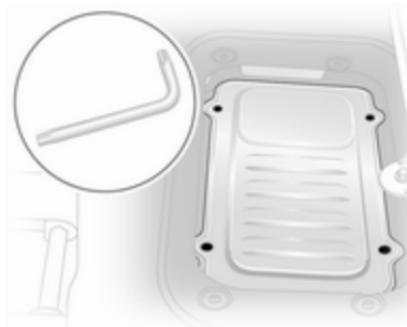
Акумулятор розміщений під нижньою передньою лівою панеллю підлоги. Підніміть покриття підлоги та відкрутіть 4 гвинта за допомогою ключа з комплекту інструментів (або комплекту для ремонту шин).
