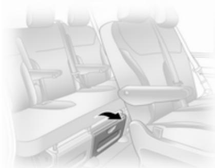
Для зберігання довгих предметів під сидіннями можна від'єднати кришку накладки центрального сидіння.
