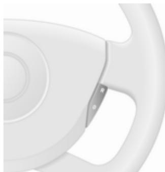
Натисніть вимикач **O**: круїз-контроль вимикається і зелений індикатор гасне на панелі приладів.
