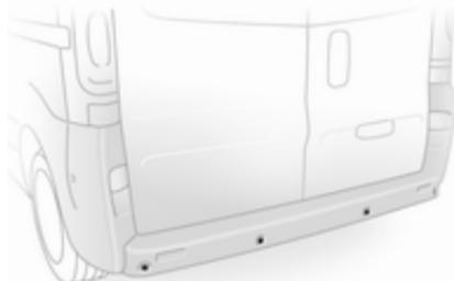
Система допомоги при паркуванні полегшує паркування заднім ходом, вимірюючи відстань між задньою частиною автомобіля і перешкодами. Проте лише водій несе повну відповідальність за паркування.
