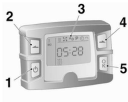
**1 Ⓛ Кнопка ввімкнення** = Вмикє та вимикає контрольний блок та змінює інформацію, що відображається
