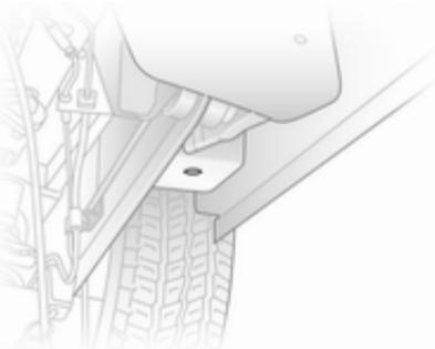
3. Підніміть автомобіль - для цього розташуйте п'яту домкрата під підйомним отвором, розташованим найближче до відповідного колеса.
