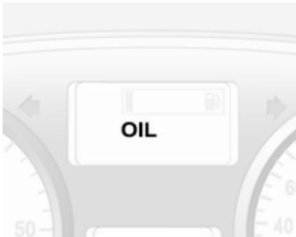
При досягненні мінімального рівня мастила у двигуні після включення запалення у центрі інформації водія протягом 30 секунд відображається повідомлення **OIL**. Перевірте рівень мастила  $\Rightarrow$  129.
