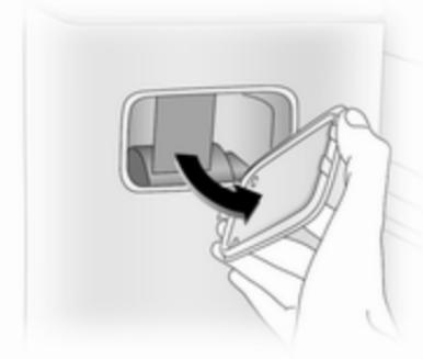
Щоб відімкнути та відкрити кришку горловини паливного баку вставте ключ та поверніть його проти годинникової стрілки. Після завершення поповнення рівню пального встановіть кришку горловини баку та поверніть ключ за годинниковою стрілкою до упору.
