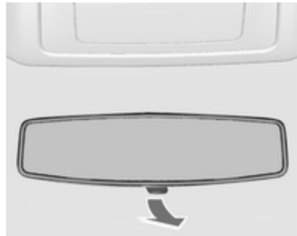
Щоб зменшити засліплювальну дію світла, поверніть важіль на зворотному боці корпусу дзеркала. Внутрішнє дзеркало заднього огляду ⇨ 31.
