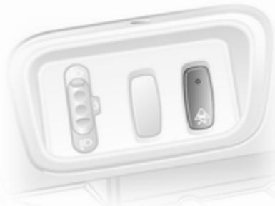
Коли пробуксовування приводних коліс необхідно, систему ESP®<sup>Plus</sup> можна вимкнути:
