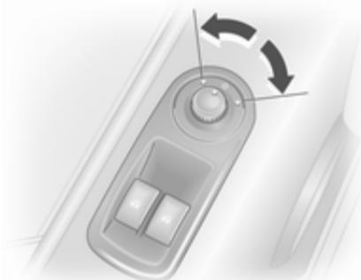
Виберіть потрібне зовнішнє дзеркало та відрегулюйте його. Випуклі зовнішні дзеркала  $\diamond$  30, електричне регулювання  $\diamond$  30, зовнішні дзеркала, що складаються  $\diamond$  31, зовнішні дзеркала з підігрівом  $\diamond$  31.
