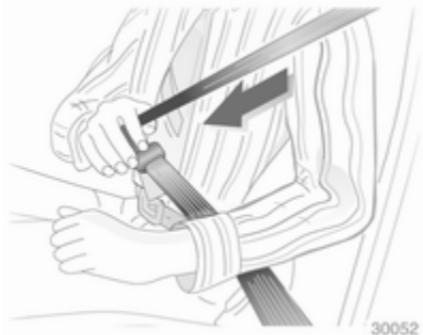
Витягніть пасок із переднаташувача, протягніть його через тіло та вставте язичок защіпки в пряжку. Регулярно посилюйте щільність поясного паска безпеки під час водіння, натягуючи плечовий пасок.
