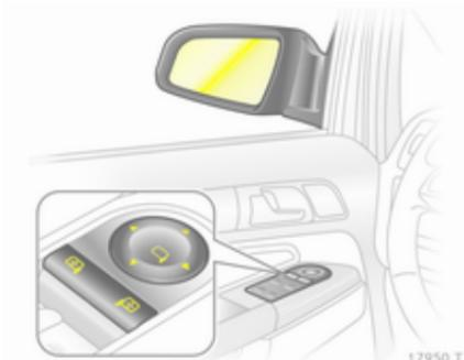
Спершу виберіть відповідне зовнішнє дзеркало, після чого поверніть регулятор, щоб відрегулювати положення дзеркала.
