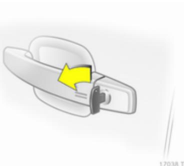
Ключ для аварійних ситуацій може блокувати та розблоковувати лише дверцята водія. Розблокування всього автомобіля  $\Phi$  35. На автомобілях із системою запобігання викраденню аварійний сигнал може пролунати, коли автомобіль розблоковується. Дезактивуйте сигналізацію, ввімкнувши запалення.
