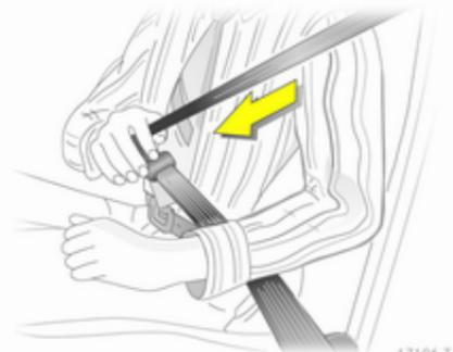
Витягніть пасок із переднатягувача, протягніть його перед собою та вставте язичок защіпки в пряжку. Регулярно посилюйте щільність прилягання поясного паска безпеки під час водіння, натягуючи його за частину, що проходить через плече.
