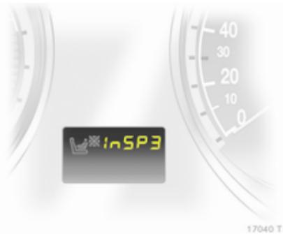
Замініть батарею, як тільки система більше не працює належним чином або діапазон її дії зменшився. Потреба в заміні акумулятора вказується InSP3 на дисплеї обслуговування чи повідомленням перевірки системи в Info-Display ⌁ 111.
