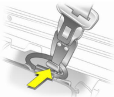
Натисніть пружинну защіпку, вийміть гачок із провушки паска в поліку автомобіля.
