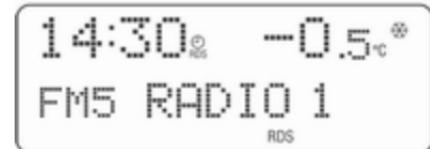
Якщо поточна вибрана станція не є станцією з послугою RDS, радіоприймач автоматично виконуватиме пошук наступної транслюваної станції з послугою RDS.
