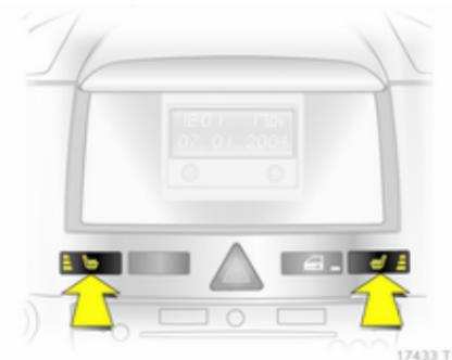
Відрегулюйте підігрів до потрібного параметра натисканням кнопки для відповідного сидіння один або кілька разів, коли ввімкнено систему запалення. Контрольний індикатор у кнопкі вказує параметр.
