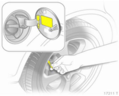
Зніміть ключ ковпачка вентиля з кришки горловини паливного баку та використайте його, щоб відкрутити ковпачок вентиля.
