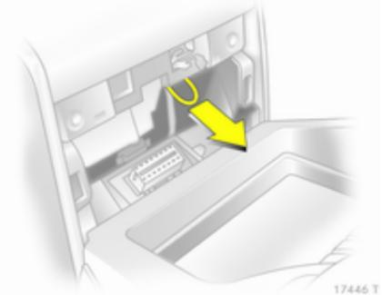
4. Потягніть за петлю та зніміть важіль селектора з положення **P** або **N**. Якщо положення **P** або **N** повторюються, важіль селектора буде знову заблоковано в положенні. Для
