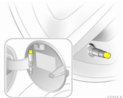
На автомобілях із системою контролю за тиском у шинах відкрутіть адаптер клапана. Тиск у шинах  $\diamond$  228 та на ярлику з внутрішнього боку кришки заливної горловини паливного баку.
