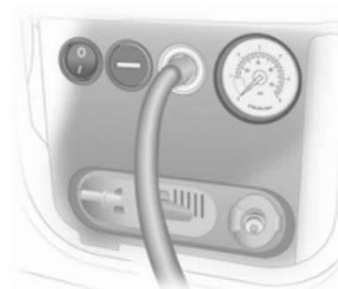
9. Увімкніть компресор шляхом натискання на вимикач on/off. Шина наповнюється ущільнювачем.
