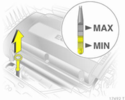
Залежно від варіанта двигуна використовуються різні щупи.
