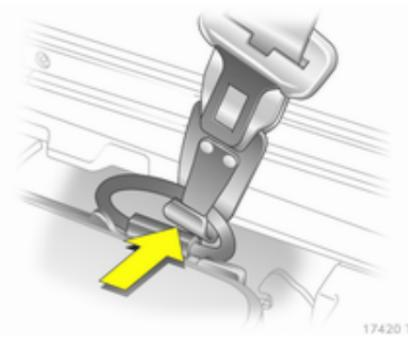
Натисніть пружинну защіпку, вийміть гачок із провушини паска в поліку автомобіля.
