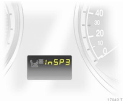
Замініть батарею, як тільки система більше не працює належним чином або діапазон її дії зменшився. Потреба в заміні акумулятора вказується InSP3 на дисплеї обслуговування чи повідомленням перевірки системи в Info-Display  $\diamond 110$ .
