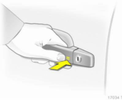
Щоб зачинити, торкніться поля датчика в ручці дверцят, доки всі вікна повністю не позачиняються. Електронний ключ має бути ззовні автомобіля в радіусі, приблизно, 1 м.
