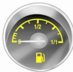
Цей датчик відображає інформацію про рівень палива або тиск газу в баку, залежно від робочого режиму.
