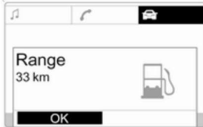
Коли рівень пального в баку стає низьким, на дисплей відображається таке повідомлення **Range** (**Пробіг без дозаправки**).
