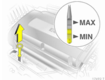
Залежно від варіанта двигуна використовуються різні щупи.
