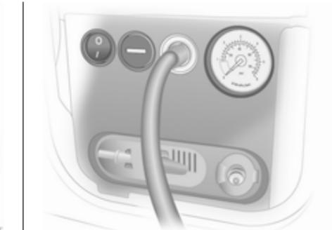
9. Увімкніть компресор шляхом натискання на вимикач on/off. Шина наповнюється ущільнювачем.
