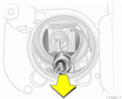
3. Вийміть тримач лампи стоянкового освітлення з рефлектора.
