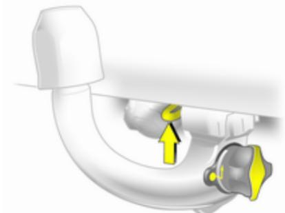
Заблокуйте штангу поверненням ключа в положення (2). Вийміть ключ і закрійте запобіжний клапан.
