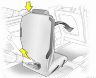
Із багажного відділення натисніть кнопку на верхній частині спинки і опустіть її. За допомогою ручки на сидінні потягніть сидіння назад і вверх, а потім посувайте його вперед, доки воно не опуститься до рівня підлоги автомобіля. Утримуйте сидіння за ручку протягом всієї процедури.
