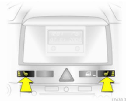
Відрегулюйте підігрів до потрібного параметра натисканням кнопки для відповідного сидіння один або кілька разів, коли ввімкнено систему запалення. Контрольний індикатор у кнопці вказує параметр.
