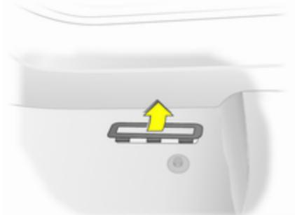
Ідентифікаційний номер автомобіля нанесено на маркувальній табличці, на днищі автомобіля та під покриттям полика, його можна побачити під покриттям.
