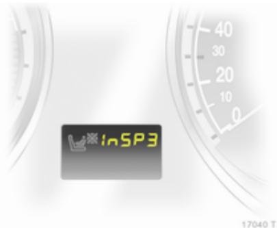
Замініть батарею, як тільки система більше не працює належним чином або діапазон її дії зменшився. Потреба в заміні акумулятора вказується InSP3 на дисплеї обслуговування чи повідомленням перевірки системи в Info-Display  $\Phi$  109.
