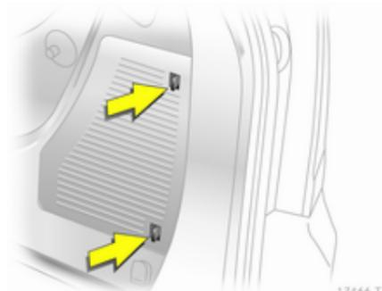
Щоб замінити лампи справа, відкрийте бокову кришку: натисніть пластини фіксатора та зніміть кришку.
