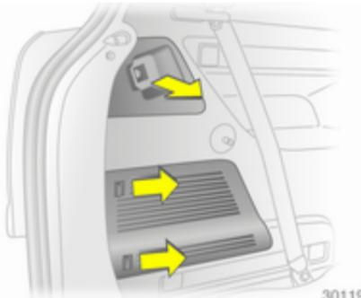
Щоб замінити лампи зліва, зніміть тримач кришки багажника і відкрийте бокову кришку: натисніть пластини фіксатора та зніміть кришку.
