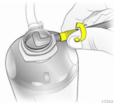
2. Відчепіть повітряний шланг від кронштейна та прикрутіть його на з'єднання пляшки з ущільнювачем.
