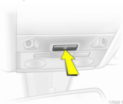
Вимикайте функцію моніторингу пасажирського відділення та нахилу автомобіля, коли в салоні автомобіля залишаються тварини. Сигналізація може спрацювати внаслідок голосних ультразвукових сигналів або рухів тварин усередині. Вимикайте цю функцію
