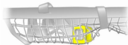
Обережно зафіксуйте стрічку Velcro навколо сітки біля регуляторів довжини. Регулятори довжини та рейки сітки повинні розташовуватися поруч на одній лінії.
