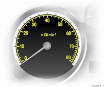
Вказує швидкість роботи двигуна. Вибирайте оптимальні оберти двигуна для кожної передачі.
