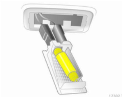
2. Легко натисніть лампу до пружинного зажиму та вийміть її.
