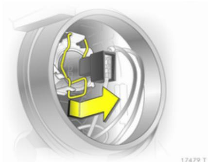
4. Зніміть пружинний зажим із фіксатора натисканням вперед, а потім поверніть його донизу.
