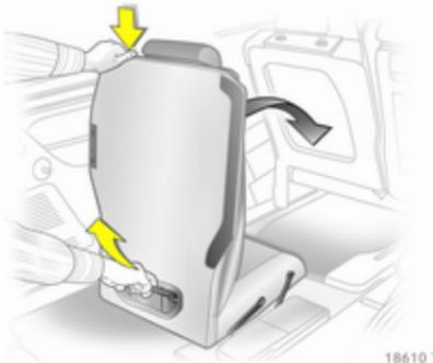
Із багажного відділення натисніть кнопку на верхній частині спинки і опустіть її. За допомогою ручки на сидінні потягніть сидіння назад і вгору, а потім посувайте його вперед, доки воно не опуститься до рівня підлоги автомобіля. Утримуйте сидіння за ручку протягом всієї процедури.
