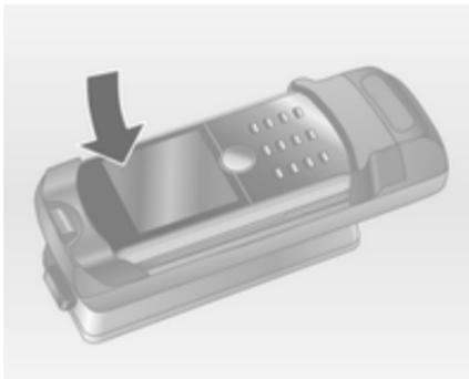
Після цього опустіть передній край. Під час закріплення мобільного телефону має пролувати характерний звук.
