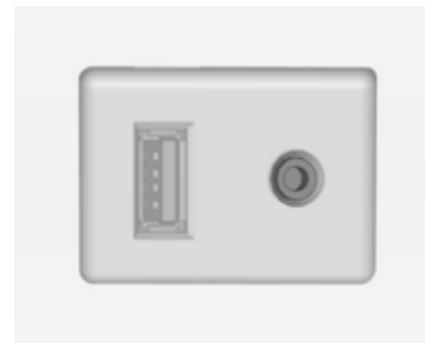
Наприклад, ви можете підключити портативний програвач CD-дисків, під'єднавши його штепсельний з'єднувач діаметром 3,5 мм до гнізда AUX.
