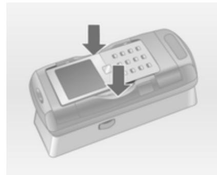
Після відкриття бокових дужок опускайте мобільний телефон в адаптер вертикально, як показано на малюнку, доки дужки не закриються.
