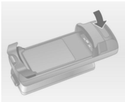
Після цього опустіть його задню частину.
