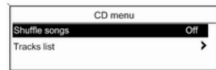
Поверніть багатофункціональний перемикач, щоб позначити функцію, яку потрібно увімкнути чи вимкнути. Натисніть багатофункціональний перемикач, щоб здійснити перехід між налаштуваннями **On (Увімкнено)** та **Off (Вимкнено)**.
