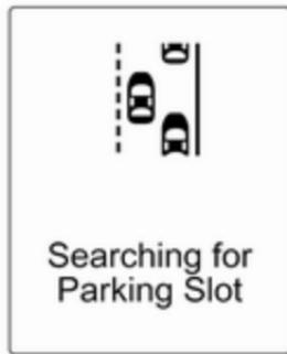
Поки автомобіль із активованою системою допомоги рухається вздовж ряду машин, розширенна система допомоги під час паркування здійснює пошук місця для парковки. При розпізнанні
