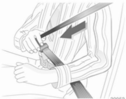
Витягніть пасок із переднатягувача, протягніть його через тіло та вставте язичок защіпки в пряжку. Регулярно посилюйте щільність поясного паска безпеки під час водіння, натягуючи плечовий пасок.
