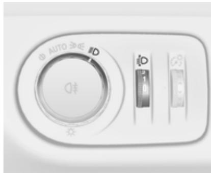
Щоб адаптувати діапазон освітлення фарами до навантаження автомобіля для запобігання засліпленню: поверніть колесо регулятора  $\text{F}$  в потрібне положення.
