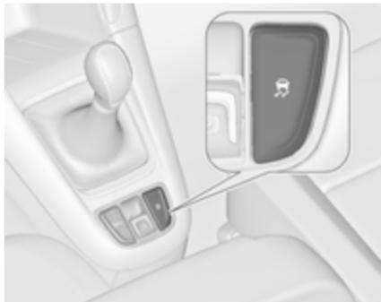
Для максимально розкучого водіння систему ESC можна дезактивувати: утримуйте кнопку
