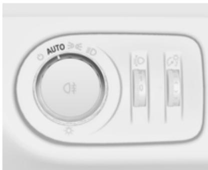
Коли функцію автоматичного керування освітленням увімкнено, а двигун працює, система автоматично змінює режим освітлення при денному світлі та режим увімкнення фар, залежно від умов освітлення та даних системи датчиків дощу.
