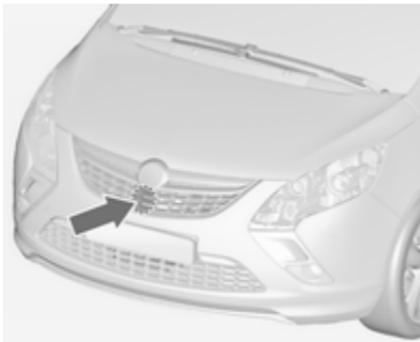
Датчик радара вмонтований позаду радіаторної решітки, нижче фірмового логотипу.
