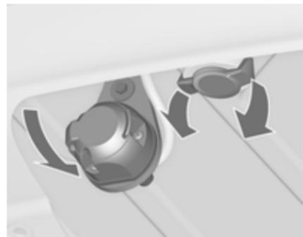
Відключіть та складіть розетку. Вийміть ущільнюючу пробку з отвору для штанги та приберіть її.
