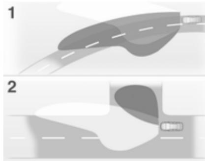
Пучок світла повертається відповідно до кута керма та швидкості, покращуючи освітлення на поворотах.
