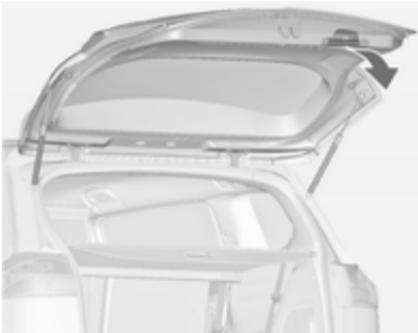
Користуйтесь внутрішньою ручкою. Не натискайте сенсорний перемикач під молдингом під час закриття дверей багажного відділення, оскільки внаслідок цього його буде знову розблоковано.
