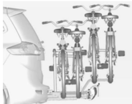
На задній системі кріплення багажу (система Flex-Fix) можна закріплювати два велосипеди на витяжному тримачі, закріпленим на підлозі автомобіля. Можна закріплювати ще два велосипеди на адаптері. Перевезення інших речей заборонено.
