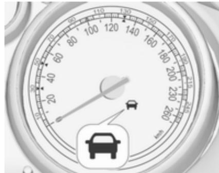
Зелений контрольний індикатор "автомобіль попереду"
