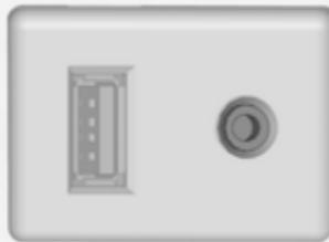
Наприклад, ви можете підключити портативний програвач CD-дисків, під'єднавши його штепсельний з'єднувач діаметром 3,5 мм до гнізда AUX.
