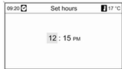
Поверніть багатофункціональний перемикач, щоб змінити поточне значення налаштування.
