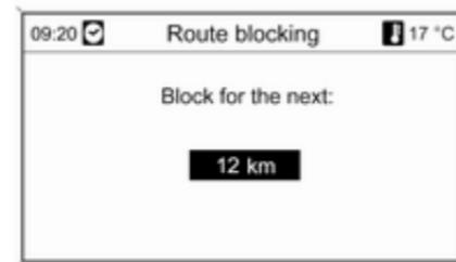
Установіть потрібну відстань, натисніть на багатофункціональний регулятор, потім підтвердіть повідомлення, що відобразиться на екрані.
