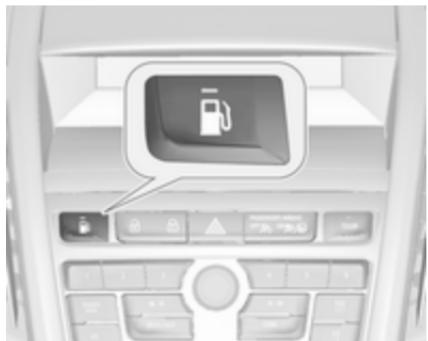
Натискання кнопки здійснює перехід між режимом роботи на бензині та режимом природного газу. Світлодіодний індикатор позначає поточний режим роботи.
