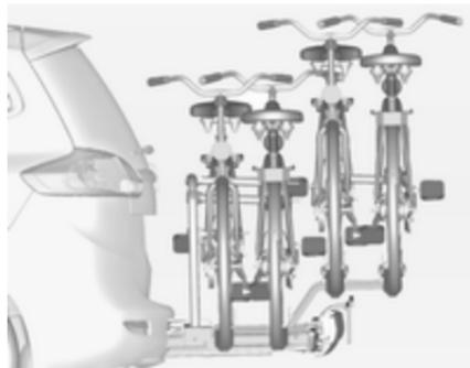
На задній системі кріплення багажу (система Flex-Fix) можна закріплювати два велосипеди на витяжному тримачі, закріплениму на підлозі автомобіля. Можна закріплювати ще два велосипеди на адаптері. Перевезення інших речей заборонено.
