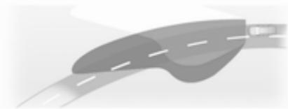
Пучок світла повертається відповідно до кута керма та швидкості, покращуючи освітлення на поворотах.
