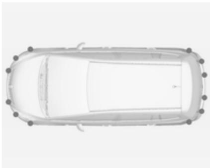
Розширення системи допомоги під час паркування відображує в центрі інформації водія інструкції та відтворює звукові сигнали, керуючись якими водій може припаркуватися в належному місці. Проте лише водій несе повну відповідальність за виконувані маневри під час паркування та остаточний вибір місця парковки, яке пропонується системою.
