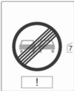
Знак окули в рамці означає виявлення додаткового сигналу, який система не може розпізнати. Система активна на швидкості до 200 км/г, залежно від умов освітлення. Максимальна швидкість, при якій система залишається активною вночі, становить 160 км/год.
