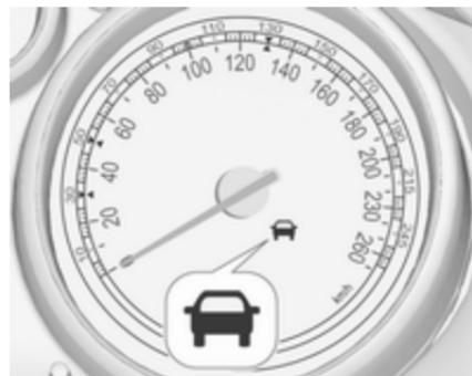
Зелений контрольний індикатор "автомобіль попереду"
