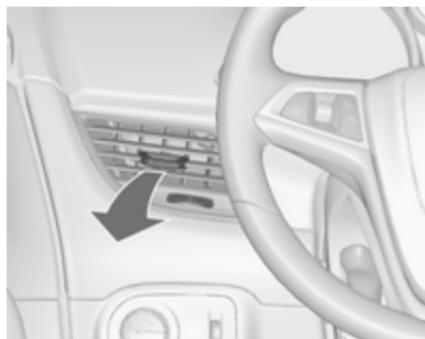
Щоб зачинити повітропровід, поверніть колесо регулятора в положення **0**.
