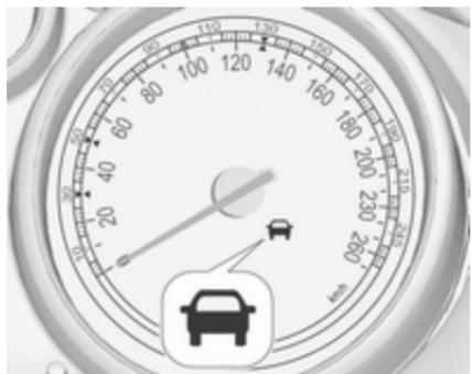
Зелений символ "автомобіль попереду" засвічується на спідометрі, коли система розпізнала автомобіль на вашому шляху. Передумовою для цього є ввімкнення функції повідомлення про небезпеку зіткнення спереду у меню персоналізації автомобіля  $\diamond 138$ , або ж те, що ця система не була потім вимкнена кнопкою (залежно від системи, див. далі).
