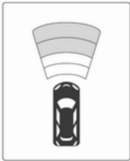
Залежно від версії, відстань до перешкоди попереду позначається у центрі інформації водія у вигляді сегментів, що змінюються.
