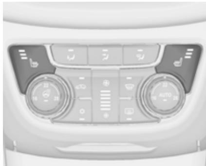
Відрегулюйте підігрів до потрібного параметра натисканням кнопки для відповідного сидіння один або декілька разів. Контрольний індикатор у кнопці вказує параметр.
