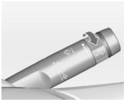
Поверніть колесо регулятора, щоб відрегулювати чутливість:
