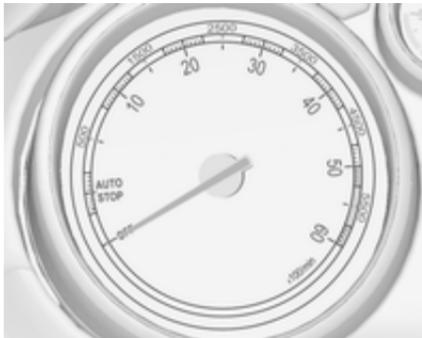
Указує швидкість роботи двигуна. Вибирайте оптимальні оберті двигуна для кожної передачі.
