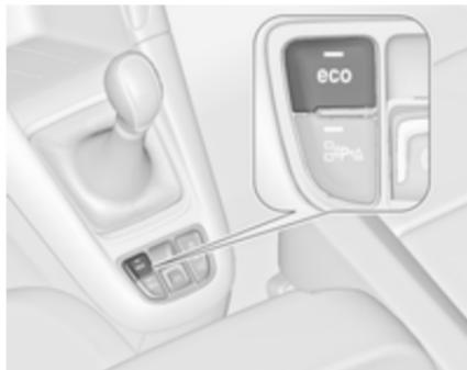
Вимкніть систему стоп-старт вручну, шляхом натискання на кнопку **eco**. Вимкнення підтверджується тим, що світлодіодний індикатор у кнопкі гасне.
