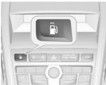
Натискання кнопки здійснює перехід між режимом роботи на бензині та режимом природного газу. Перемикання неможливе за високого навантаження (наприклад, при інтенсивному прискоренні, на повному газу). Світлодіодний індикатор позначає поточний режим роботи.
