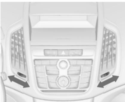
Щоб відчинити повітропровід, поверніть колесо регулятора в положення I. Відрегулюйте потік повітря, що надходить через повітропровід, повертаючи колесо регулятора в потрібне положення.
