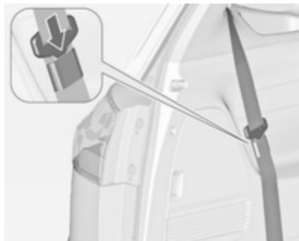
Перед роботою з кришкою багажного відділення, вставте пластину пряжки паска безпеки з кожного боку в кишеню, закріплену на паску.
