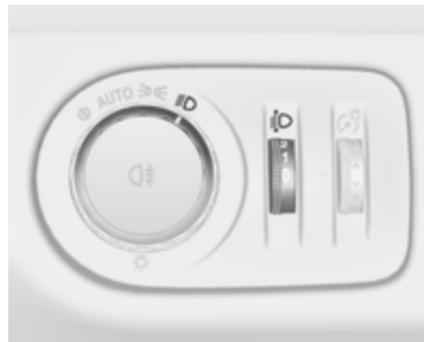
Щоб адаптувати діапазон освітлення фарами до навантаження автомобіля для запобігання засліпленню: поверніть колесо регулятора
