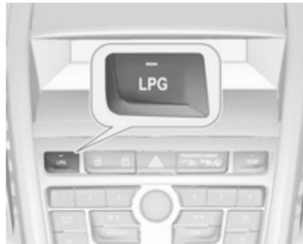
Натискайте кнопку **LPG** для переходу між режимом роботи на бензині та режимом скрапленого газу. Світлодіодний індикатор
