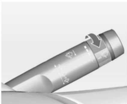
Поверніть колесо регулятора, щоб відрегулювати чутливість:
