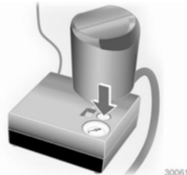
Якщо протягом 10 хвилин вказаного рівня тиску не досягнуто, вийміть набір для ремонту шин. Пересуньте автомобіль на один оберт шини. Повторно під'єднайте набір для ремонту шин і продовжуйте процедуру заповнення протягом 10 хвилин. Якщо вказаний тиск у шинах все ще не вдається отримати, це свідчить про серйозне
