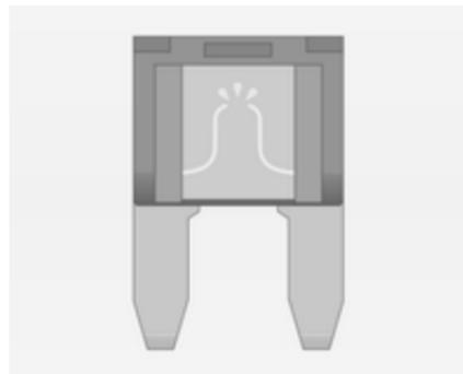
Залежно від типу запобіжника, запобіжник, що перегорів, можна розпізнати за розплавленим дротом. Не міняйте запобіжник, доки причина несправності не усунена.
