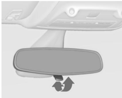
Щоб зменшити засліплювальну дію світла, поверніть важіль на зворотному боці корпусу дзеркала.
