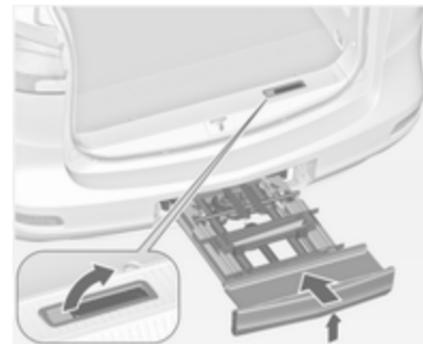
Штовхніть важіль розблокування вгору та утримуйте його в такому положенні. Злегка підніміть систему та посуňte її в бампер до фіксації.
