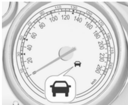
Зелений контрольний індикатор "автомобіль попереду"
