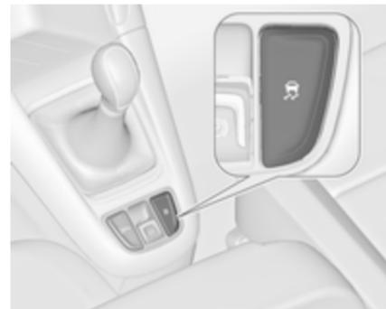
Для максимально розкутого водіння систему ESC можна дезактивувати: утримуйте кнопку
