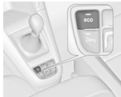
Вимкніть систему стоп-старт вручну, шляхом натискання на кнопку **eco**. На вимкнений стан вказує вимкнення індикатора в кнопці.
