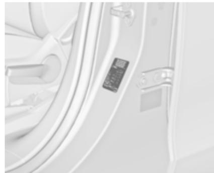
Тиск у шинах  $\varnothing$  313 і на ярлику, розташованому на дверній рамі лівих чи правих передніх дверцят.
