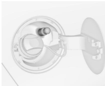
Кришку горловини паливного баку можна відчинити лише, якщо автомобіль розблоковано. Натиснувши кришку горловини паливного баку, зніміть її.
