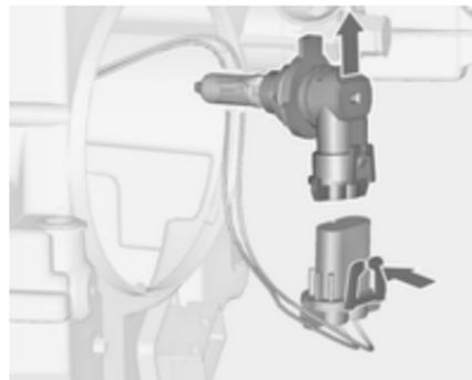
3. Від'єднайте тримач від з'єднувача, натиснувши закріплювач.
