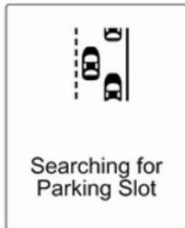
Поки автомобіль із активованою системою допомоги рухається вздовж ряду машин, розширена система допомоги під час паркування здійснює пошук місця для парковки. При розпізнанні підходящого місця надаються візуальні та акустичні сигнали у центрі інформації водія.
