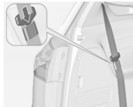
Перед роботою з кришкою багажного відділення, вставте пластину пристежки паска безпеки з кожного боку в кишеню, закріплену на паску.
