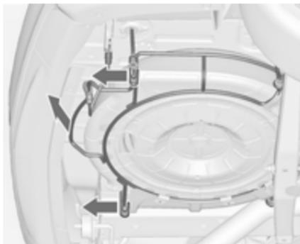
5. Підніміть тримач запасного колеса та відчепіть обидва фіксатори.
