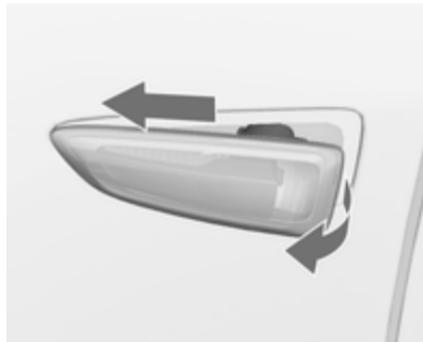
1. На лівому боці автомобіля посуňte лампу вперед і витягніть її з крила за задню частину.
