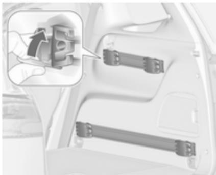
Розкладіть пластину ручки, вставте адаптер у верхній та нижній пази рейки та перемістіть у потрібне положення. Поверніть пластину вверх, щоб заблокувати адаптер. Щоб зняти пластину, поверніть її вниз і вийміть із рейки.
