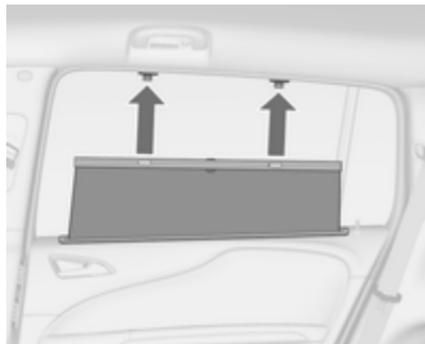
Щоб зменшити потрапляння сонячного світла на другий ряд сидінь, потягніть штору догори за допомогою ручки та зафіксуйте її у верхній частині дверної рами.
