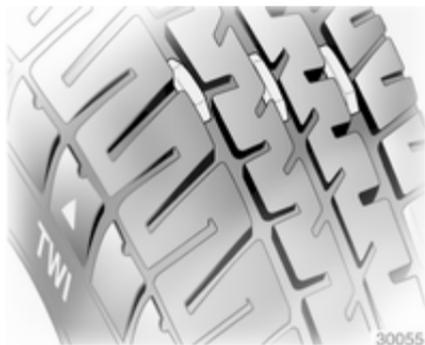
Про знос протектора свідчать показання відповідного індикатора (TWI), які вказують на досягнення протектором мінімально встановленої законодавством глибини малюнка (1,6 мм). Положення цих індикаторів узказано позначками на боковій частині.
