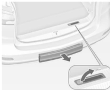
Потягніть важіль відпускання вгору. Задня система кріплення розблоковується та швидко виїжджає з заднього бампера.
