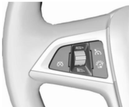
Натисніть кнопку . Круїз-контроль та адаптивний круїз-контроль мають бути увімкнені до цього, оскільки вони вимикаються при ввімкненні обмежувача швидкості, і контрольний індикатор гасне.
