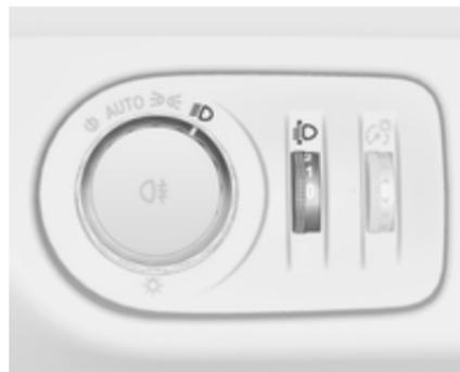
Щоб адаптувати діапазон освітлення фарами до навантаження автомобіля для запобігання засліпленню: поверніть колесо регулятора
