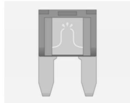
Залежно від типу запобіжника, запобіжник, що перегорів, можна розпізнати за розплавленим дротом. Не міняйте запобіжник, доки причина несправності не усунена.
