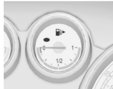
Цей датчик відображує інформацію про рівень палива або тиск газу в баку, залежно від робочого режиму.
