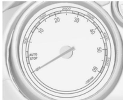
Указує швидкість роботи двигуна. Вибирайте оптимальні оберти двигуна для кожної передачі.
