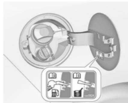
Завдяки цьому захисному пристрою кришку заливної горловини можна відкрити лише насадкою для заливання дизельного пального або лійкою для екстреного доливання пального.
