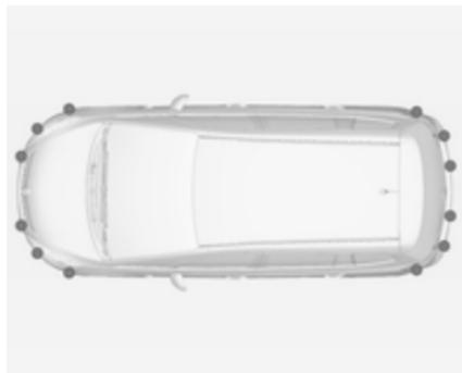
Розширена система допомоги під час паркування відображує в центрі інформації водія інструкції та відтворює звукові сигнали, керуючись якими водій може припаркуватися в належному місці.
