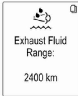
Якщо рівень рідини AdBlue впаде нижче за певне значення, в інформаційному центрі водія (DIC) відобразиться попередження про рівень для запасу ходу **Exhaust Fluid Range: (Запас рід. для очищення вихлопів) 2400 км.**
