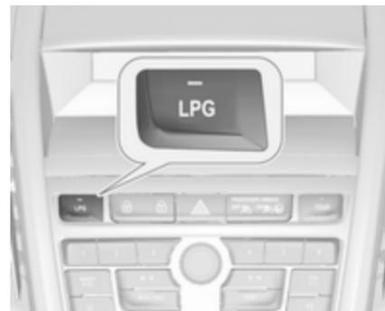
Натискайте кнопку **LPG** для переходу між режимом роботи на бензині та режимом скрапленого газу. Світлодіодний індикатор
