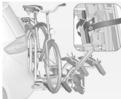
4. Складіть задню систему кріплення назад, протягнувши під важелем ремінь, прикріплений до адаптера. Закріпіть ремінь.
