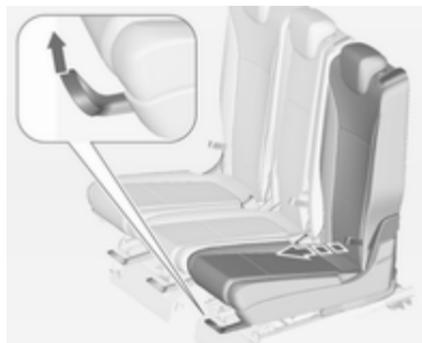
При використанні систем безпеки для дітей з кріпленнями ISOFIX на другому ряді сидінь, ми рекомендуємо відрегулювати відповідне зовнішнє крісло на третьому положенні фіксації від крайнього заднього положення (це стосується сидінь базової комплектації). Лаунж-сидіння, якщо воно встановлене, має бути у звичайному положенні ↺ 48.
