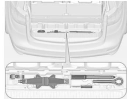
Деякі інструменти, буксирна серга та домкрат (тільки для автомобілів із запасним колесом) розташовуються у задній ніші для зберігання у підлозі багажного відділення.
