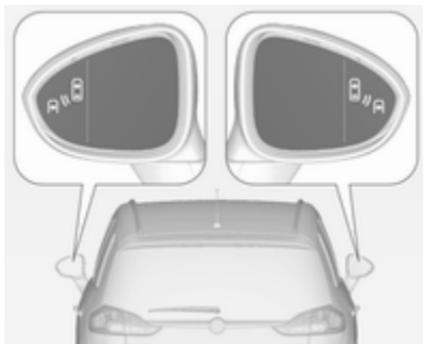
Система повідомлень бокової мертвої зони видимості діє при швидкостях від 10 км/год до 140 км/год. В разі перевищення швидкості 140 км/год система вимикається, про що свідчитиме слабе підсвічування попереджувальних символів <sup>а</sup><sub>в</sub> в обох зовнішніх дзеркалах. При зменшенні швидкості попереджувальні символи гаснуть. Якщо після цього буде розпізнаний
