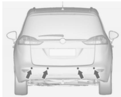
Передня і задня система допомоги під час паркування вимірює дистанцію між автомобілем і перешкодами попереду і позаду автомобіля. Система інформує водія у вигляді акустичних сигналів та повідомлень на дисплеї.
