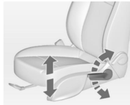
Накачування важелем угору = сидіння вище
