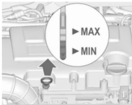
Залежно від варіанта двигуна використовуються різні щупи.
