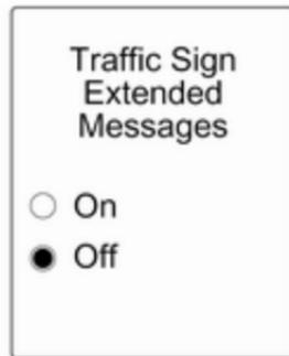
Після виведення на екран сторінку налаштувань оберіть **Off (Вимкнено)**, щоб вимкнути функцію спливних індикаторів. Вмикається повторно шляхом обрання **On (Увімк.)**. При увімкненні запалення спливна функція вмикається.
