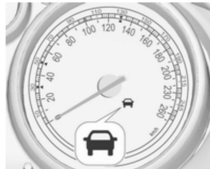
Зелений символ "автомобіль попереду" 🚗 засвічується на спідометрі, коли система розпізнала автомобіль на вашому шляху. Передумовою для цього є ввімкнення функції повідомлення про небезпеку зіткнення спереду у меню персоналізації автомобіля
