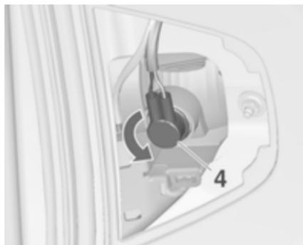
2. Поверніть тримач лампи проти годинникової стрілки та вийміть його з рефлектора.
