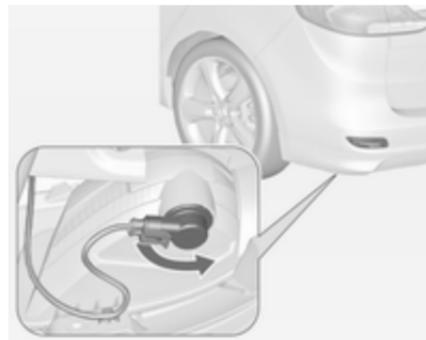
1. Поверніть патрон лампи проти годинникової стрілки та вийміть його з рефлектора.
