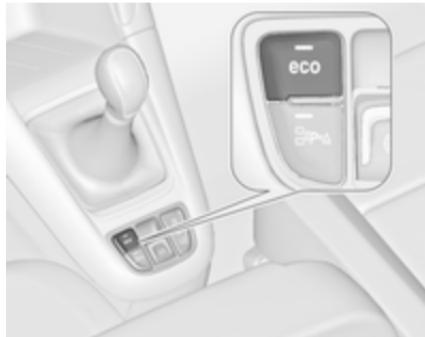
Вимкніть систему стоп-старт вручну, шляхом натискання на кнопку **eco**. На вимкнений стан вказує вимкнення індикатора в кнопці.
