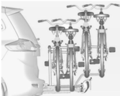
На задній системі кріплення багажу (система Flex-Fix) можна закріплювати два велосипеди на витяжному тримачі, закріплена на підлозі автомобіля. Можна закріплювати ще два велосипеди на адаптері. Перевезення інших речей заборонено.
