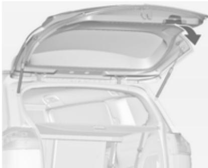
Користуйтесь внутрішньою ручкою. Не натискайте сенсорний перемикач під молдингом під час закриття дверей багажного відділення, оскільки внаслідок цього його буде знову розблоковано.
