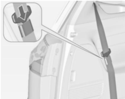
Перед роботою з кришкою багажного відділення, вставте пластину пластину пряжки паска безпеки з кожного боку в кишеню, закріплену на паску.
