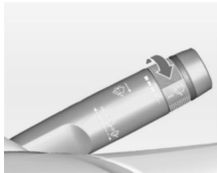
Поверніть колесо регулятора, щоб відрегулювати чутливість:
