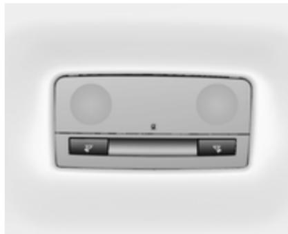
Вмикається разом із переднім підсвічуванням салону залежно від положення кулісного перемикача.
