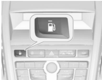
Натискання кнопки здійснює перехід між режимом роботи на бензині та режимом природного газу. Перемикання неможливе за високого навантаження (наприклад, при інтенсивному прискоренні, на повному газу). Світлодіодний індикатор позначає поточний режим роботи.
