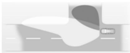
На поворотах з обмеженою видимістю чи під час виконання повороту, залежно від кута чи ввімкненого сигналу повороту, ліворуч або праворуч вмикається додатковий рефлектор, який освітлює дорогу в напрямку руху під відповідним кутом. Активується на швидкості 40 км/год.
