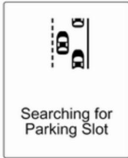
Поки автомобіль із активованою системою допомоги рухається вздовж ряду машин, розширенна система допомоги під час паркування здійснює пошук місця для парковки. При розпізнанні підходящого місця надаються візуальні та акустичні сигнали у центрі інформації водія.
