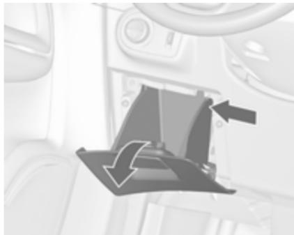
В автомобілях із лівостороннім керуванням коробка запобіжників знаходитьться за відділенням для зберігання в панелі приладів.
