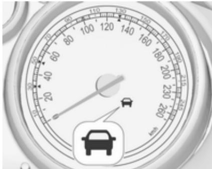
Про наявність автомобіля попереду сигналізує контрольний індикатор
