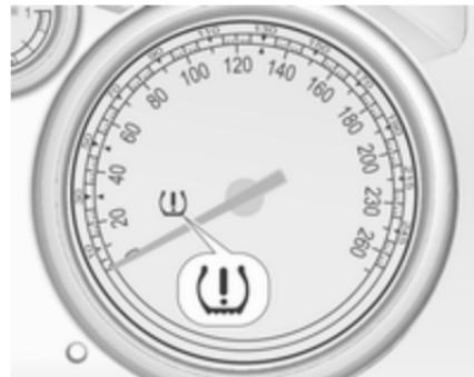
Розпізнавання стану тиску в шинах позначається контрольним індикатором  $\triangleright$  124.
