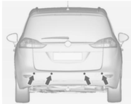
Передня і задня система допомоги під час паркування вимірює дистанцію між автомобілем і перешкодами попереду і позаду автомобіля. Система інформує водія у вигляді акустичних сигналів та повідомень на дисплеї.
