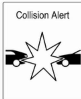
Якщо автомобіль, що рухається попереду, наближається занадто швидко, пролунає попереджувальний звуковий сигнал, і у центрі інформації водія з'являється повідомлення.
