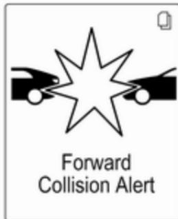
Якщо система виявить автомобіль попереду на смузі руху, на панелі приладів засвітиться зелений контрольний індикатор . Коли відстань до автомобіля попереду зменшується до небезпечної або наближення до іншого автомобіля відбувається занадто швидко і зіткнення є неминучим, в інформаційному центрі водія спливає символ попередження про зіткнення. Водночас, пролунає попереджувальний сигнал.
