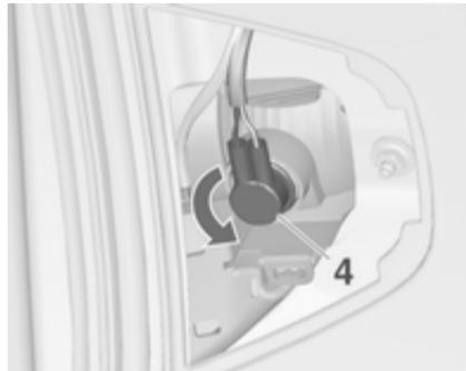
2. Поверніть тримач лампи проти годинникової стрілки та вийміть його з рефлектора.
