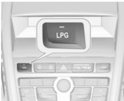
При натисканні кнопки **LPG**, робота автомобіля перемикається з бензину на скраплений газ одразу ж після досягнення необхідних параметрів (температура охолоджувальної рідини, температура газу та мінімальна частота обертів двигуна). Ці параметри зазвичай досягаються
