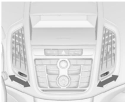
Щоб відчинити повітропровід, поверніть колесо регулятора в положення I. Відрегулюйте потік повітря, що надходить через повітропровід, повертуючи колесо регулятора в потрібне положення.
