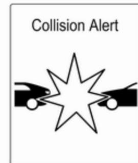
Якщо автомобіль, що рухається попереду, наближається занадто швидко, пролунає передужувальний звуковий сигнал, і у центрі інформації водія з'являється повідомлення.
