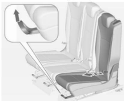
При використанні систем безпеки для дітей з кріпленнями ISOFIX на другому ряді сидінь, ми рекомендуємо відрегулювати відповідне зовнішнє крісло на третьому положенні фіксації від крайнього заднього положення (це стосується сидінь базової комплектації). Лаунж-сидіння, якщо воно встановлене, має бути у звичайному положенні  $\Phi$  48.
