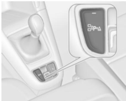
Передню та задню систему допомоги під час паркування обладнано кнопкою . Якщо автомобіль додатково обладнано вдосконаленою системою допомоги під час паркування, керування обома системами здійснюватиметься кнопкою .
