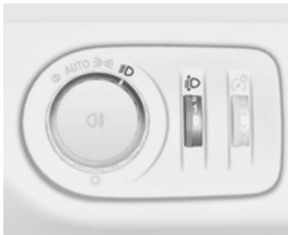
Щоб адаптувати діапазон освітлення фарами до навантаження автомобіля для запобігання засліпленню: поверніть колесо регулятора Ⓛ в потрібне положення.
