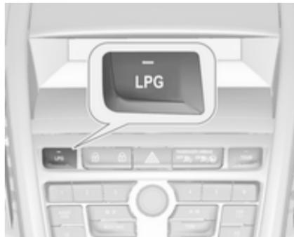
Натискайте кнопку **LPG** для переходу між режимом роботи на бензині та режимом скрапленого газу. Світлодіодний індикатор
