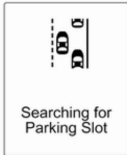
Поки автомобіль із активованою системою допомоги рухається вздовж ряду машин, вдосконалена система допомоги під час паркування здійснює пошук місця для паркування. При розпізнанні підходящого місця надаються візуальні та акустичні сигнали у центрі інформації водія.
