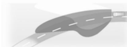
Пучок світла повертається відповідно до кута керма та швидкості, покращуючи освітлення на поворотах.
