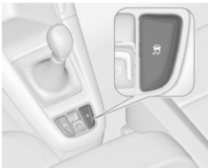
Для максимально розкучого водіння систему ESC можна дезактивувати: утримуйте кнопку
