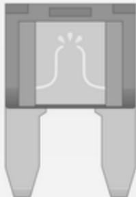
Залежно від типу запобіжника, запобіжник, що перегорів, можна розпізнати за розплавленим дротом. Не міняйте запобіжник, доки причина несправності не усунена.
