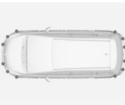
Розширенна система допомоги під час паркування відображує в центрі інформації водія інструкції та відтворює звукові сигнали, керуючись якими водій може припаркуватися в належному місці. Водій має керувати кермом, а також, прискоренням, гальмуванням, та перемиканням передач.
