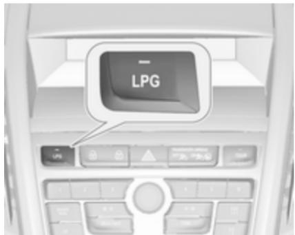
При натисканні кнопки **LPG**, робота автомобіля перемикається з бензину на скраплений газ одразу ж після досягнення необхідних параметрів (температура охолоджувальної рідини, температура газу та мінімальна частота обертів двигуна). Ці параметри зазвичай досягаються
