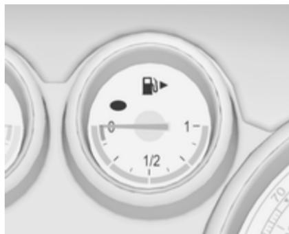
Цей датчик відображує інформацію про рівень палива або тиск газу в баку, залежно від робочого режиму.
