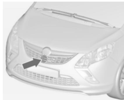
Датчик радара вмонтований позаду радіаторної решітки, нижче фіrmового логотипу.
