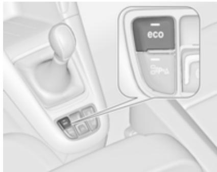
Вимкніть систему стоп-старт вручну, шляхом натискання на кнопку **eco**. На вимкненій стан вказує вимкнення індикатора в кнопці.
