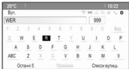
Щоб змінити розташування літер на клавіатурі, виберіть **ABC** ліворуч на клавіатурі. Літери зараз розташовуються в алфавітному порядку.
