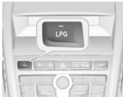
Щоб перемкнутися з бензину на скраплений газ і навпаки, натискайте **LPG**. Світлодіодний індикатор  $\blacksquare$  позначає поточний режим роботи.
