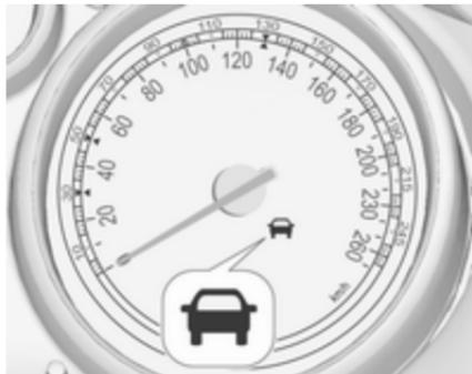
Коли система виявляє транспортний засіб на смузі руху, на спідометрі засвічується зелений контрольний індикатор - "автомобіль попереду".
