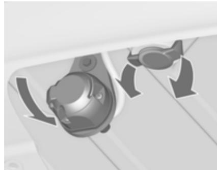
Відключіть та складіть розетку. Вийміть ущільнювальну пробку з отвору для штанги та приберіть її.
