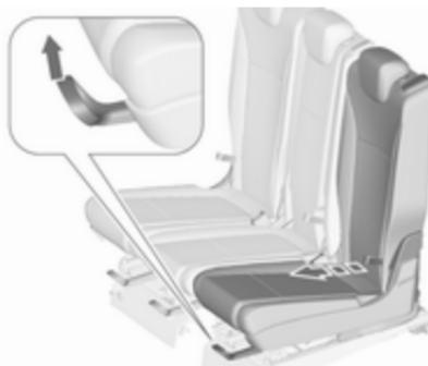
При використанні систем безпеки для дітей з кріпленнями ISOFIX на другому ряді сидінь, ми рекомендуємо відрегулювати відповідне зовнішнє крісло на третьому положенні фіксації від крайнього заднього положення (це стосується сидінь базової комплектації). Лаунж-сидіння, якщо воно встановлене, має бути у звичайному положенні  $\Phi$  48.
