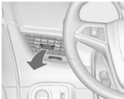
Щоб зачинити повітропровід, поверніть колесо регулятора в положення **0**.
