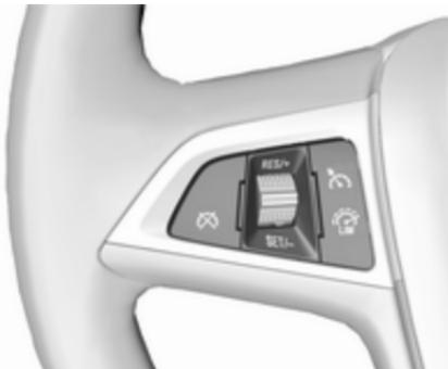
Натисніть . Якщо перед цим було ввімкнено круїз-контроль та адаптивний круїз-контроль, вони вимкнуться після ввімкнення обмежувача швидкості, після чого контрольний індикатор згасне.
