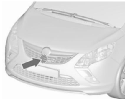
Датчик радара вмонтований позаду радіаторної решітки, нижче фіrmового логотипу.
