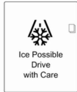
Якщо зовнішня температура падає до 3 °C, у центрі інформації для водія з комбінованим дисплеєм вищого рівня відображається попередження.
