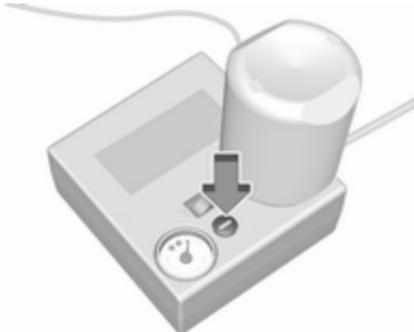
Якщо протягом десяти хвилин вказаного рівня тиску не досягнуто, зніміть набір для ремонту шин. Пересуньте автомобіль на один оберт шини. Повторно приєднайте набір для ремонту шин і продовжуйте процедуру заповнення протягом десяти хвилин. Якщо вказаний тиск у шинах все ще не вдається отримати, це свідчить про серйозне пошкодження шини. Зверніться по допомогу на станцію технічного обслуговування.
