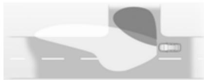
На поворотах з обмеженою видимістю чи під час виконання повороту, залежно від кута чи ввімкненого сигналу повороту, ліворуч або праворуч вмикається додатковий рефлектор, який освітлює дорогу в напрямку руху під відповідним кутом. Активується на швидкості 40 км/год.
