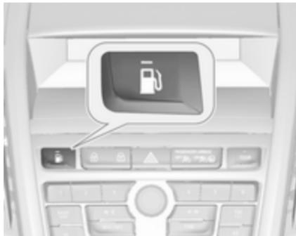
Кнопка призначена для перемикання з бензину на природний газ і навпаки. Перемикання неможливе за високого навантаження (наприклад, під час інтенсивного прискорення, на повному газу). Світлодіодний індикатор позначає поточний режим роботи.
