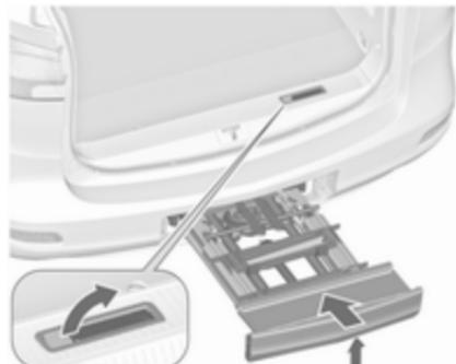
Штовхніть важіль розблокування вгору та утримуйте його в такому положенні. Злегка підніміть систему та посуньте її в бампер до фіксації.
