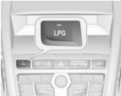
Після натиснення кнопки **LPG** автомобіль перемкнеться з бензину на скраплений газ одразу ж після досягнення необхідних параметрів (температура охолоджувальної рідини, температура газу та мінімальна частота обертів двигуна). Ці параметри зазвичай досягаються приблизно через 60 секунд після першого активного натискання на педаль акселератора (залежно від температури повітря). Світлодіодний індикатор стану вказує на поточний режим роботи.
