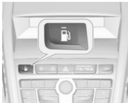
Щоб перемкнутися з бензину на природний газ і навпаки, натискайте . Світлодіодний індикатор позначає поточний режим роботи.
