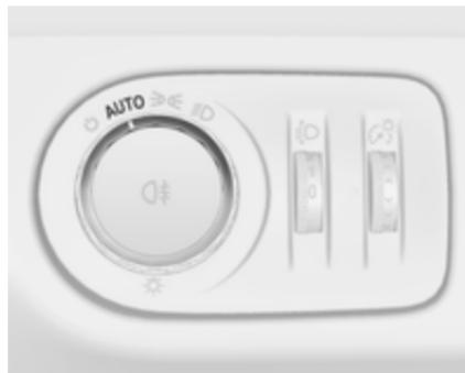
Коли функцію автоматичного керування освітленням увімкнено, а двигун працює, система автоматично змінює режим освітлення при денному свіtlі та режим увімкнення фар, залежно від умов освітлення та даних системи датчиків дощу.
