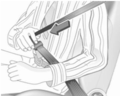
Витягніть пасок із переднаташувача, протягніть його через тіло та вставте язичок защілки в пряжку. Регулярно посилюйте щільність поясного паска безпеки під час водіння, натягуючи плечовий пасок.
