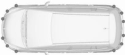
Розширенна система допомоги під час паркування показує вказівки в інформаційному центрі водія та подає звукові сигнали, керуючись якими водій може припаркувати автомобіль у належному місці. Водій має керувати кермом, а також контролювати прискорення й гальмування та перемикання передач.
