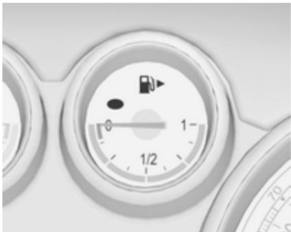
Цей датчик відображує інформацію про рівень пального або тиск газу в баку, залежно від робочого режиму.
