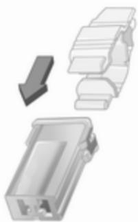
Установіть знімач запобіжника на різні типи запобіжників зверху чи збоку та витягніть запобіжник.
