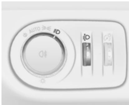
Щоб адаптувати діапазон освітлення фарами до навантаження автомобіля для запобігання засліпленню: поверніть колесо регулятора  $\diamond$  в потрібне положення.
