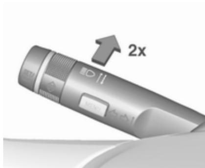
Система керування дальнім світлом вмикається при подвійному натисканні важеля індикатора на швидкості вище 40 км/год.
