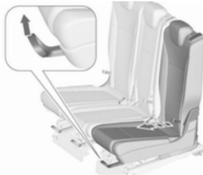
При використанні систем безпеки для дітей з кріпленнями ISOFIX на другому ряді сидінь, ми рекомендуємо відрегулювати відповідне зовнішнє крісло на третьому положенні фіксації від крайнього заднього положення (це стосується сидінь базової комплектації). Лаунж-сидіння, якщо воно встановлене, має бути у звичайному положенні ⇨ 48.
