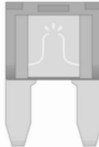
Залежно від типу запобіжника, запобіжник, що перегорів, можна розпізнати за розплавленим дротом. Не міняйте запобіжник, доки причина несправності не усунена.
