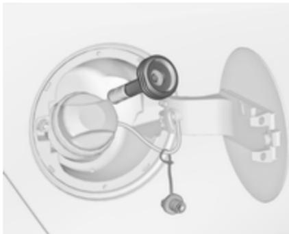
**Адаптер ACME:** Закрутіть гайку заправної насадки на адаптер. Натисніть на фіксувальний важіль на насадці вниз.
