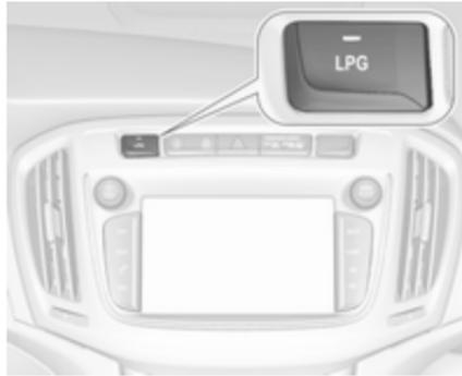
Після натиснення кнопки **LPG** автомобіль перемкнеться з бензину на скраплений газ одразу ж після досягнення необхідних параметрів (температура охолоджувальної рідини, температура газу та мінімальна частота обертів двигуна). Ці параметри зазвичай досягаються приблизно через 60 секунд після
