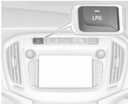
Щоб перемкнутися з бензину на скраплений газ і навпаки, натискайте **LPG**. Світлодіодний індикатор ● позначає поточний режим роботи.
