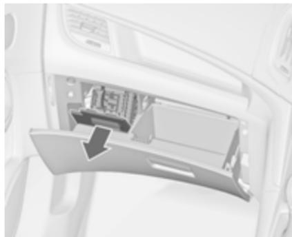
В автомобілях для правостороннього руху коробка запобіжників розташована за кришкою бардачок. Відкрийте бардачок, після цього відкрийте кришку та складіть її.
