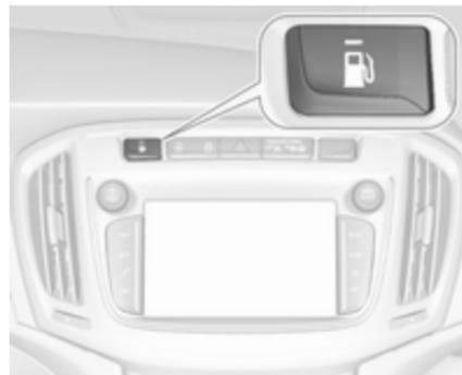
Щоб перемкнутися з бензину на природний газ і навпаки, натискайте індикатор. Світлодіодний індикатор — позначає поточний режим роботи.
