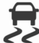
Протибуксувальна гальмівна система (ТС) переводиться в робочий стан після кожного запуску двигуна, як тільки згасне індикатор
