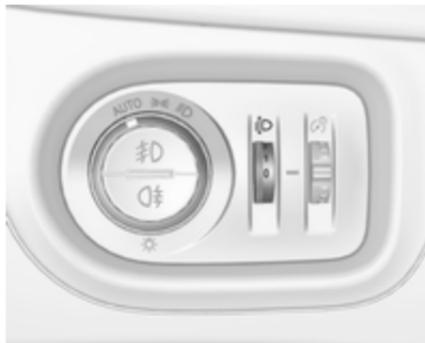
Щоб адаптувати діапазон освітлення фарами до навантаження автомобіля для запобігання засліпленню: поверніть колесо регулятора  $\text{D}$  в потрібне положення.
