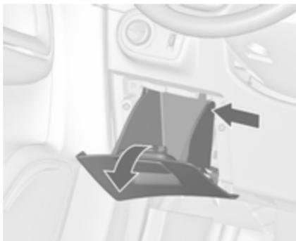
В автомобілях із лівостороннім керуванням коробка запобіжників знаходиться за відділенням для зберігання в панелі приладів.
