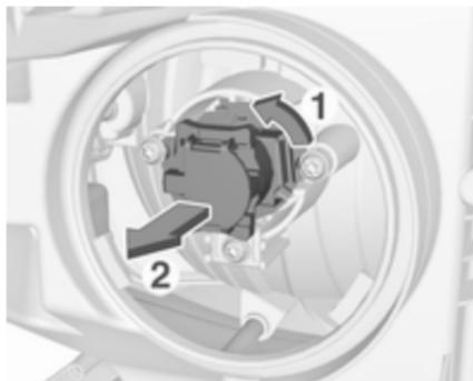
2. Повертайте тримач лампи проти годинникової стрілки, щоб відкрутити його. Вийміть патрон лампи з корпусу рефлектора.
