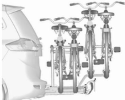
Задня система кріплення багажу (система Flex-Fix) дозволяє закріпити два велосипеди на витяжному тримачі, об'єднаному з підлогою автомобіля. Можна закріплювати ще два велосипеди на адаптері. Перевезення інших речей заборонено.
