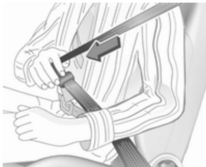
Витягніть пасок із переднатягувача, протягніть його через тіло та вставте язичок заціпки в пряжку. Регулярно посилюйте щільність поясного паска безпеки під час водіння, натягуючи плечовий пасок.
