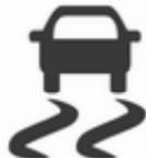
Електронна система курсової стійкості (ESC) переводиться в робочий стан після кожного запуску двигуна, як тільки згасне індикатор
