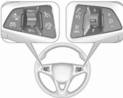
Інформаційно-розважальною системою, деякими допоміжними системами водія і підключенням мобільним телефоном можна керувати за допомогою засобів на кермі.
