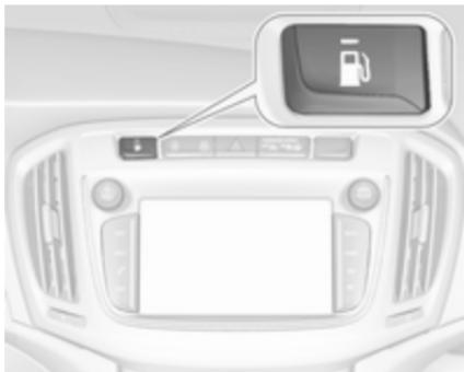
Кнопка призначена для перемикання з бензину на природний газ і навпаки. Перемикання неможливе за високого навантаження (наприклад, під час інтенсивного
