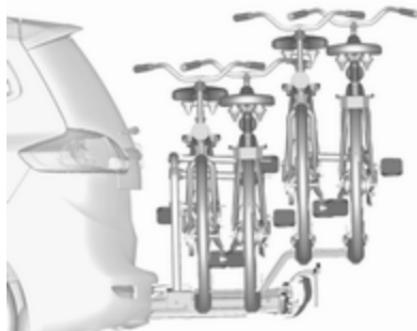
Задня система кріплення багажу (система Flex-Fix) дозволяє закріпiti два велосипеди на витяжному тримачі, об'єднаному з підлогою автомобіля. Можна закріплювати ще два велосипеди на адаптері. Перевезення інших речей заборонено.
