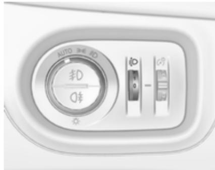
Щоб адаптувати діапазон освітлення фарами до навантаження автомобіля для запобігання засліпленню: поверніть колесо регулятора
