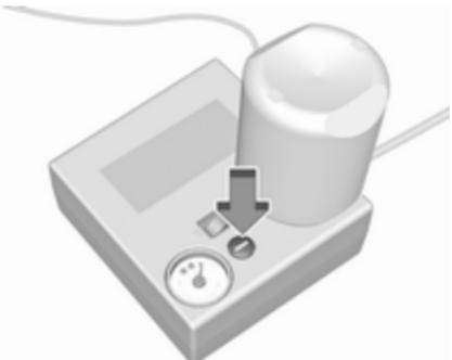
Якщо протягом десяти хвилин вказаний рівень тиску не досягнуто, зніміть набір для ремонту шин. Пересуньте автомобіль на один оберт шини. Повторно приєднайте набір для ремонту шин і продовжуйте процедуру заповнення протягом десяти хвилин. Якщо вказаний тиск у шинах все ще не вдається отримати, це свідчить про серйозне пошкодження шини. Зверніться по допомогу на станцію технічного обслуговування.
