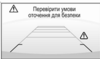
Завдяки високому розташуванню камери, задній бампер також видно на дисплей, що допомагає скерувати автомобіль в потрібне місце.
