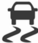
Протибуксувальна гальмівна система (TC) переводиться в робочий стан після кожного запуску двигуна, як тільки згасне індикатор
