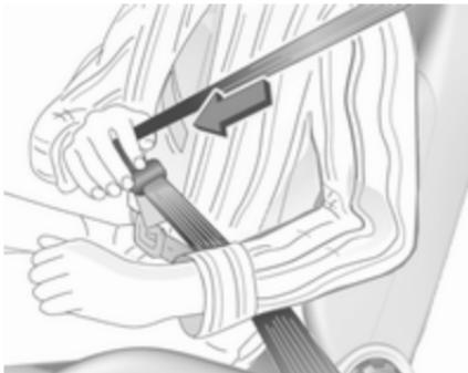
Витягніть пасок із переднаташувача, протягніть його через тіло та вставте язичок защілки в пряжку. Регулярно посилюйте щільність поясного паска безпеки під час водіння, натягуючи плечовий пасок.
