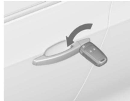
Розблокуйте вручну водійські дверцята за допомогою ключа. Увімкніть запалювання й натисніть , щоб розблокувати всі дверцята, багажне відділення та кришку горловини паливного баку. При ввімкненні запалювання система запобігання викраденню автомобіля дезактивується.
