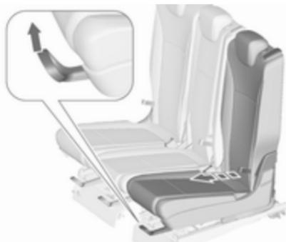
При використанні дитячих автокрісел з кріпленнями ISOFIX на другому ряді сидінь, ми рекомендуємо відрегулювати відповідне зовнішнє крісло на третьому положенні фіксації від крайнього заднього положення (це стосується сидінь базової комплектації). Лаунж-сидіння, якщо воно встановлене, має бути у звичайному положенні  $\diamond$  48.
