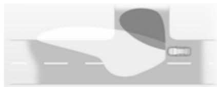
На поворотах з обмеженою видимістю чи під час звертання з дороги, залежно від кута керма чи сигналу індикатора, ліворуч або праворуч вмикается додатковий рефлектор, який освітлює дорогу в напрямку руху. Активується на швидкості 70 км/год.
