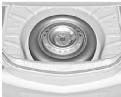
備用車輪位於行李廂內的地板蓋下面。它是用一個帶翼的螺栓固定。
