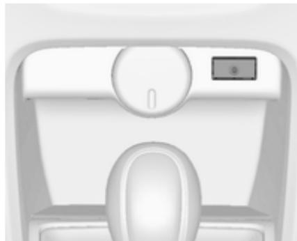
在中央控制台上有個 AUX 插槽，供連接外部音源之用。
