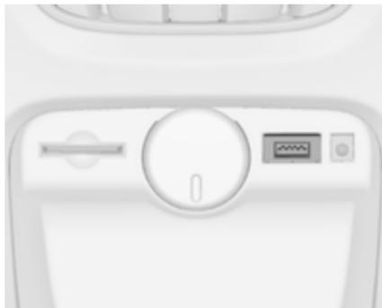
在中央控制台上有個 USB 插槽，供連接外部音訊資料來源之用。
